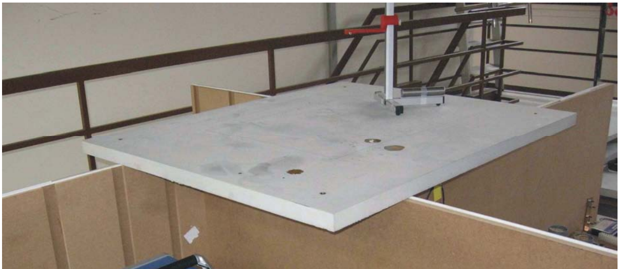
Bild 36 Realisierter Trittschall-Modellprüfstand aus [He09] in der Variante Skelettbau (Rohdecke größer als die Empfangsraum-Grundfläche)
