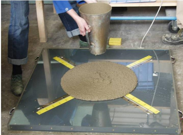
Abb. 2- 3: optoelektronischer Ausbreittisch mit Setzfließkegel
