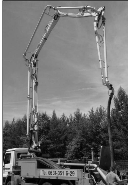
**Abb. 2- 20:** Autobetonpumpe M28-4 von Putzmeister während des dritten Pumpversuchs
