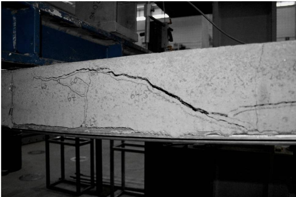
**Abb. 4- 25:** Typisches Rissbild für Cofrastra40,  $t = 0,75\text{mm}$
