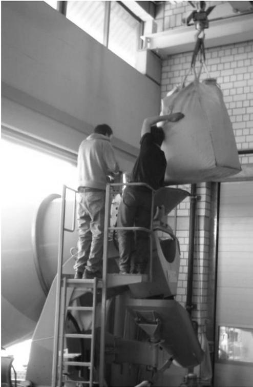
**Abb. 2- 19:** Beladen des Fahrmischers mit lagerfeuchtem Leichtzuschlag
