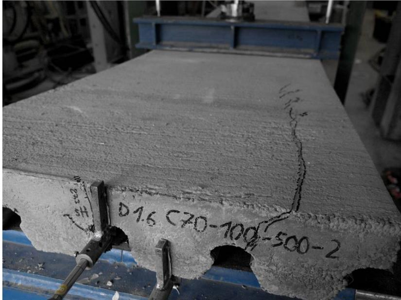
Abb. 4- 34: Längsrisse über den Sicken eines C70-Profils
