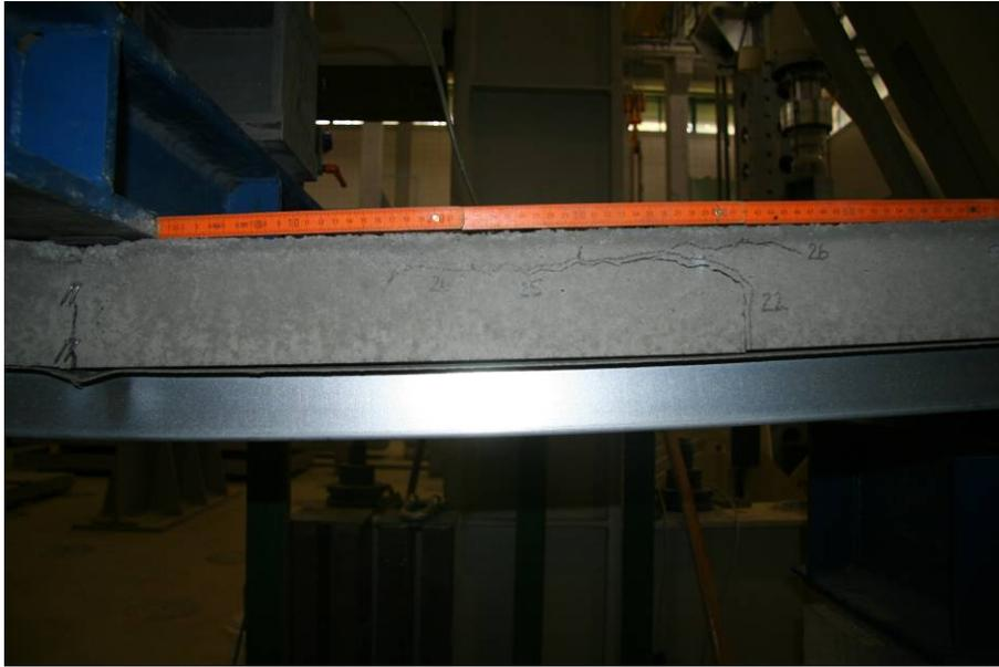
**Abb. 4- 79:** Versuchskörper D1.4-HR-100-420 1b bei Erreichen der Traglast
