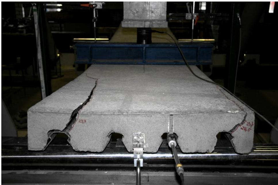
**Abb. 4- 33:** Typisches Längsschubversagen eines C70-Profils in Verbindung mit Leichtbeton
