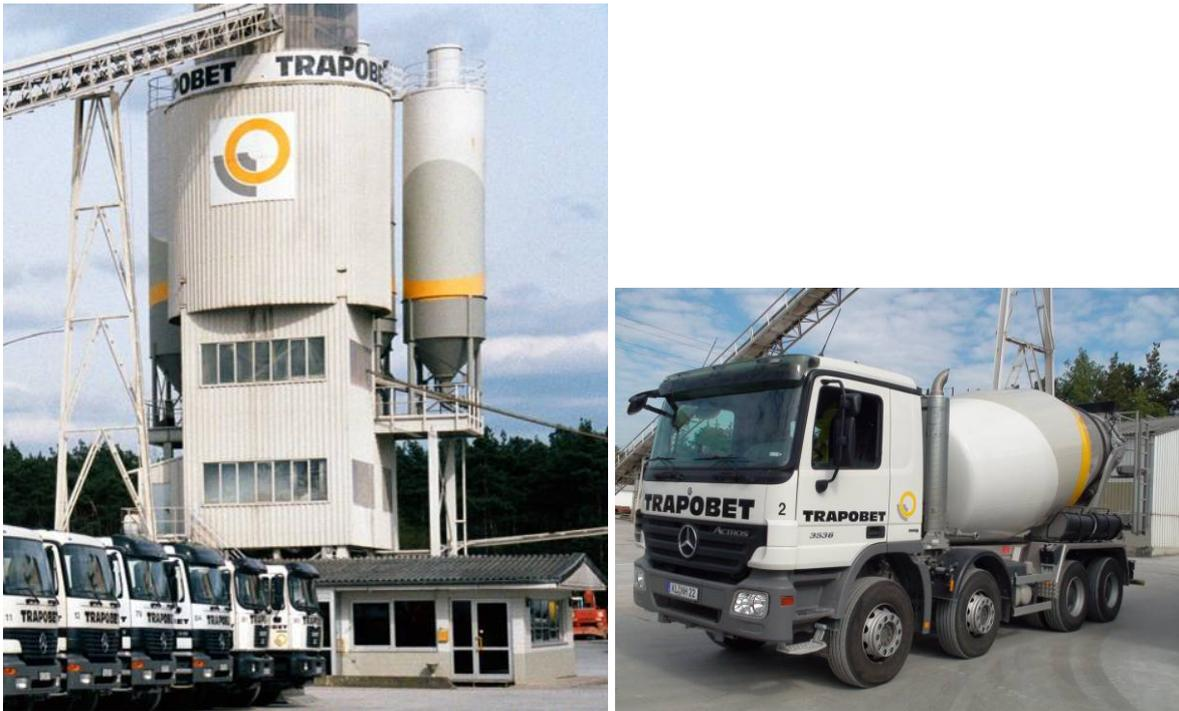
**Abb. 2- 18:** Transportbetonmischanlage der Firma TRAPOBET und Fahrmischer.
