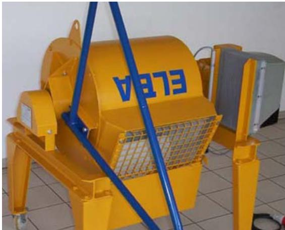
**Abb. 2- 1:** Laborzwangsmischer EMS 60 C in Entleerstellung mit abgenommenem Staubschutzdeckel
