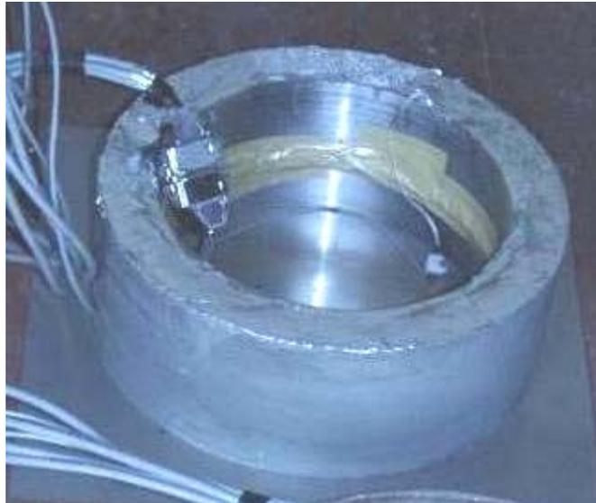
**Abb. 2- 15:** Versuchsaufbau beim Ringversuch; ein mit DMS instrumentierter Stahlring (innen) wird durch aufschwindenden Beton deformiert.
