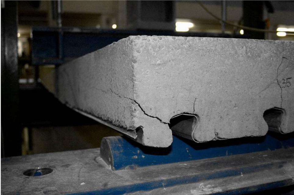
Abb. 4- 26: Längsschneide über den Sicken eines C40-Profils
