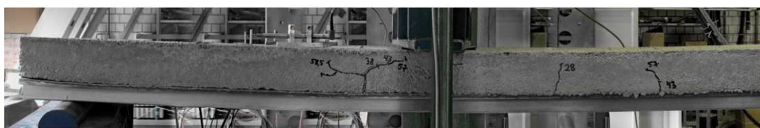
**Abb. 4- 21:** Typisches Rissbild für Super-Holorib51,  $t = 1,00\text{mm}$
