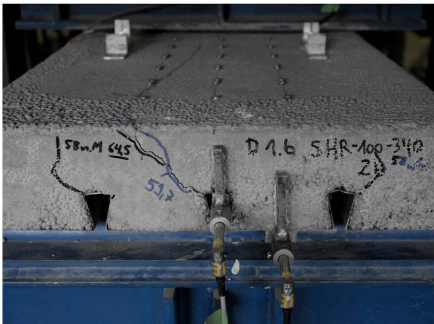
Abb. 4- 23: Längsrisse über den Sicken eines SHR-Profiles, Blechdicke  $t = 1,00\text{mm}$
