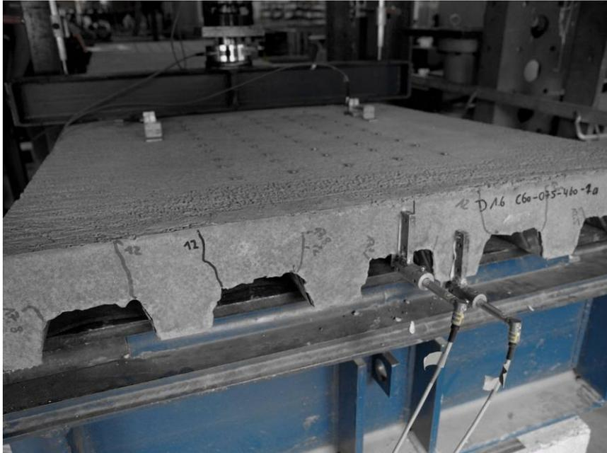
Abb. 4- 29: Längsriss über den Sicken eines C60-Profils
