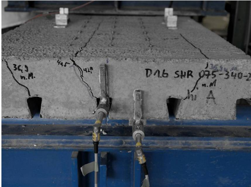
Abb. 4- 22: Längsrisse über den Sicken eines SHR-Profiles, Blechdicke  $t = 0,75\text{mm}$
