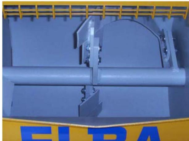
**Abb. 2- 2:** Innenansicht des Laborzwangsmischer EMS 60 C mit auswechselbarem Mischwerkzeug
