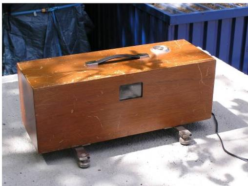
**Abb. 5- 5:** Norm-Hammerwerk auf einem Versuchskörper
