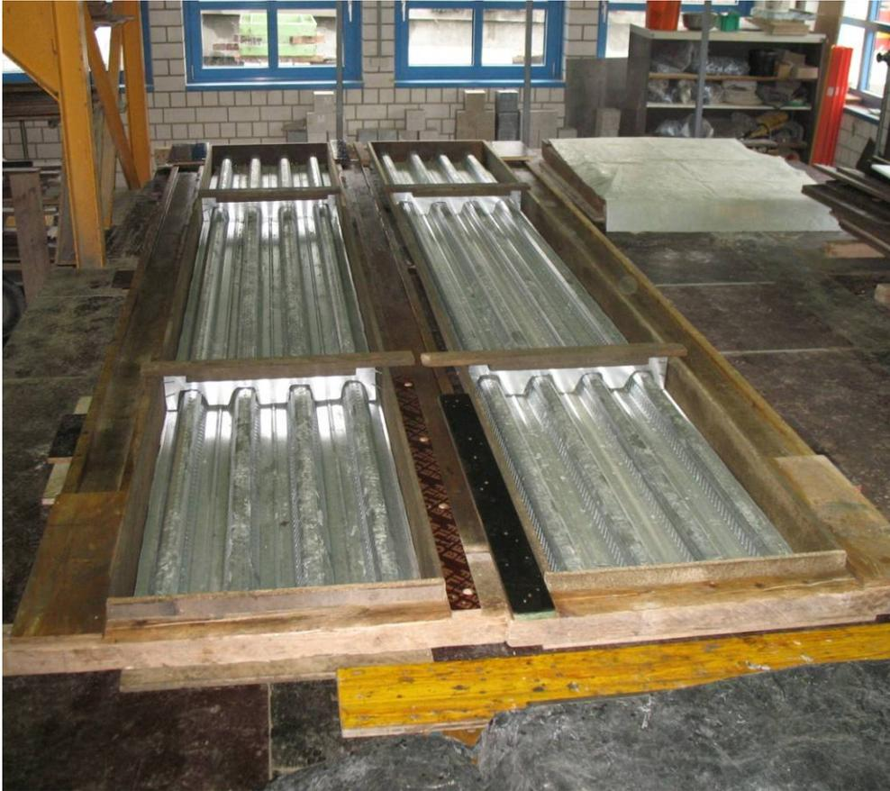
Abb. 4- 5: Eingeschalter Probekörper kurz vor Betonage
