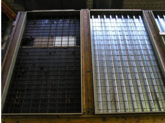
**Abb. 5- 4:** Herstellung der Deckenkörper für die Schallmessungen
