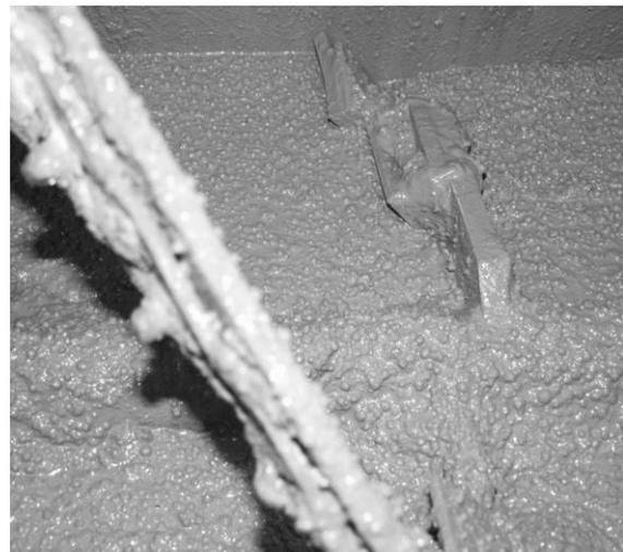
**Abb. 2- 6:** Langsames Scheren des Leichtbetons beim Nachmischen
