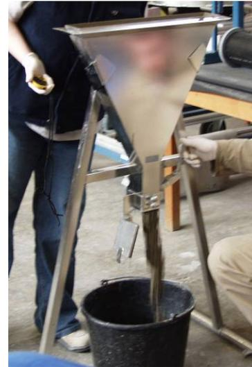
Abb. 2- 4: Trichter zur Bestimmung der Auslaufzeit
