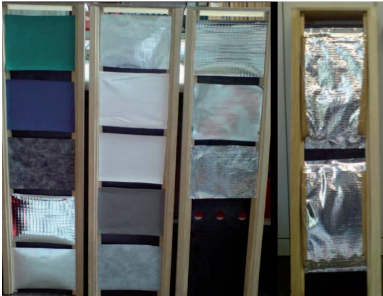
Abbildung 6 Geschützt eingebaute Proben für den Freilandversuch
