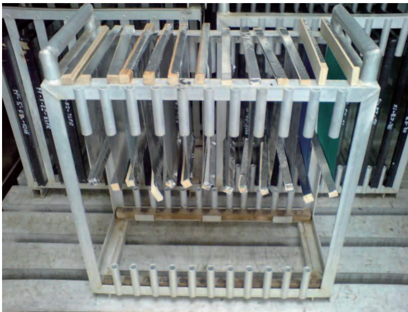
Abbildung 4 Eingebaute Probekörper im Wechselklimaschrank
