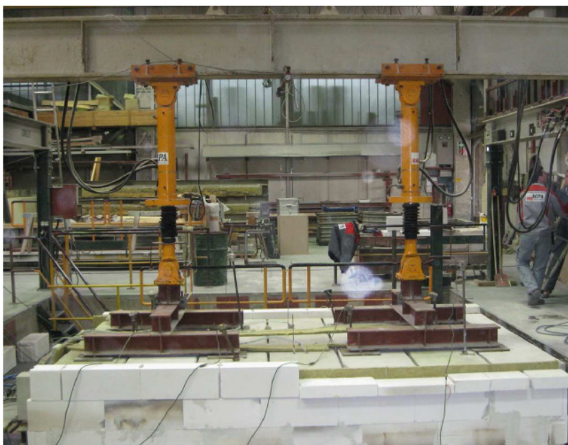
Bild 53: Belastungseinrichtung oberhalb der Brandkammer
