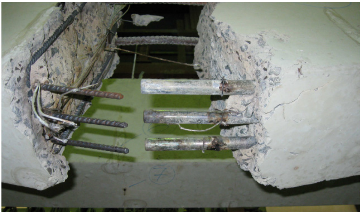
Bild 54a: Bruch in Balkenmitte (F90) {bei (F60) etwa vergleichbares Bild}
