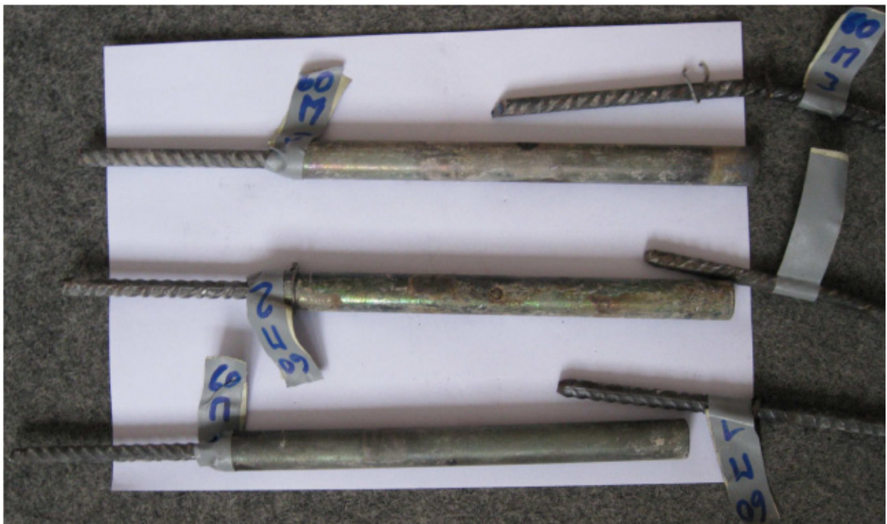
Bild 56: Versagte Klebestöße aus dem Beton ausgebaut (F60)
