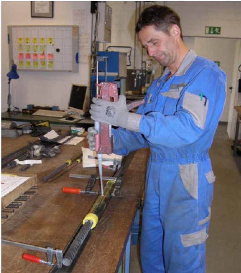
Bild 35: Mörtelinjektion mit einer Handpresse
