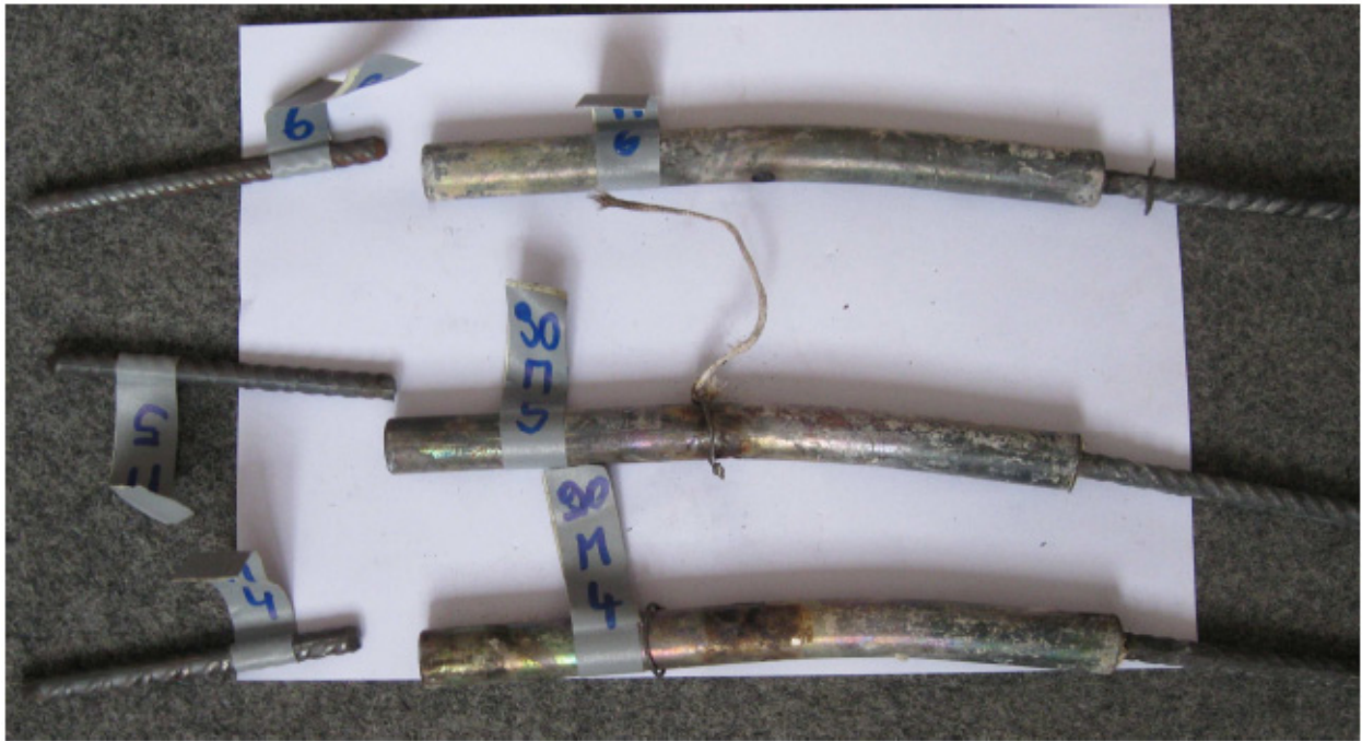
Bild 54b: Versagte Klebestöße aus dem Beton ausgebaut (F90)
