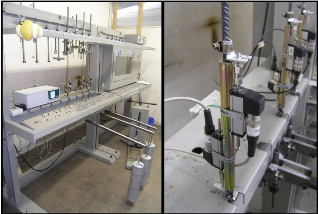
Bild 46: Kriechstände bis 20 kN (ohne und mit Temperierschrank); Detail zur Schlupfmessung
