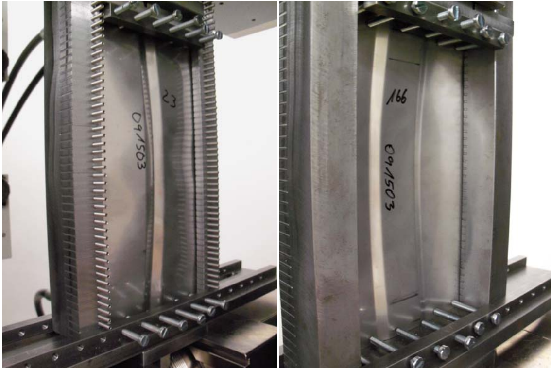
Abbildung 4: Versagen durch Knicken
