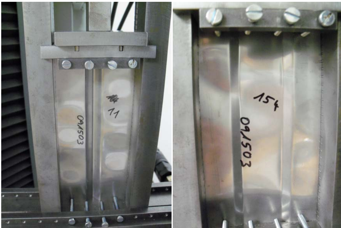
Abbildung 3: Versagen durch örtliches Beulen
