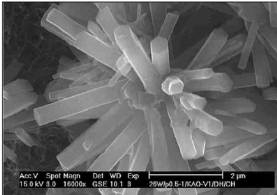
Bild 12: ESEM-Aufnahme von Ettringit [6]
