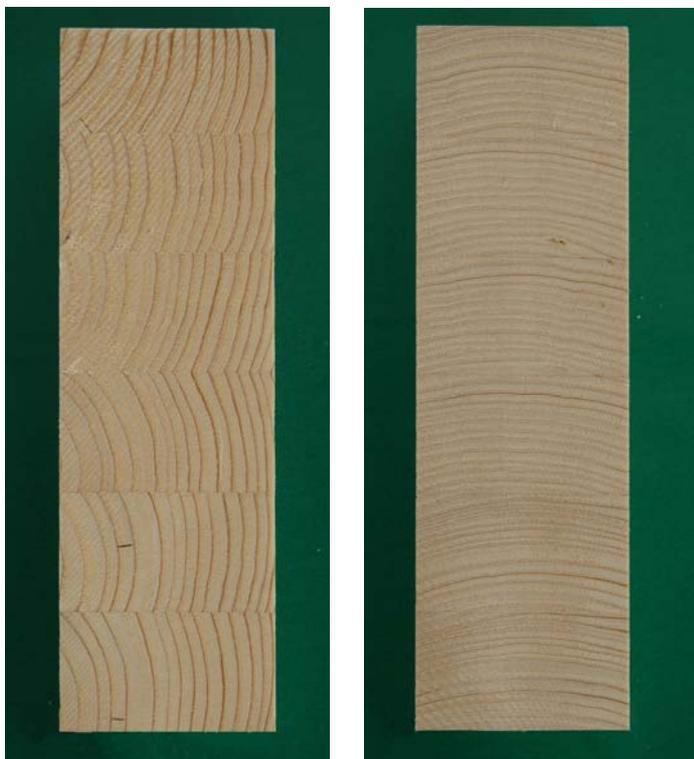
Bild 4-26 Prüfkörpervarianten A und C für Einschraubversuche
