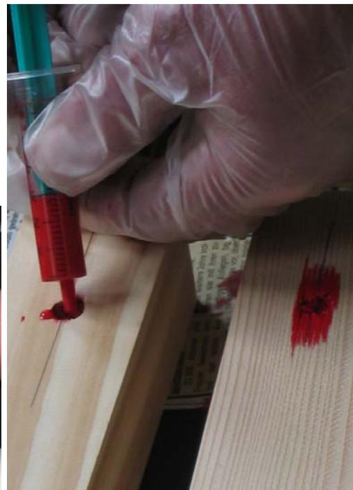
Bild 5-21 Abdichten der Prüfkörper und Einbringen der Farbe
