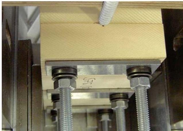
Bild 4-5 Lagerung des Prüfkörpers
