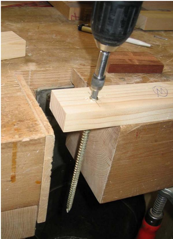
Bild 4-2 Versenken des Kopfes, nach einer Wartezeit wird die Schraube wieder herausgedreht
