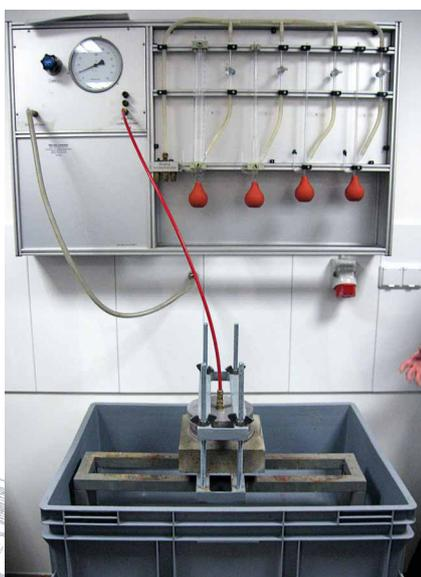
Abb. 4: Ansicht der Prüfeinrichtung der MFPA Leipzig GmbH zur rückseitigen (Druck-)Wasserbeanspruchung eines Innenabdichtungssystems mit regelbarem Wasserdruck
