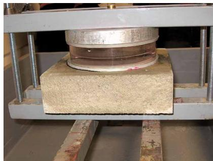
Abb. 5: Detailansicht der Prüfeinrichtung und eines Prüfkörpers der MFPA Leipzig GmbH zur rückseitigen (Druck-)Wasserbeanspruchung eines Innenabdichtungssystems
