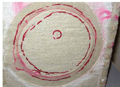
Abb. 6: Ansicht einer Innenabdichtungssystemfläche auf einem Prüfkörper an der MFPA Leipzig GmbH nach einer rückseitigen (Druck-)Wasserbeanspruchung
