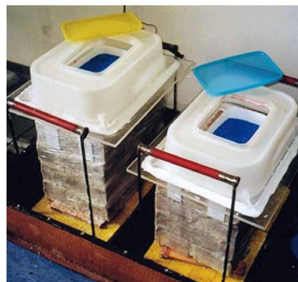
Abb. 2: Probekörper zur Wirksamkeitsprüfung eines Injektionsstoffes
