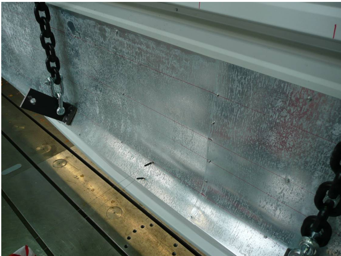
Abbildung A.143: Gurtverdrehung
