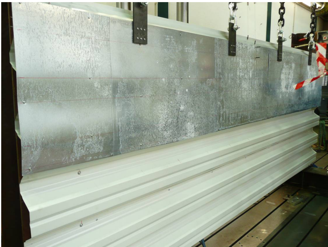
Abbildung A.39: Verformung des Flachblechs
