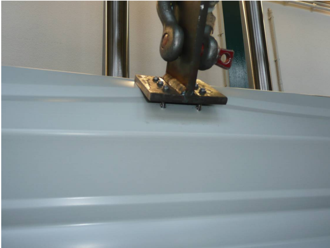
Abbildung A.157: Versagen durch Herausziehen der Schrauben an der Lasteinleitung
