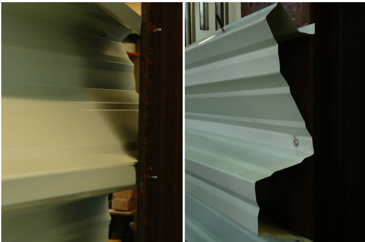
Abbildung A.87: Profilverformung
