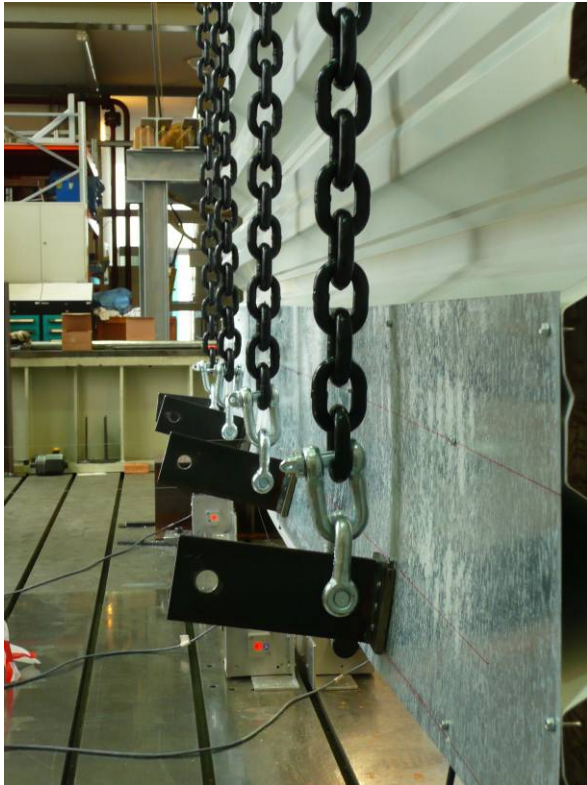
Abbildung A.96: Lasteinleitung und Flachblechtafeln
