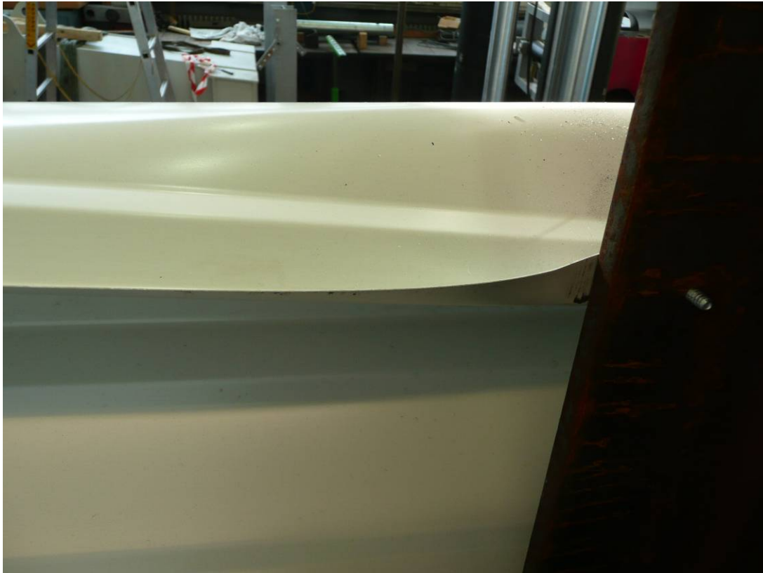
Abbildung A.75: Stegkrüppeln am Auflager
