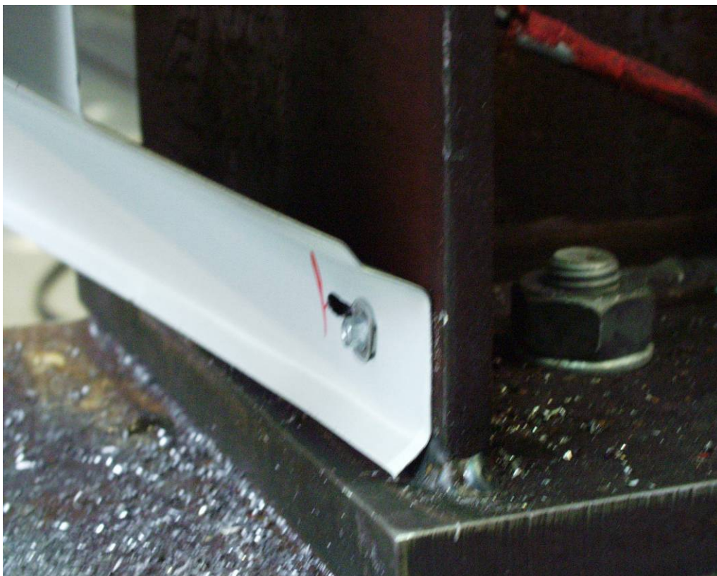
Abbildung A.112: Langlochbildung in Profillängsrichtung
