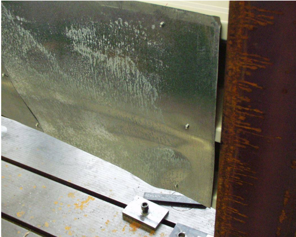
Abbildung A.168: Verformung der Flachblechtafeln am Auflager
