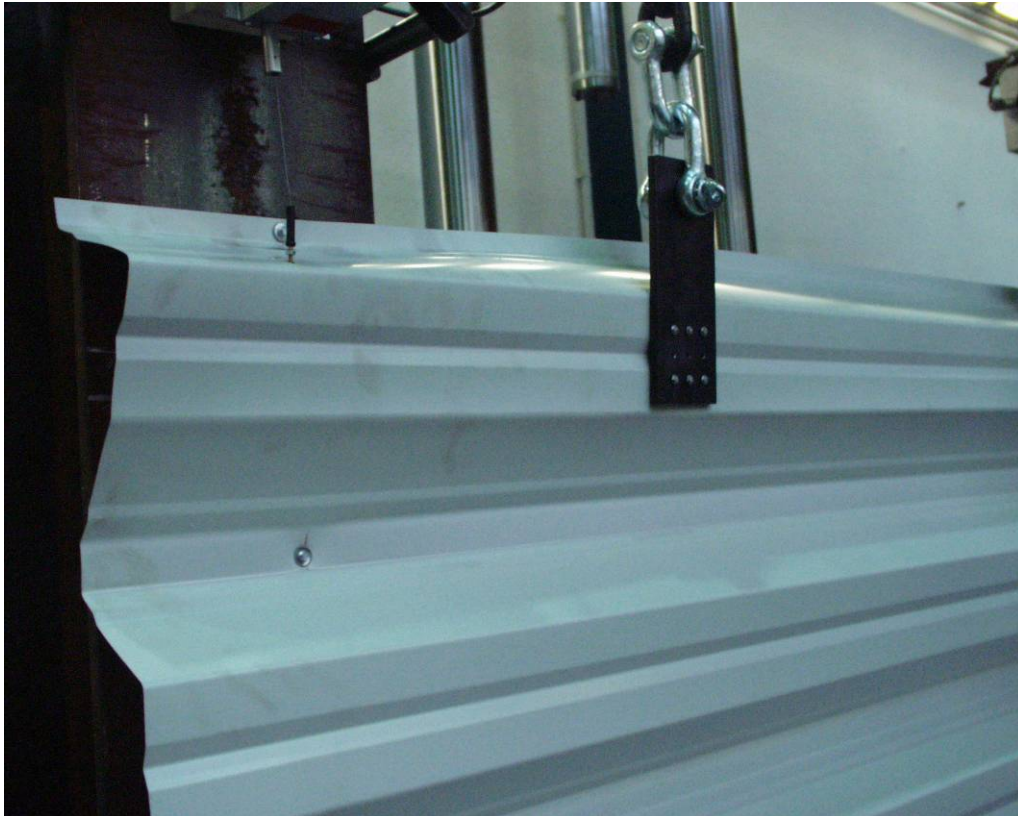
Abbildung A.20: Örtliche Profilverformung
