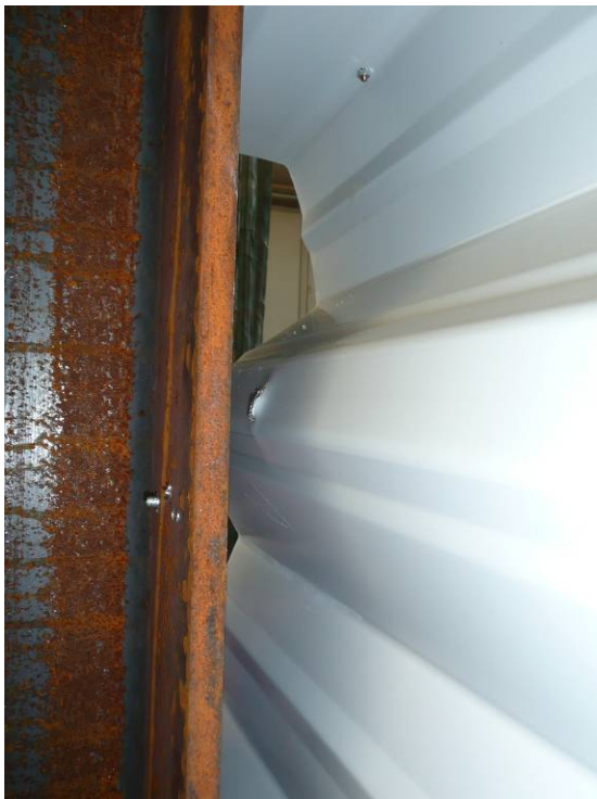
Abbildung A.61: Versagen der Verbindung
