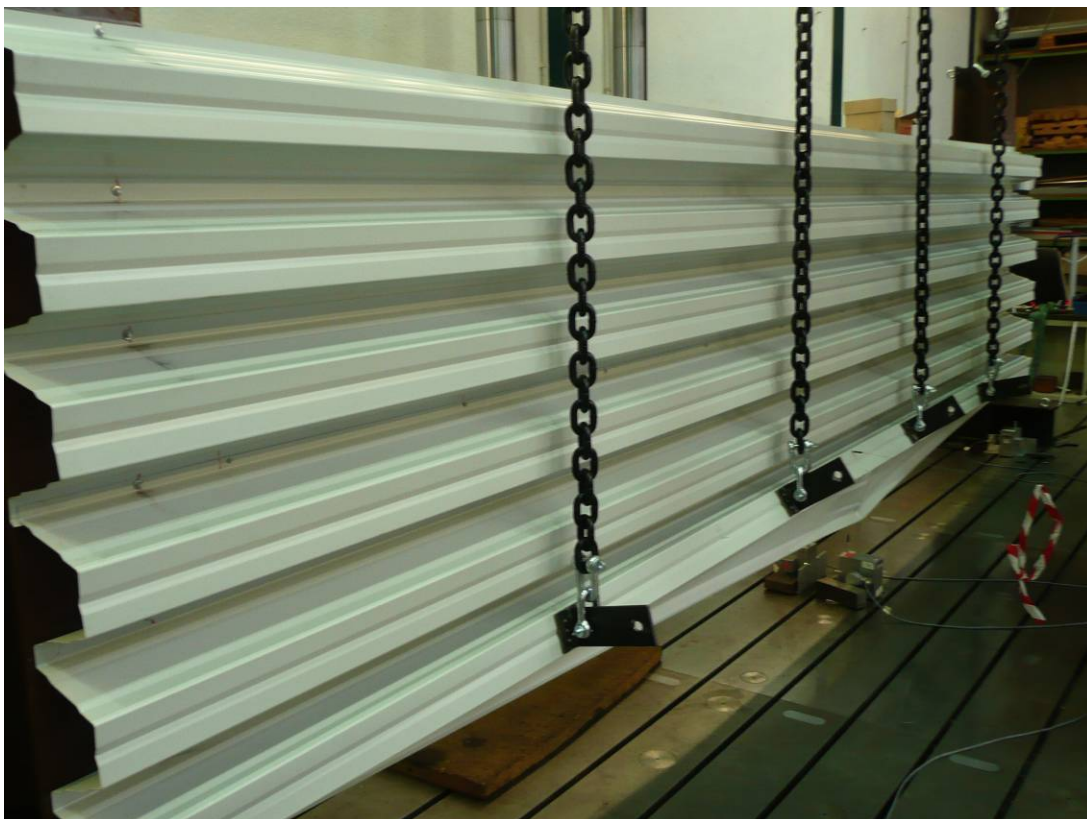
Abbildung A.132: Gurtverdrehung
