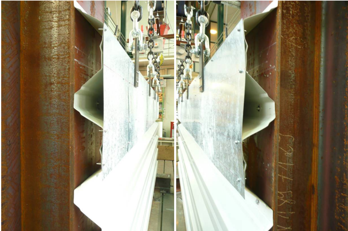
Abbildung A.29: Flachblech am unbelasteten und belasteten Versuchsaufbau
