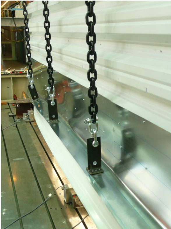
Abbildung A.124: Abgeknickter Gurt
