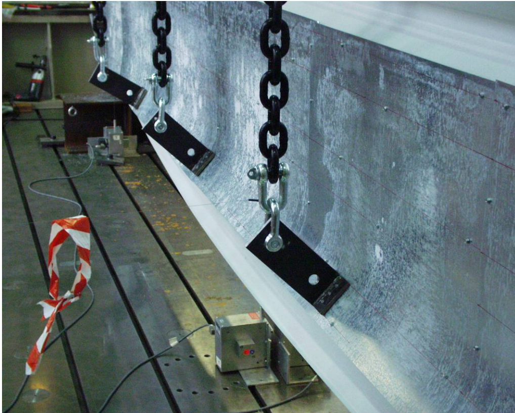
Abbildung A.109: Gurtverformung
