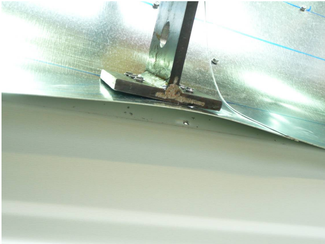
Abbildung A.122: Versagen durch Herausziehen der Schrauben an der Lasteinleitung
