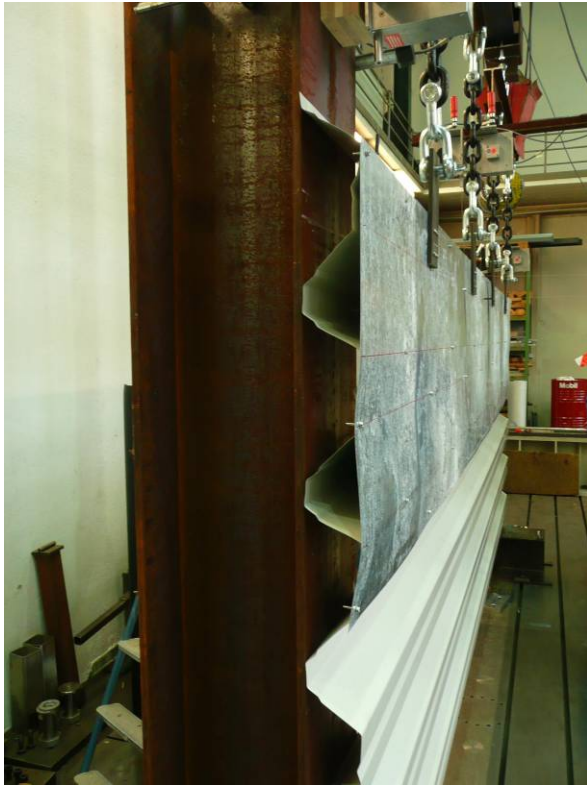
Abbildung A.40: Verformung des Querschnitts einschließlich Flachblech
