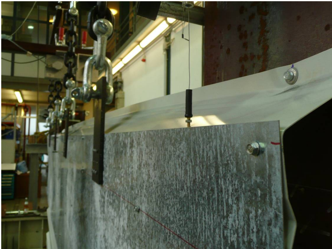
Abbildung A.41: Verformung des freien Längsrandes mit Teileinspannung durch die Dichtscheibe
