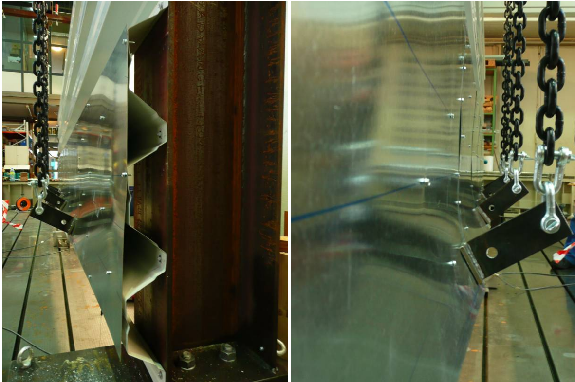
Abbildung A.120: Gurtverdrehung
