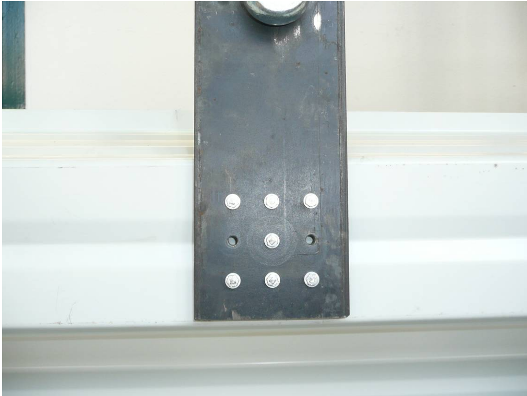
Abbildung A.69: Lasteinleitung
