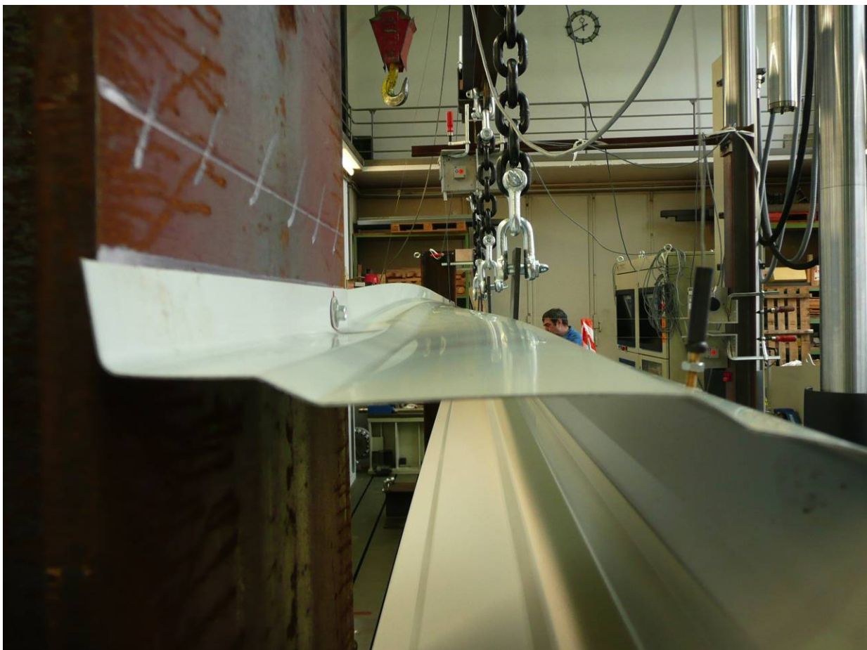
Abbildung A.85: Steglängswölbung
