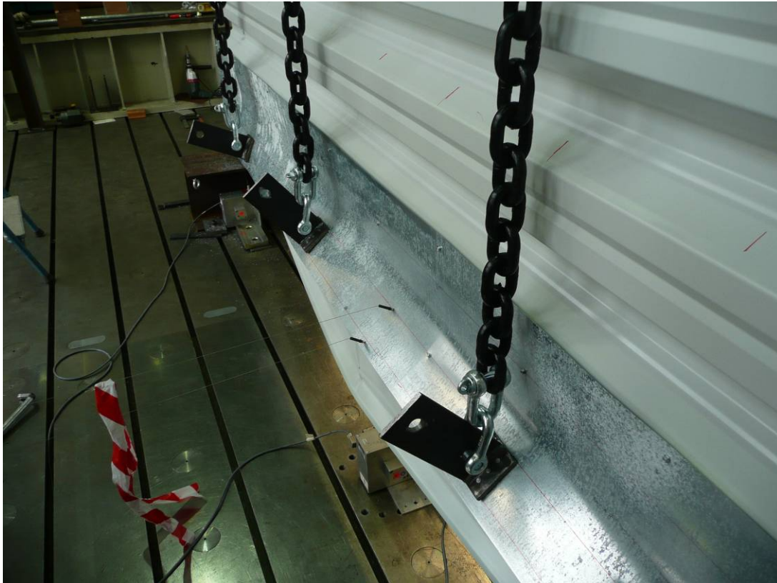
Abbildung A.98: Gurtverdrehung
