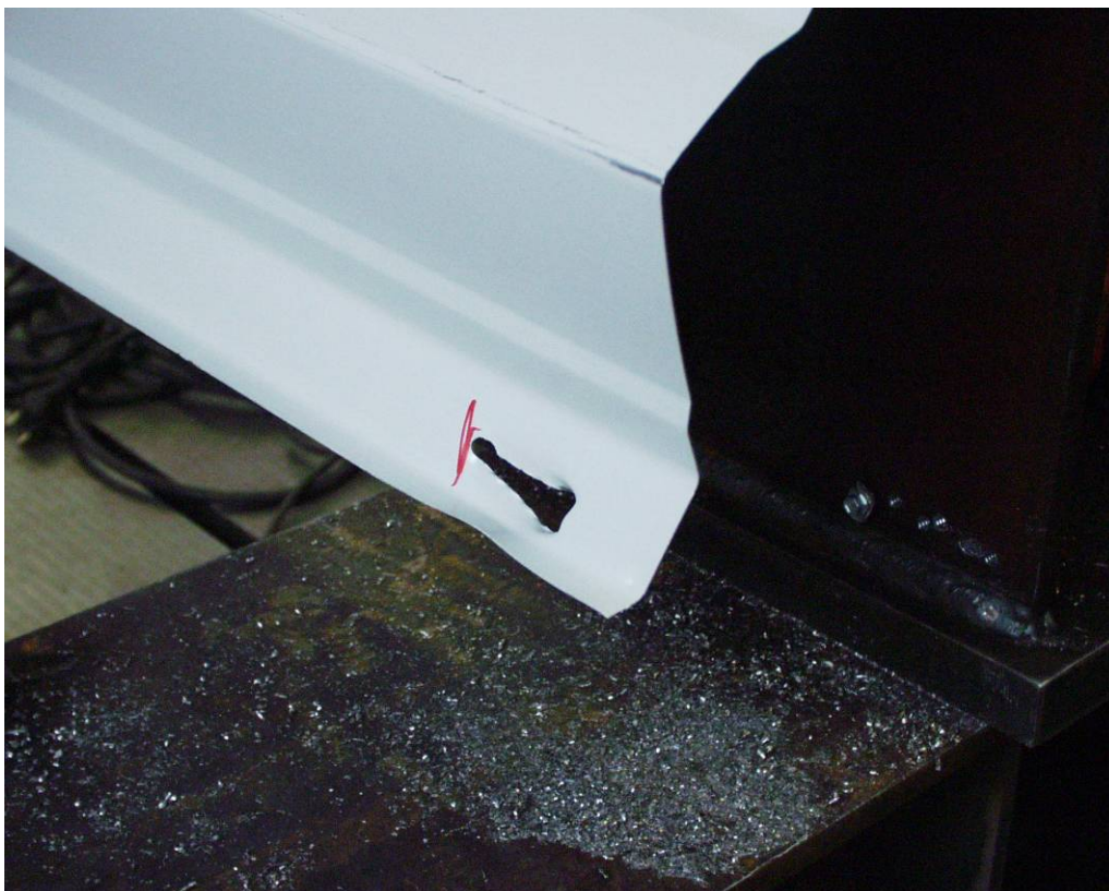
Abbildung A.169: Versagen durch Langlochbildung
