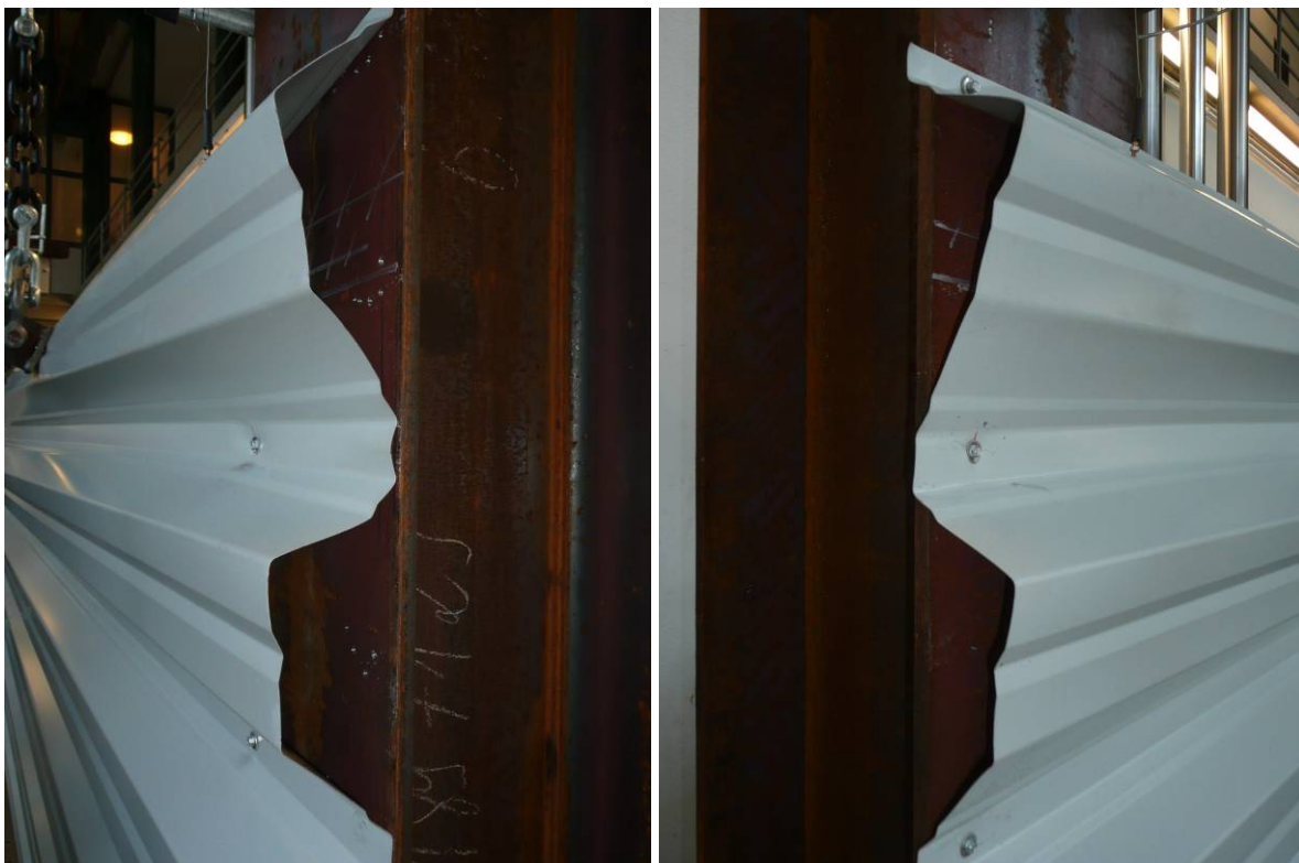
Abbildung A.156: Profilverformung
