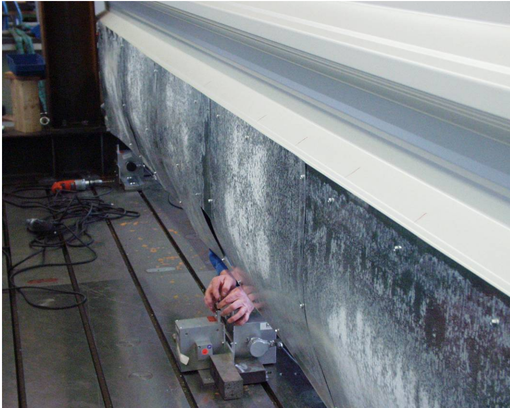
Abbildung A.166: Verformung der Flachblechtafeln
