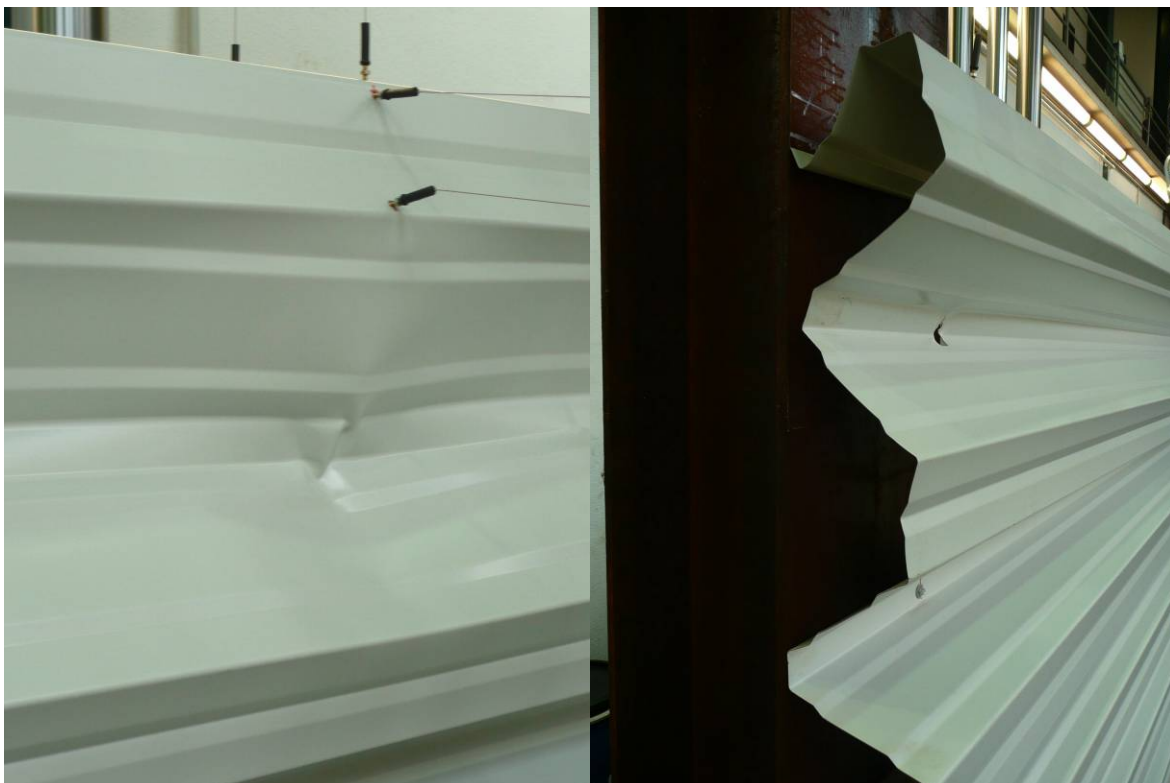
Abbildung A.89: Beule in Feldmitte und Versagen am Auflager
