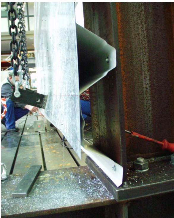
Abbildung A.108: Vergleich der Gurtverformung im Feld und am Auflager
