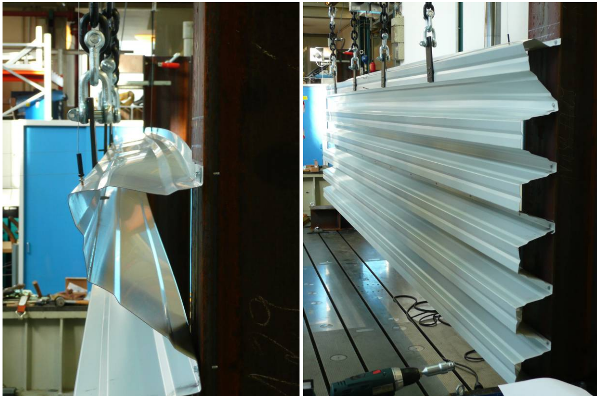
Abbildung A.73: Profilverformung
