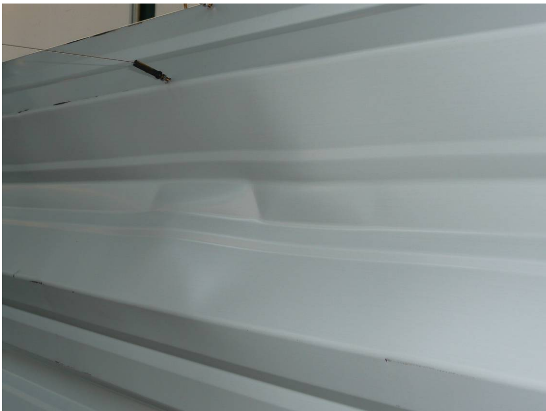
Abbildung A.154: Beule im schmalen Gurt
