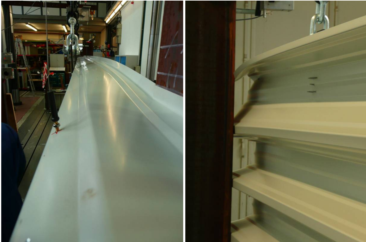
Abbildung A.86: Profilverformung
