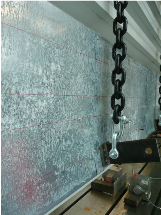
Abbildung A.142: Gurtverdrehung
