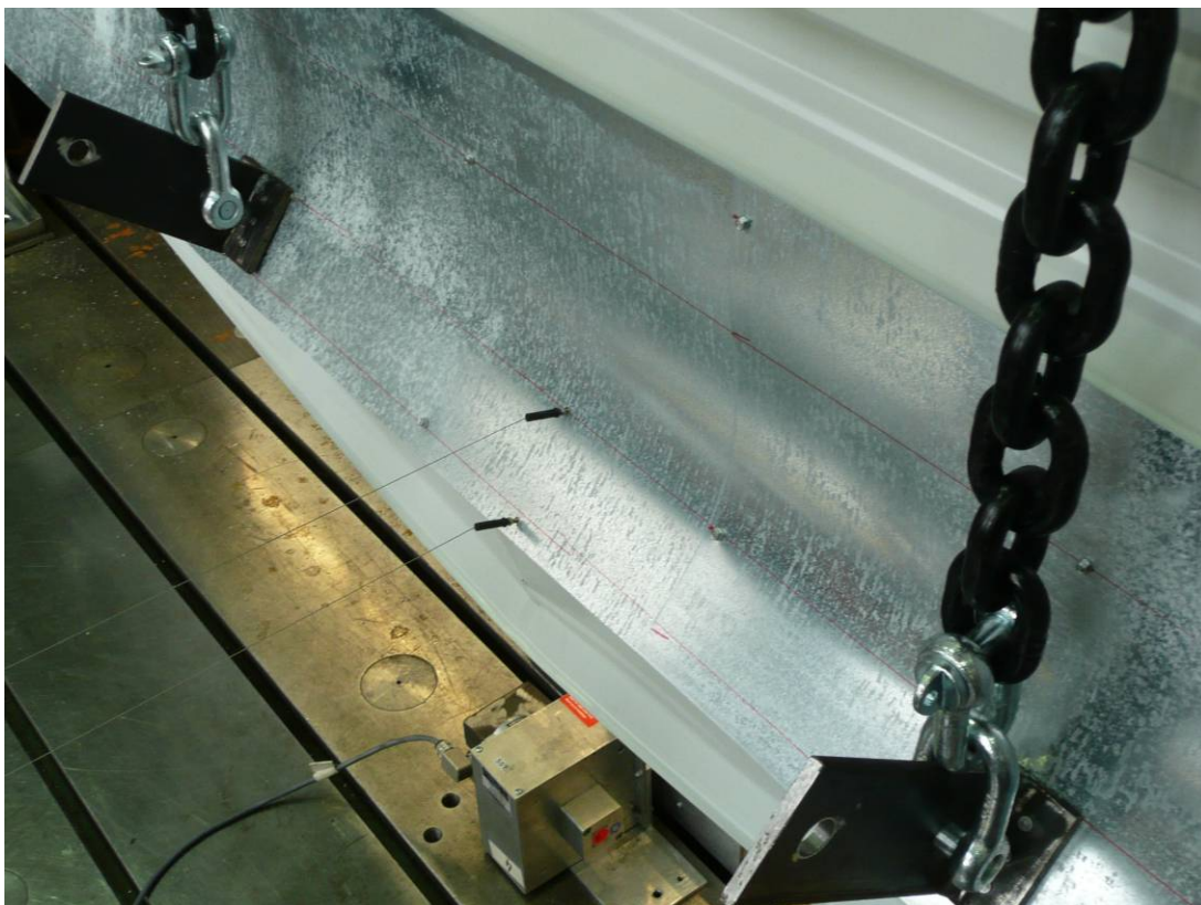
Abbildung A.99: Gurtverdrehung in Feldmitte
