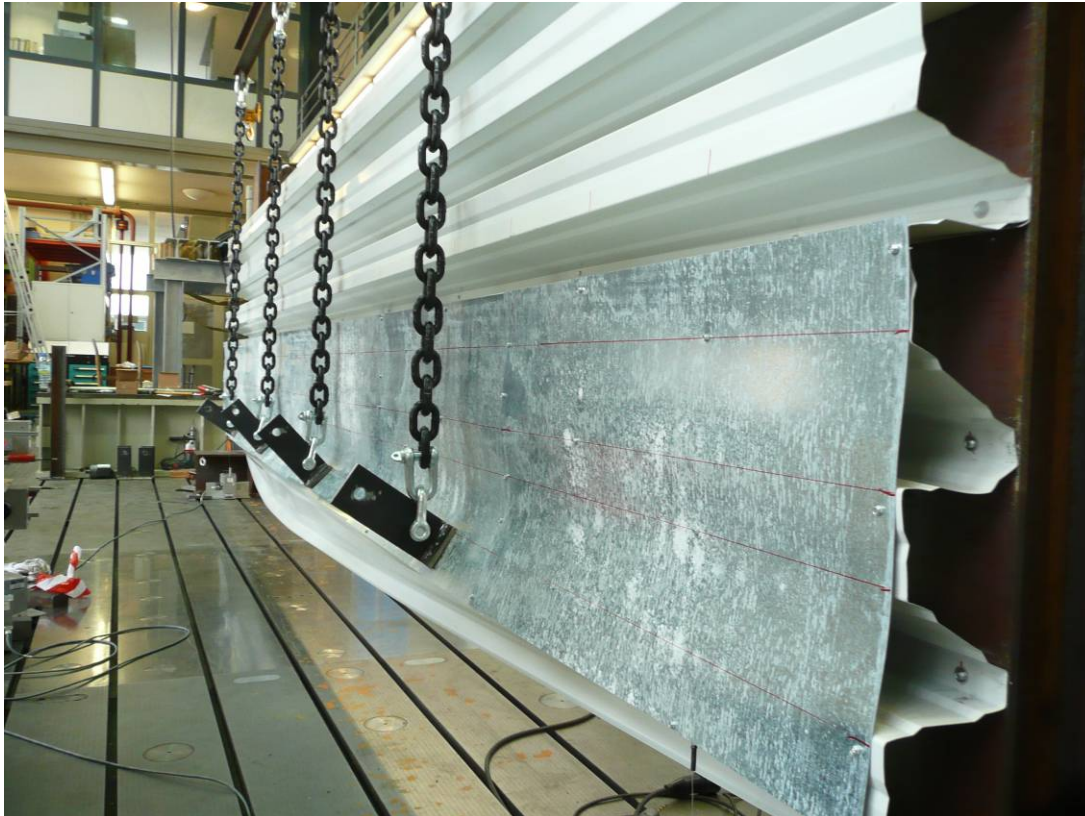
Abbildung A.144: Gurtverdrehung
