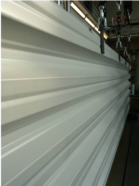
Abbildung A.60: Profilverformung in Feldmitte
