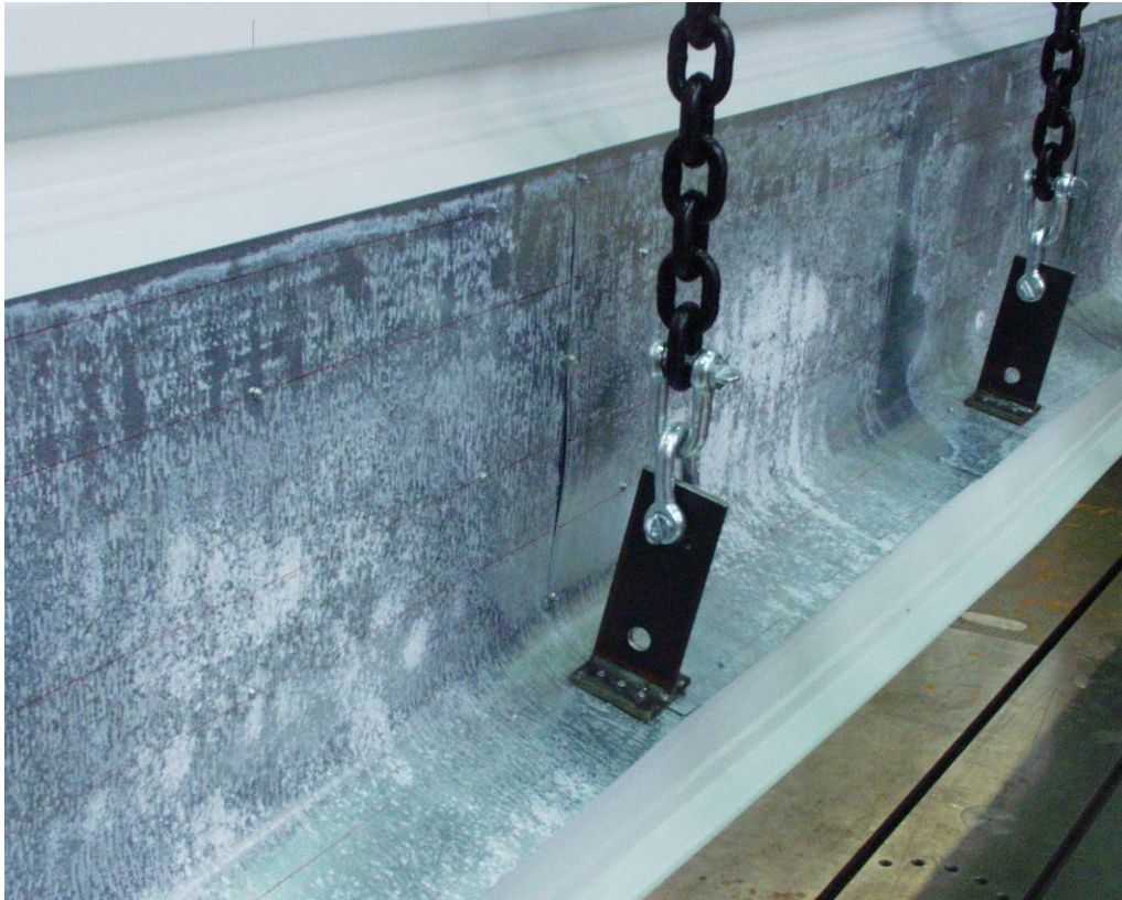
Abbildung A.111: Abgeknickter belasteter Gurt
