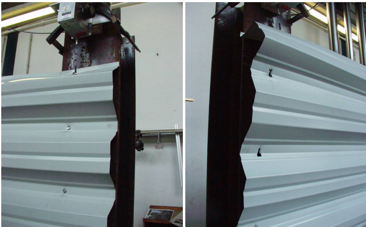
Abbildung A.52: Profilverformung am Auflager nach dem Versagen der ersten Verbindung
