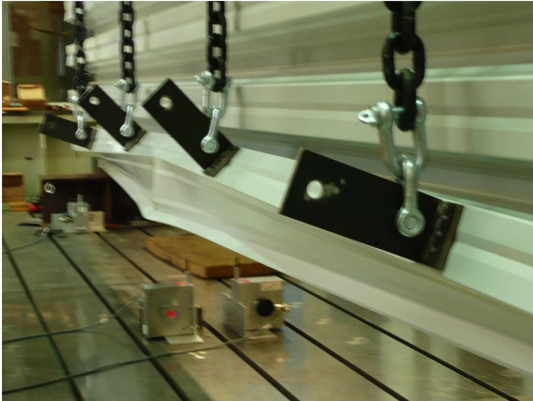
Abbildung A.133: Gurtverdrehung
