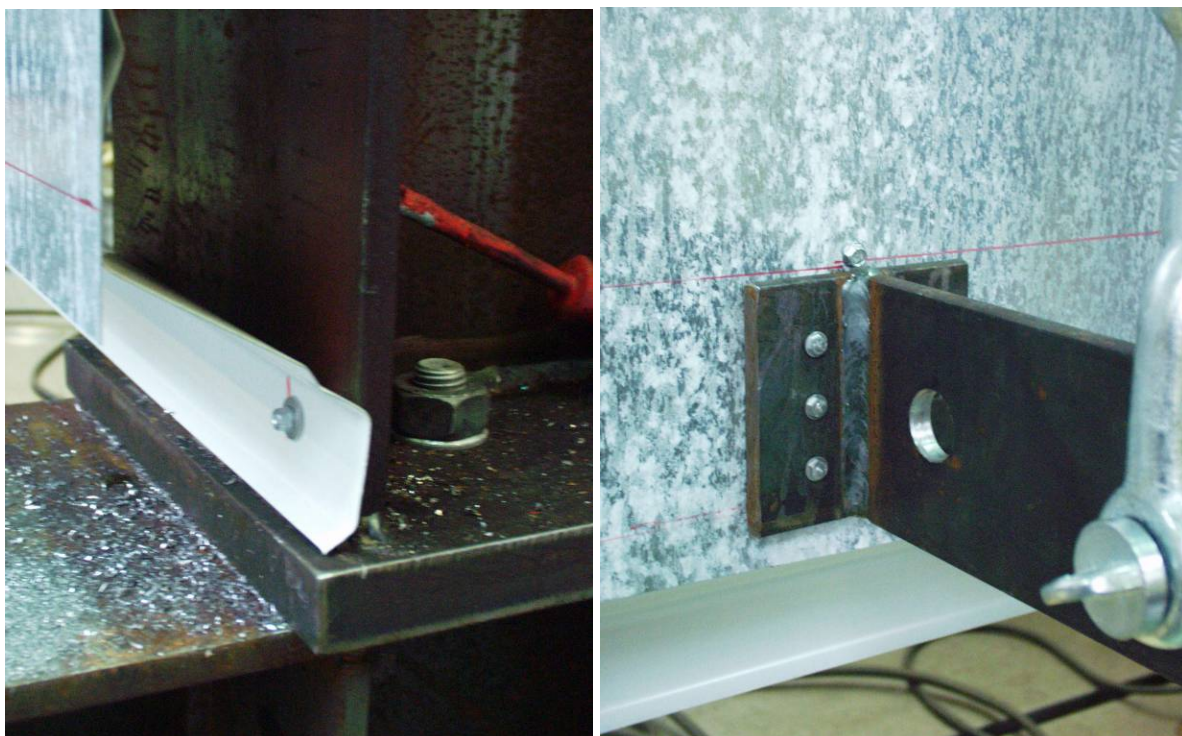
Abbildung A.106: Befestigung und Lasteinleitung
