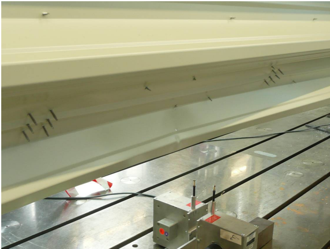
Abbildung A.97: Rückseite mit Beule im Übergangsbereich Gurt-Steg
