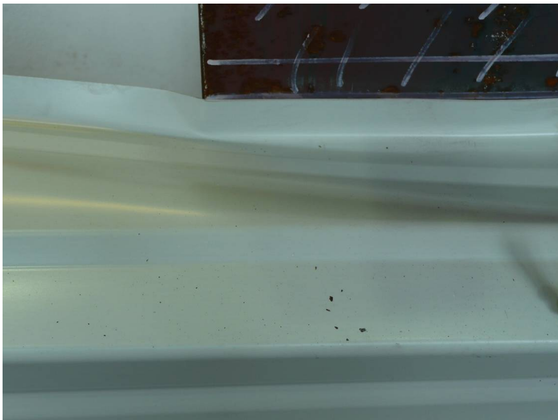
Abbildung A.74: Stegkrüppeln am Auflager
