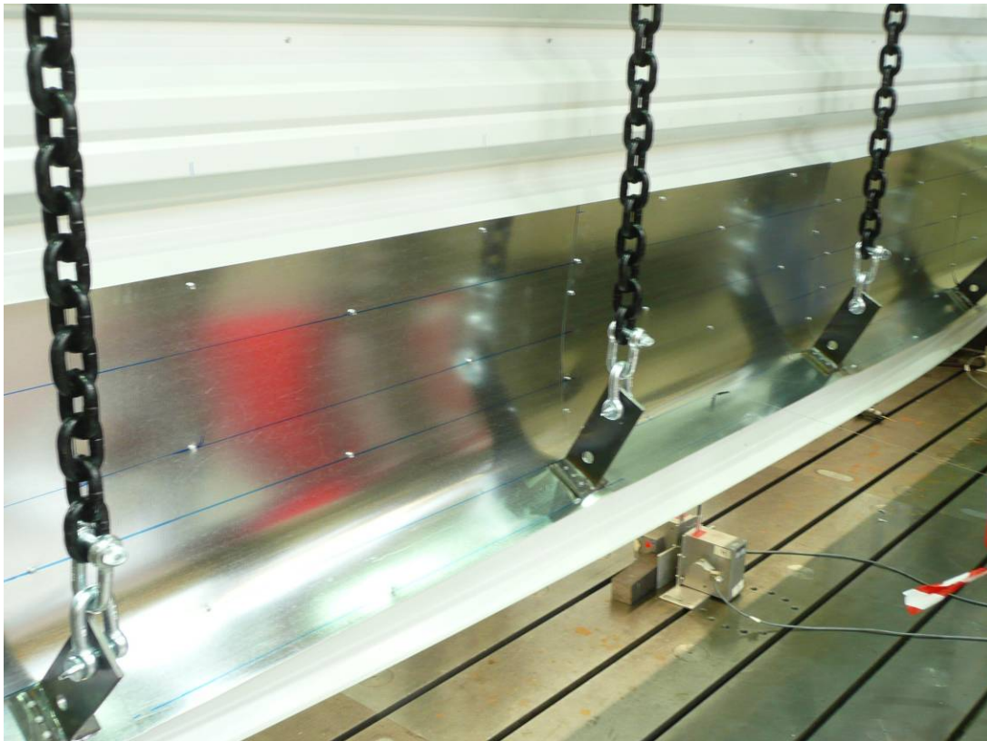
Abbildung A.121: Gurtverdrehung
