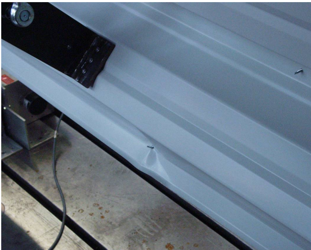
Abbildung A.167: Knick im freien Untergurt
