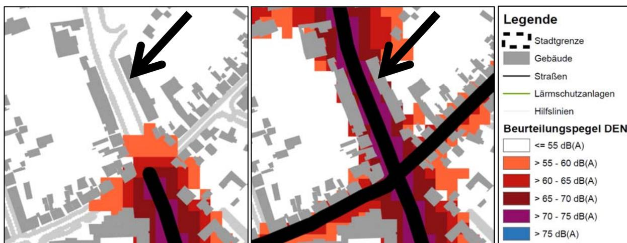
Abbildung 2: Vergleich Lärmkartierung 1. Stufe mit Kartierung des Gesamtnetzes
