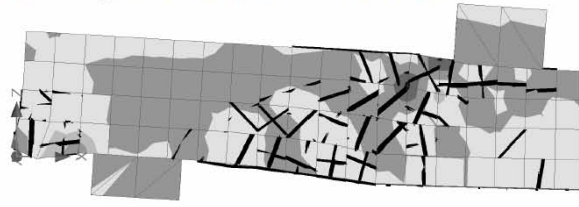
Mit aufgeklebten CFK-Lamellen verstärkt und mit glattem Betonstahl bewehrt
