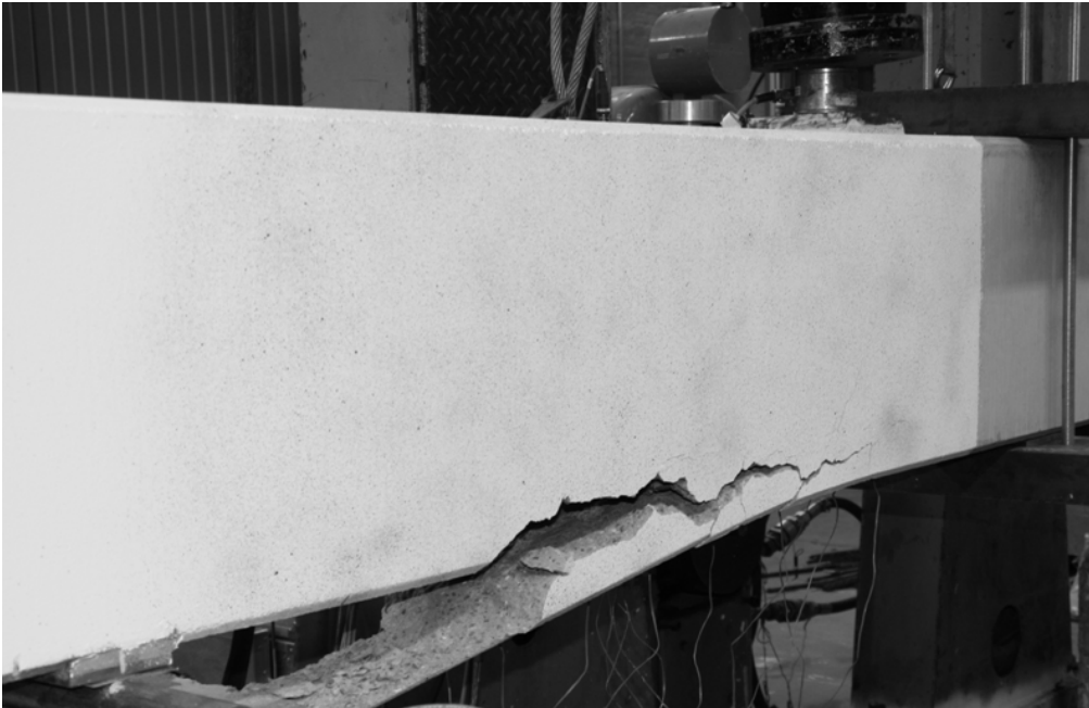
Bild 3.25: Versuch QVBA4-2 (Mit aufgeklebten CFK-Lamellen verstärkter Balken): Bruchbild
