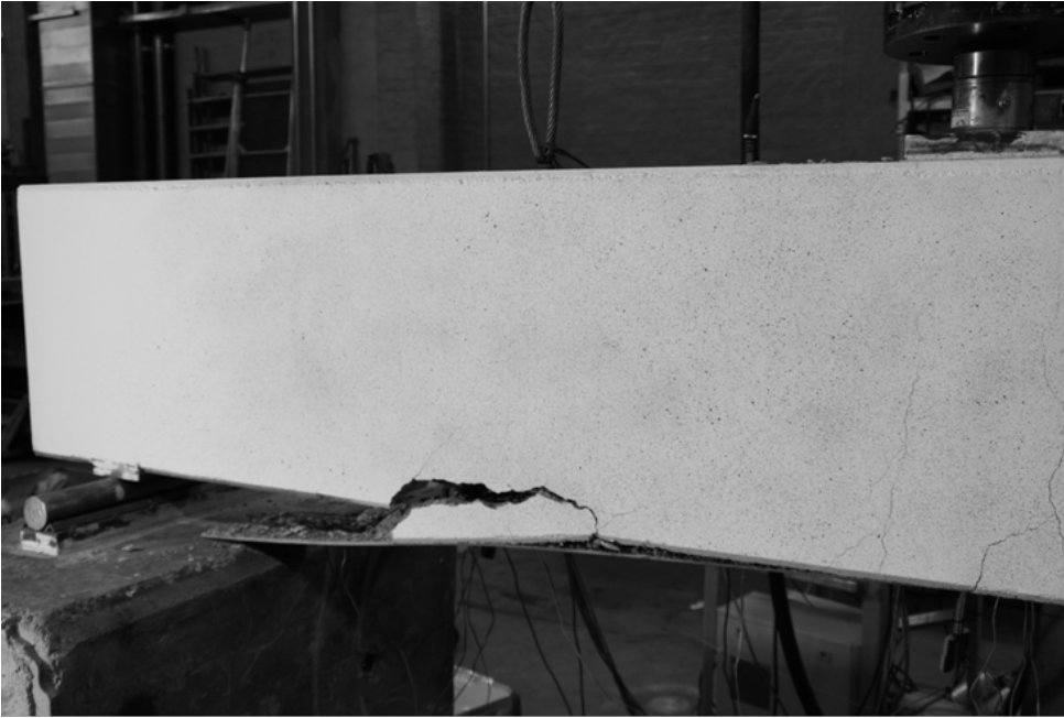
Bild 3.13: Versuch QVBA3-2 (Mit aufgeklebten CFK-Lamellen verstärkter Balken): Bruchbild
