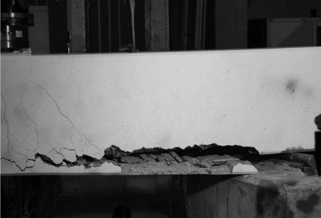
Bild 3.19: Versuch QVBE3-2 (Mit in Schlitze verklebten CFK-Lamellen verstärkter Balken): Bruchbild
