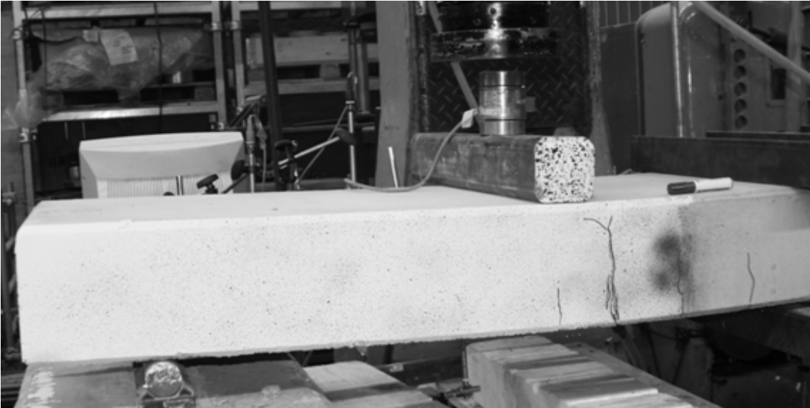
Bild 3.41: Referenzversuch QVPR1-1: Bruchbild
