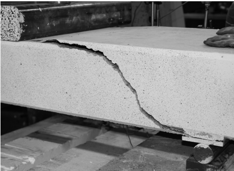
Bild 3.32: Versuch QVPA2-2 (Mit aufgeklebten CFK-Lamellen verstärkte Platte): Bruchbild
