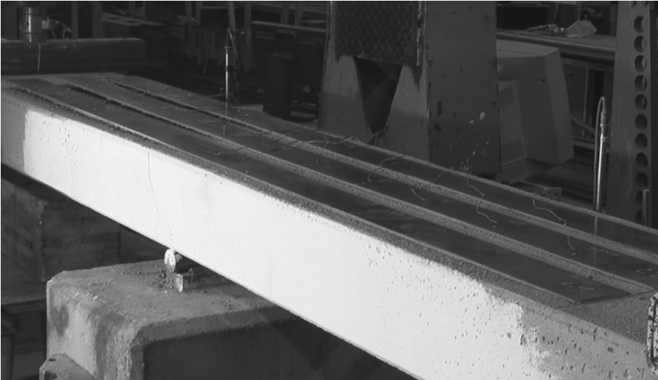
Bild 3.47: Lamellenablösung bei dem mit aufgeklebten CFK-Lamellen verstärkten Plattenversuches QVPA3
