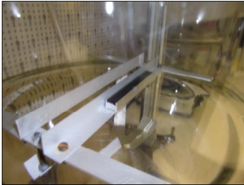
Abbildung 11: Prüfstück H4870-16 in der 0,02 m 3 Prüfkammer
