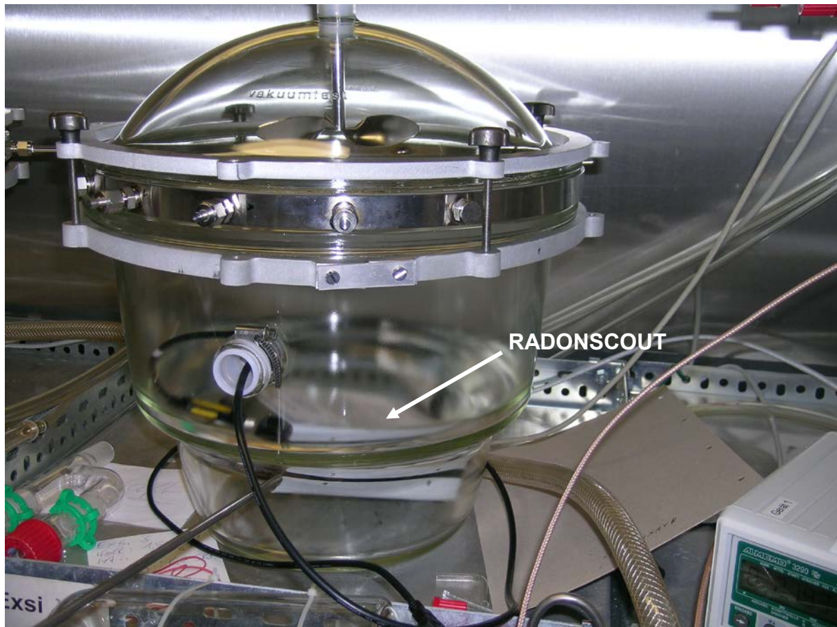
Abbildung 3.1: Glasexsikkator mit eingestelltem RADONSCOUT, Kammervolumen V = 21,9 \text{ L}
