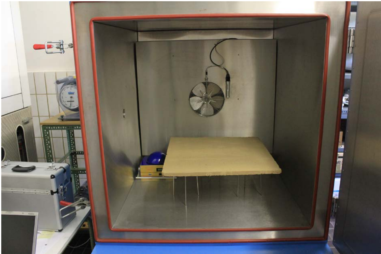
Abbildung 3.2: 1 m 3 -Prüfkammer, hier mit einer Lehmbauplatte beladen
