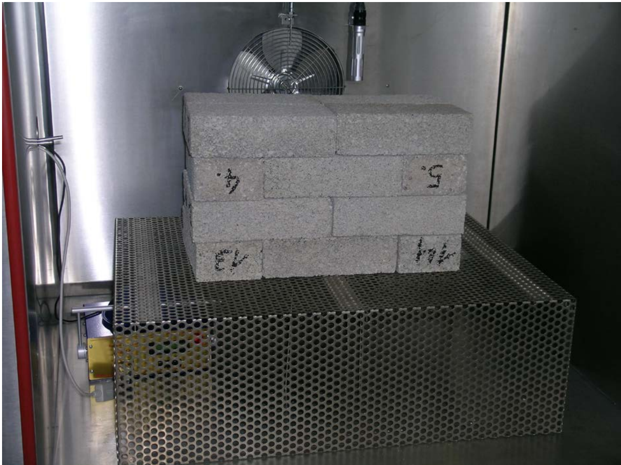
Abbildung 3.16: Anordnung der 16 Leichtbetonsteine in Kompaktbauweise
