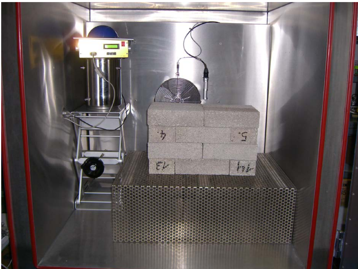
Abbildung 3.18: Positionsänderung des RADIM 3 A vom Kammerboden in das obere Kammerviertel
