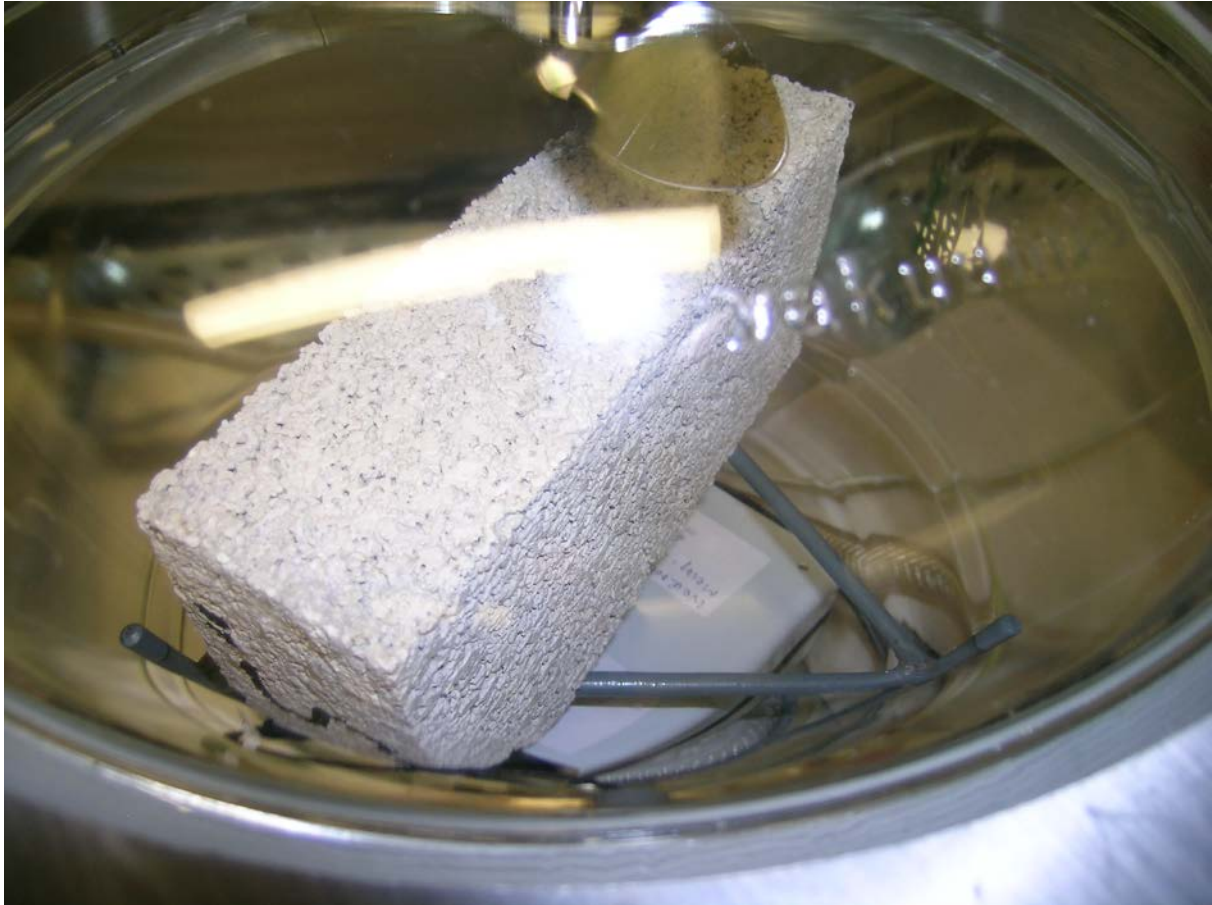
Abbildung 3.17: Leichtbetonstein in Kleinemissionskammer ( V = 21,9 \text{ L} ) bei n \approx 0 ( n = 0,13 \text{ d}^{-1} ) und Homogenisierung der Probenluft mittels Rührer
