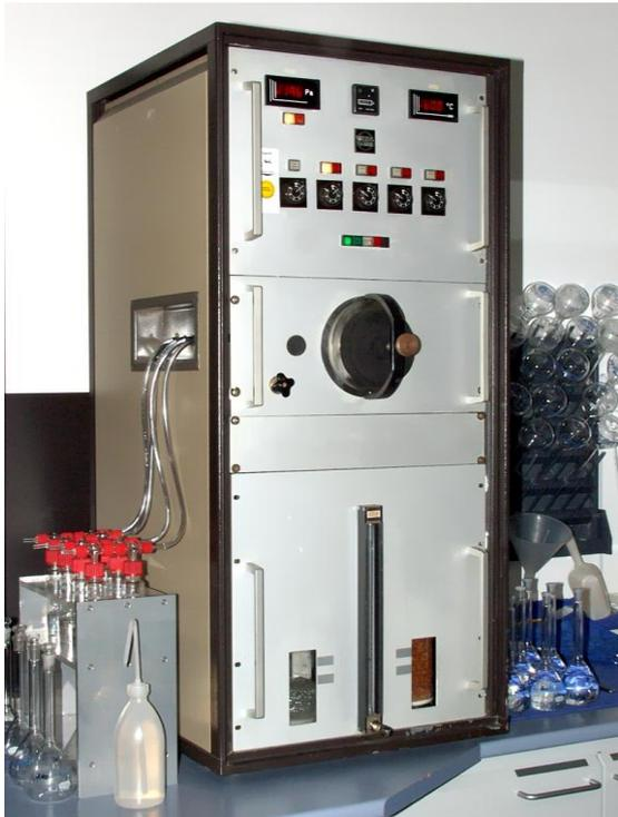
**Abbildung A2-2:** Schematischer Aufbau (links) und ausgeführte Prüfapparatur gemäß Gasanalyse-Methode DIN EN 717-2
