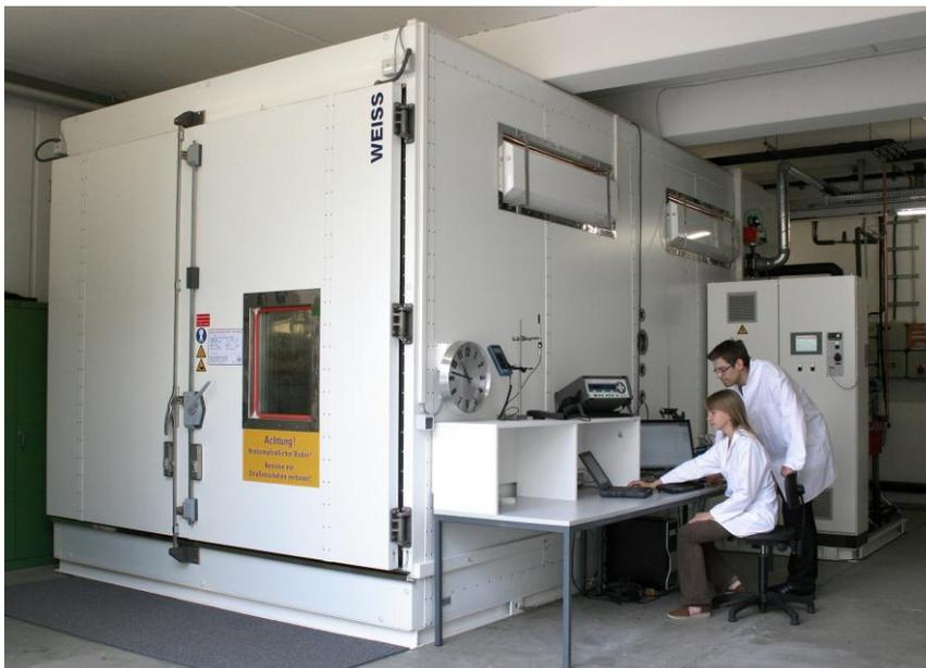
**Abbildung A1-2:** Außenansicht des großen Prüfraums ( $48 \text{ m}^3$ ) nach DIN EN 717-1
