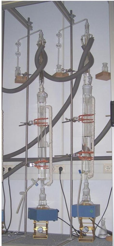
**Abbildung A2-1:** Schematischer Aufbau (links) und ausgeführte Prüfapparatur gemäß Perforator-Methode DIN EN 120
