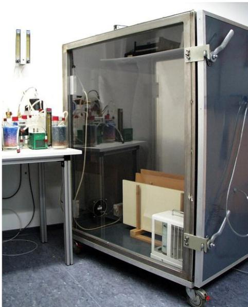
**Abbildung A1-5:** Ausgeführte 1m<sup>3</sup>-Kammer
