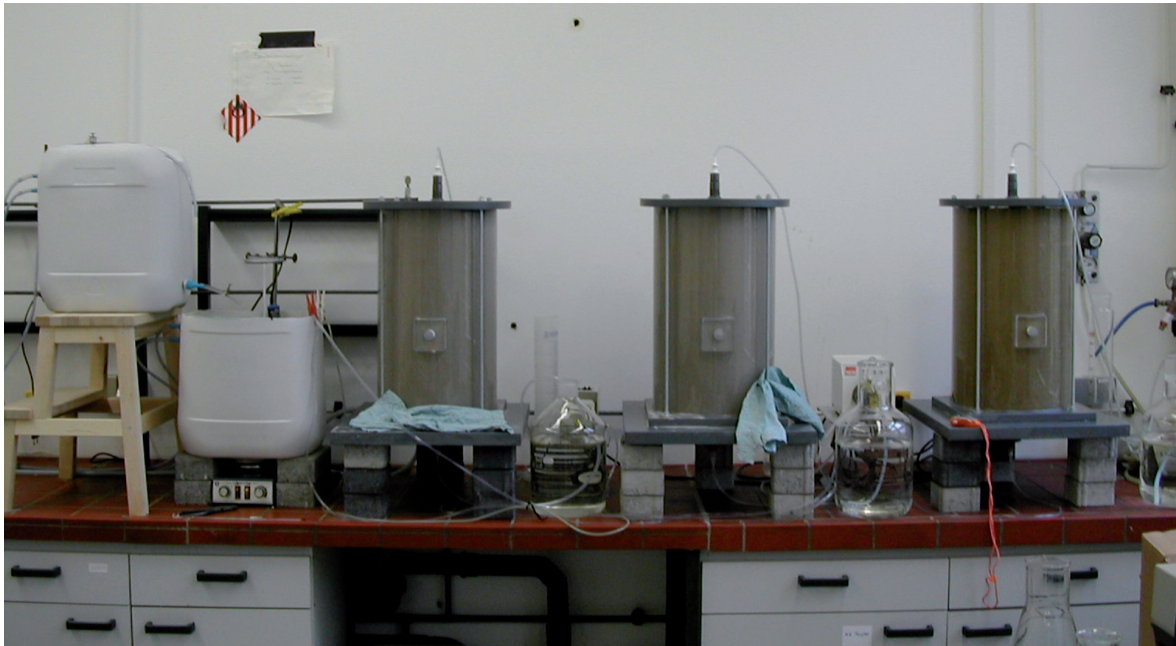
Abbildung 4: Säulenanlage mit Vorratsgefäß
