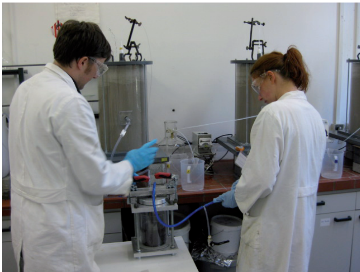
Abbildung 6: Injektion mittels Windkesselanlage
