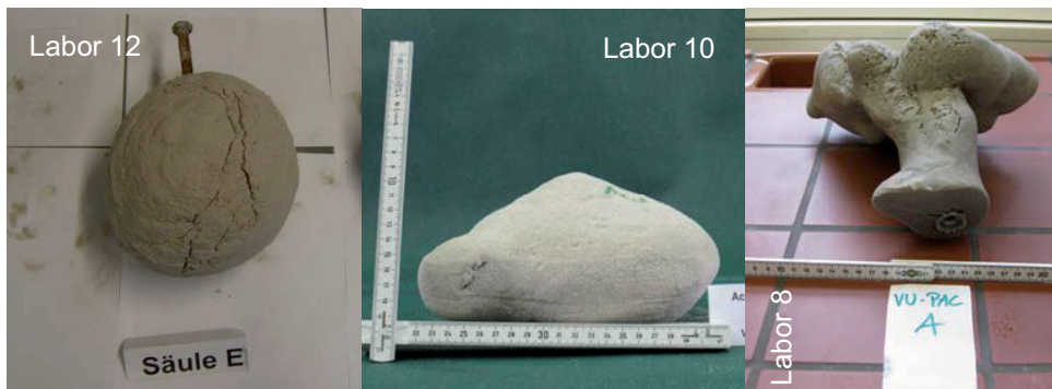
Abbildung 32: Polyacrylatkörper der VU, Auswahl; gesamte Probekörper in Anhang 10 dargestellt
