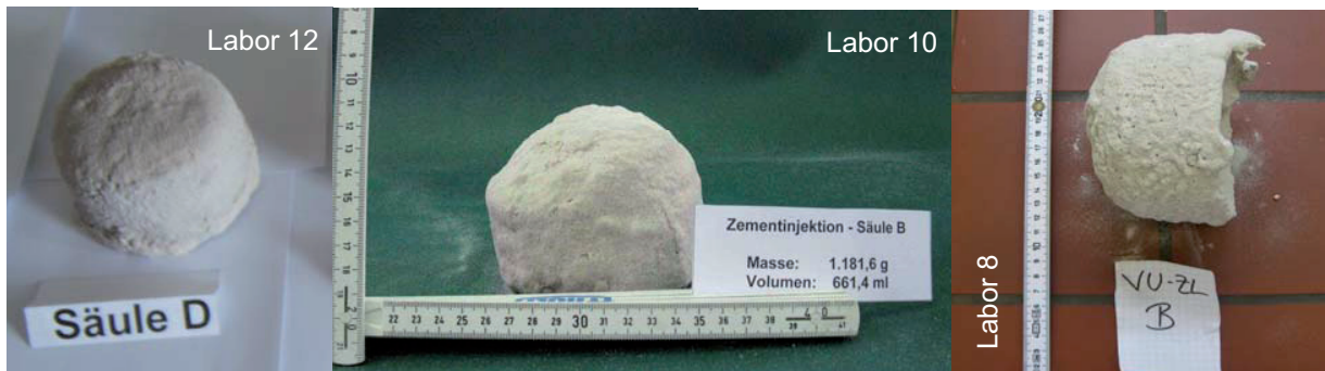
Abbildung 31: Zementleimkörper der VU, Auswahl; gesamte Probekörper in Anhang 10 dargestellt
