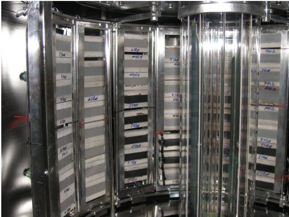
Bild 8: Bewitterungsgerät (Atlas Beta LM), mit den Probekörpern bestückt
