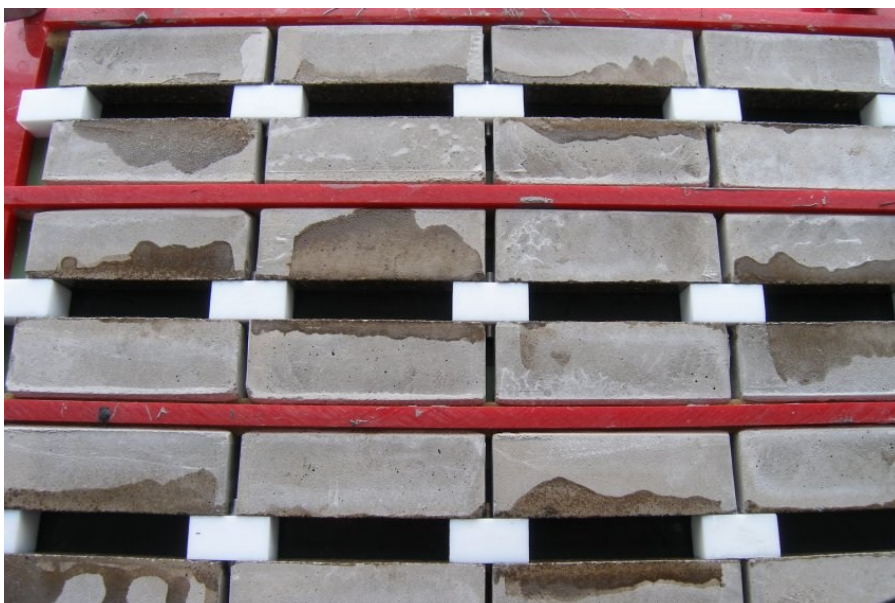
Bild 4: Betonkörper mit Abstandshaltern (12 mm) vor dem Einbringen des Fugendichtstoffes
