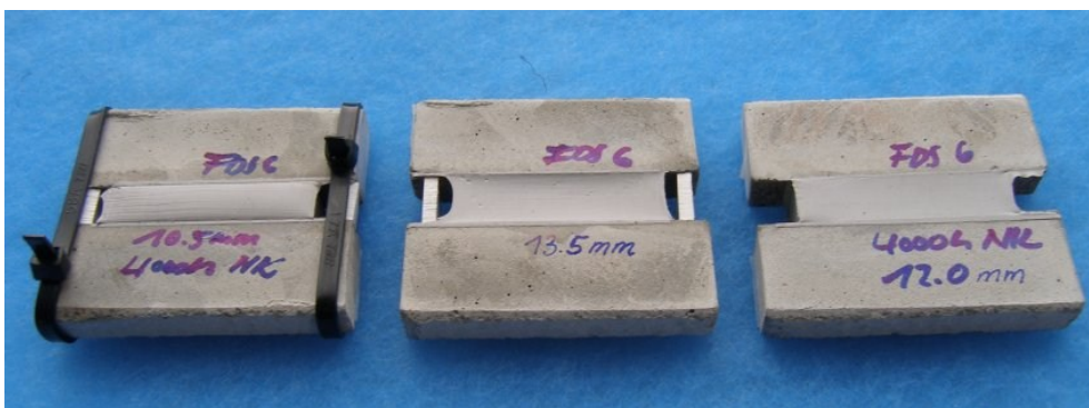
Bild 6: Ausgehärtete Betonprobekörper Links: Gestauchter Probekörper (-12,5 %) Mitte: Gedehnter Probekörper (+12,5 %) Rechts: Unbelasteter Probekörper mit einer Fugenbreite von 12 mm
