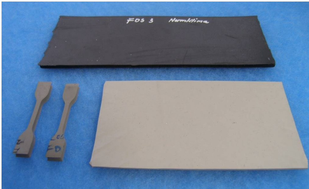
Bild 7: Gepresste Folien (Einkomponenten-Fugendichtstoff) bzw. gegossene Folien (Zweikomponenten-Fugendichtstoffe)
