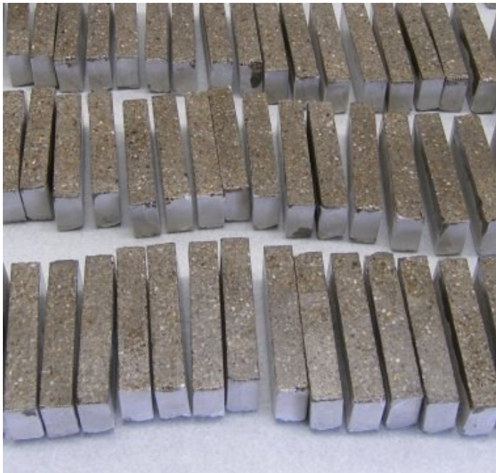
Bild 3: Betonprobekörper, Kontaktflächen mit Primer
