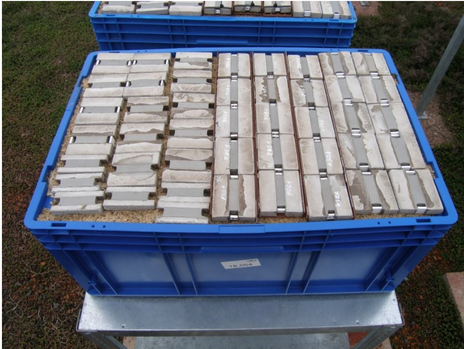
Bild 10: Betonprobekörper in der Freibewitterung
