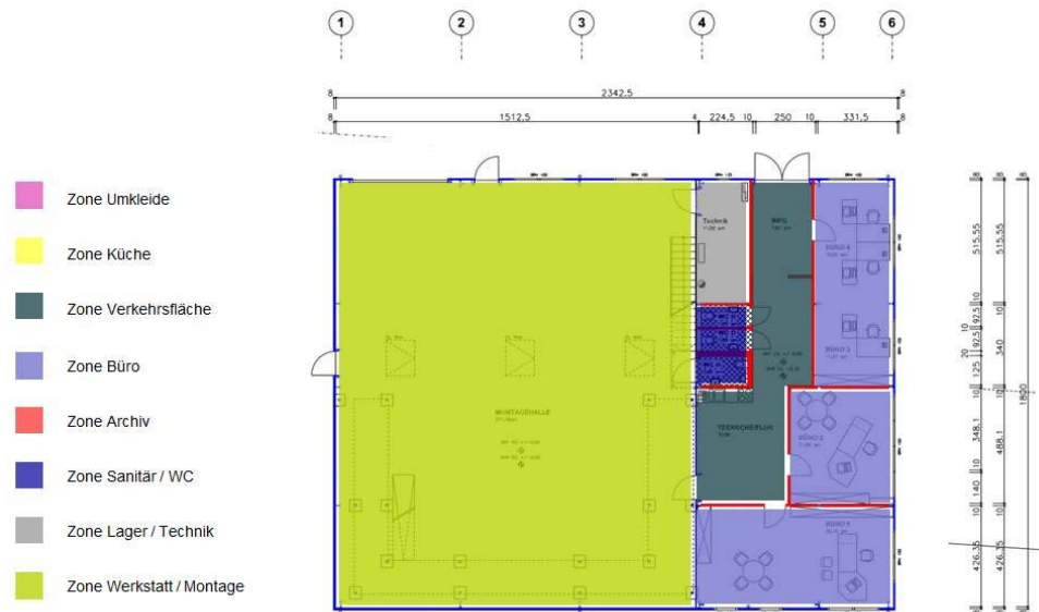
Bild 7: Beispiel-Gebäude zur Erläuterung der Randbedingungen für die Bestimmung des exponierten Umfangs der Bodenplatte [Friederichs].
