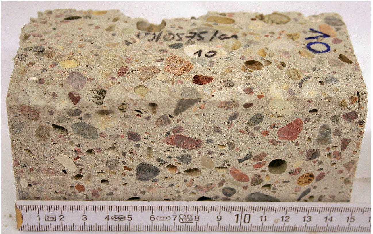
Abbildung 2: Prüfkörper 10 nach der Einlagerung in Prüflösung B (ohne Buttersäure) nach 90 d
