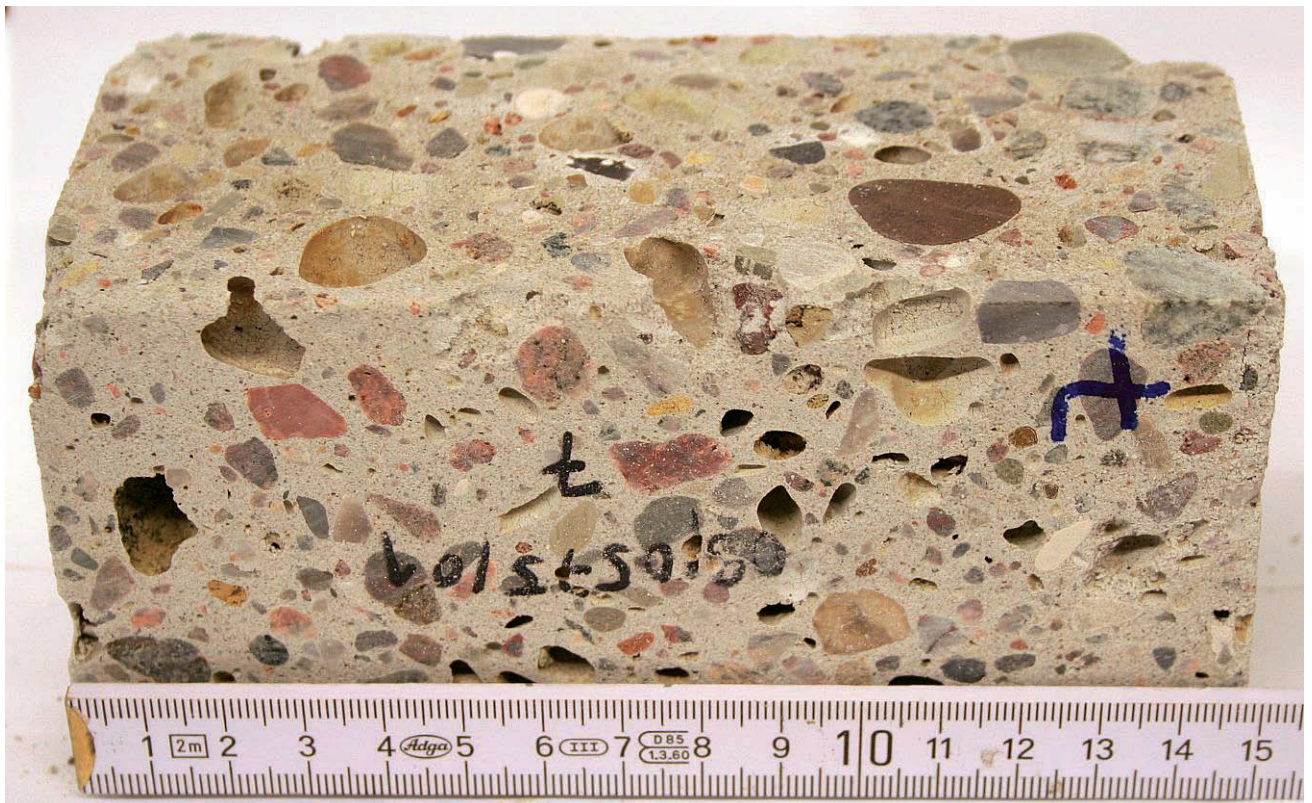
Abbildung 1: : Prüfkörper 7 nach der Einlagerung in Prüflösung A (mit Buttersäure)nach 90 d
