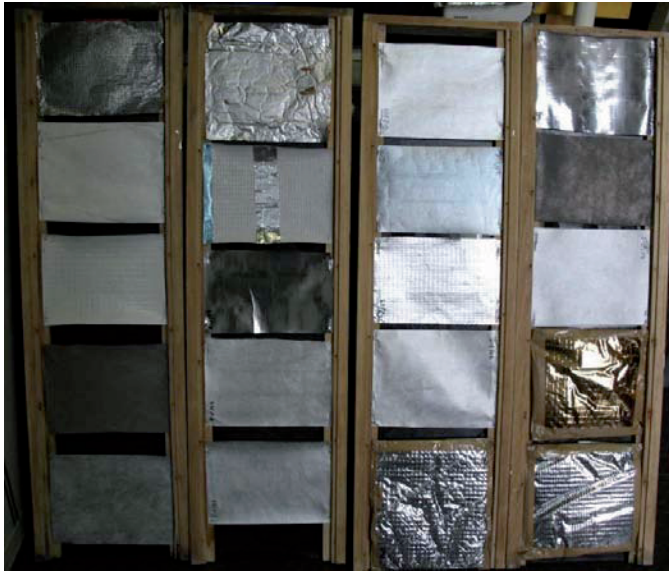
Abbildung 13 Geschützt eingebaute Proben für die geschützte Freibewitterung vor Montage der Abdeckung. Das Foto zeigt Probekörper aus dem Vorgängervorhaben (Tabelle 2) und Probekörper aus Tabelle 1
