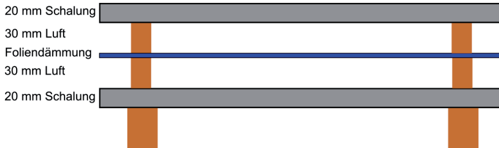
Abbildung 37 Schematischer Aufbau der vereinfachten Dachkonstruktion
