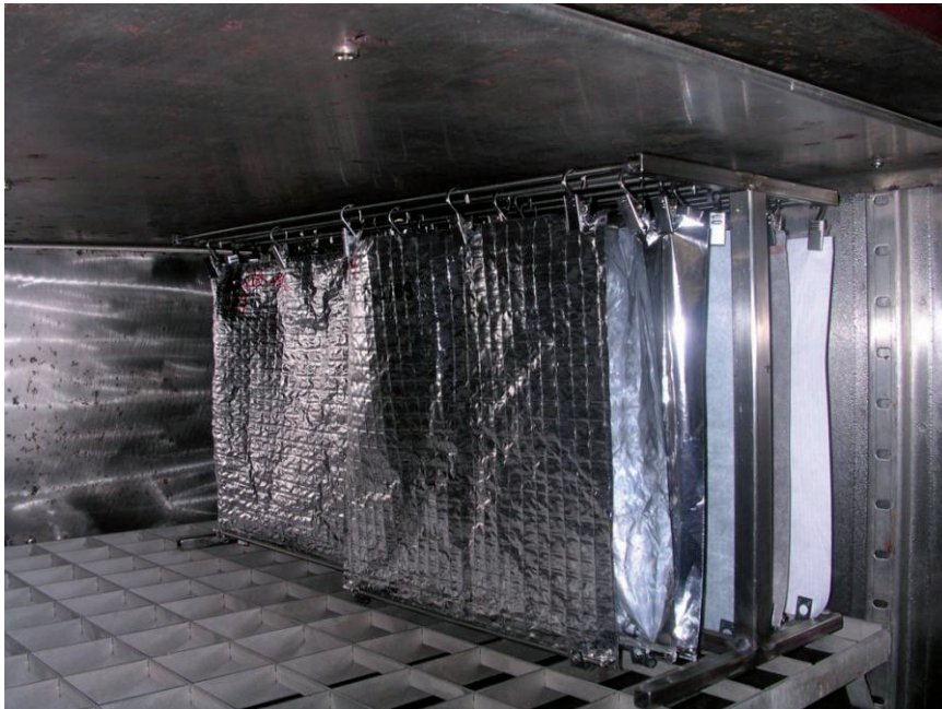
Abbildung 29 Probekörper im Klimaschrank, vor der Alterung nach den Beurteilungsgrundlagen der EOTA
