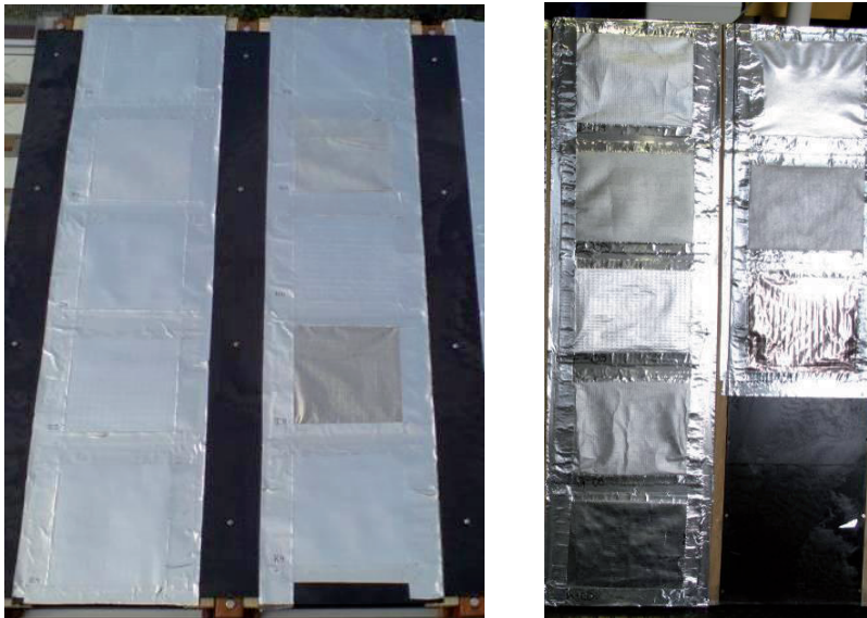
Abbildung 14 Der Witterung ausgesetzte Proben für die ungeschützte Freibewitterung. Das linke Foto zeigt Probekörper aus dem Vorgängervorhaben (Tabelle 2), das rechte Foto einen Teil der Probekörper aus Tabelle 1
