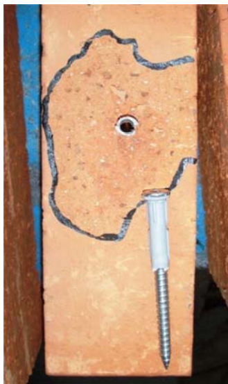
Abb. 4.6: Stein der Charge HH 1 mit Dübel B nach dem Versuch; Versagensart: Steinausbruch
