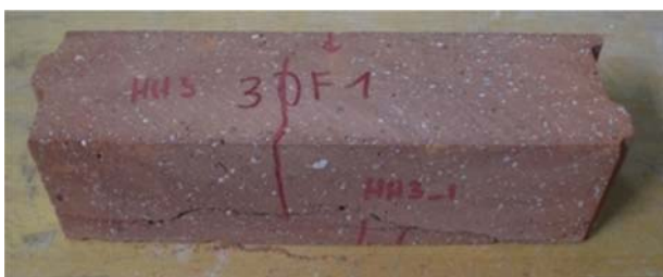
Abb. 3.22: Probe zur Serie BZ_HH3: Riss verläuft durch die Schwindrisse
