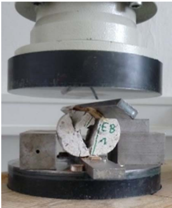
Abb. 3.37: Aufgespaltene Kalksandsteinprobe nach dem Versagen
