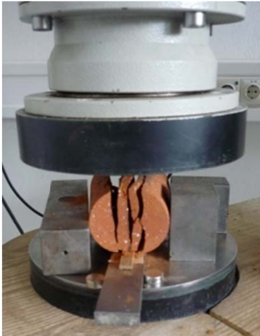
Abb. 3.35: Ziegelsteinprobe beim Versagen
