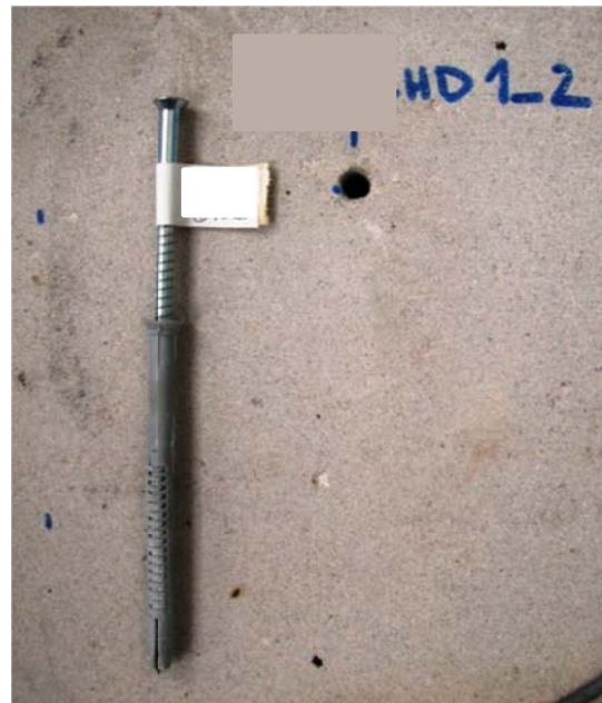
Abb. 4.12: Stein der Charge HD 1 mit Dübeln B nach dem Versuch; Versagensart: Auszug
