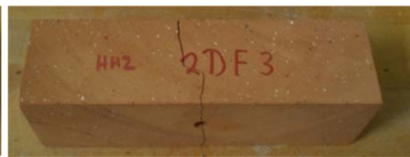
Abb. 3.19: Probe BZ_HH2_3: Riss verläuft durchs Loch
