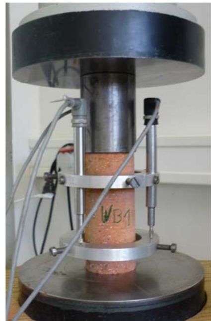
Abb. 3.4: Prüfung des statischen E-Moduls, Detail
