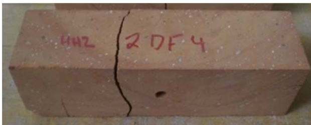
Abb. 3.20: Probe BZ_HH2_4: Riss läuft am loch vorbei
