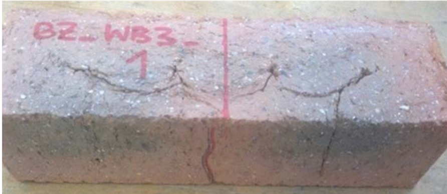
Abb. 3.12: Probe zur Serie BZ_WB3 nach dem Versuch
