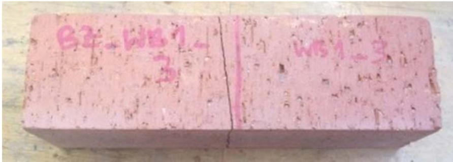
Abb. 3.10: Probe zur Serie BZ_WB1 nach dem Versuch
