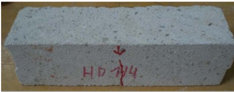
Abb. 3.31: Probe zur Serie BZ_HD1 mit Riss
