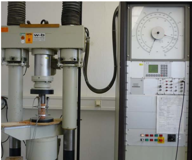
Abb. 3.3: Prüfung des statischen E-Moduls, Gesamtansicht
