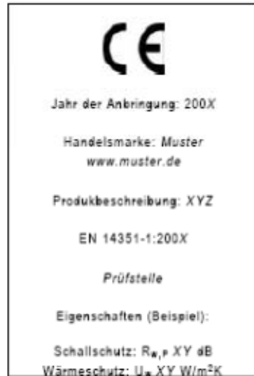
Bild 23: Beispiel einer CE-Kennzeichnung am Fensterrahmen im Innenbereich, nach [78]
