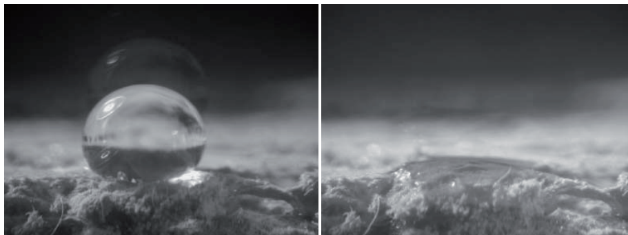
Abbildung 26: Wassertropfen auf einer nicht hydrophobierten Probe nach 0 s (links) und 30 s (rechts).
