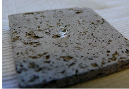
Abbildung 32: Nachträgliche Hydrophobierung mit Hydrophobierungsmittel auf Siloxanbasis.
