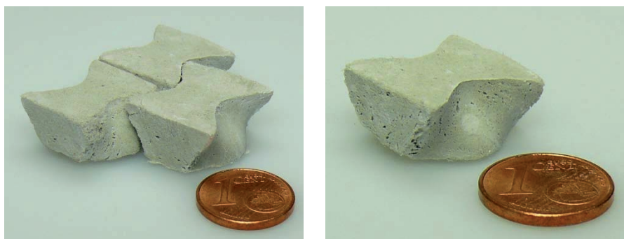
Abbildung 12: Struktur einer Probe hergestellt mittels Freeze Gelation.
