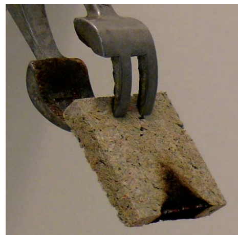
Abbildung 21: Papierplatte aus Papierstaub mit 0,38 % Boratgehalt, links während des Brandtests, rechts nach einer Flammdauer von 20 s ohne zu löschen, die Probe glimmt wenig.
