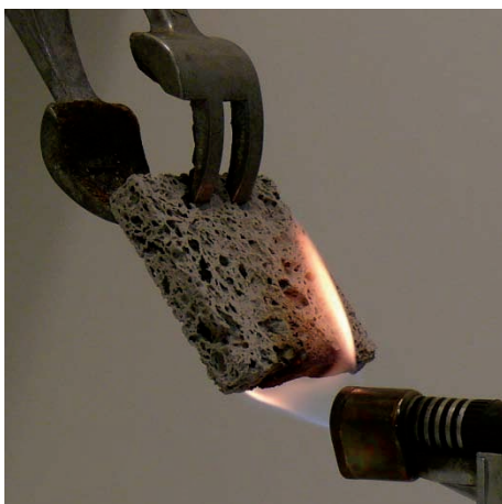
Abbildung 18: Papierplatte aus Papierstaub mit 4,79 % Boratgehalt, links während des Brandtests, rechts nach einer Flammdauer von 20 s ohne zu glimmen.
