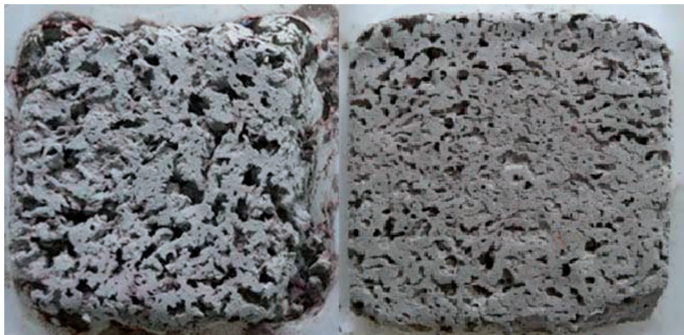
Abbildung 8: Porenverteilung bei Zugabe von unterschiedlichem Wassergehalt. Links sind 325 wt-% Wasser bezogen auf die Papierstaubmasse und rechts 250 wt-% Wasser bezogen auf die Papierstaubmasse.
