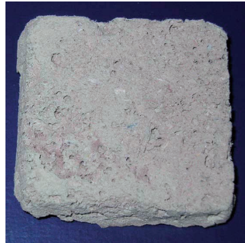
Abbildung 7: Papierplatte hergestellt mit dem Triebmittel \text{NaHCO}_3 .
