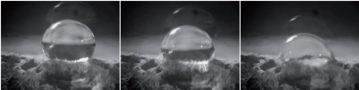
Abbildung 28: Wassertropfen auf einer mit Siliconaten hydrophobierten Probe nach 60 s (links), 300 s (mitte) und 600 s (rechts).
