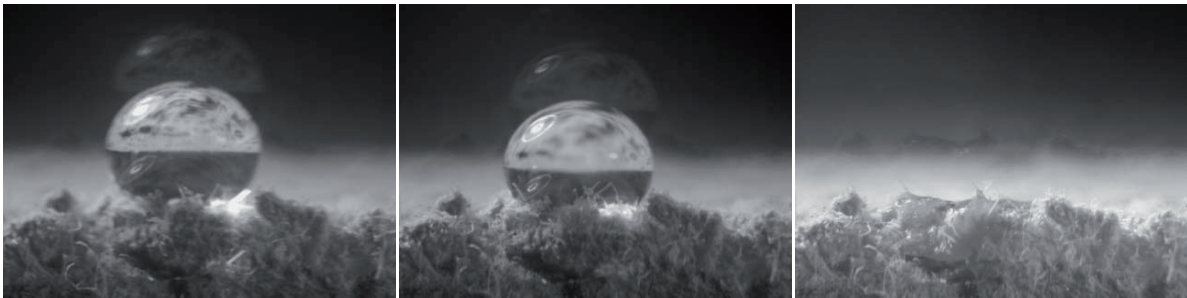
Abbildung 30: Wassertropfen auf einer mit Gluten gebundenen Probe nach 0 s (links), 90 s (mitte) und 180 s (rechts).
