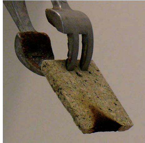
Abbildung 19: Papierplatte aus Papierstaub mit 25,14 % Boratgehalt, links während des Brandtests, rechts nach einer Flammdauer von 20 s ohne zu löschen, die Probe glimmt wenig.
