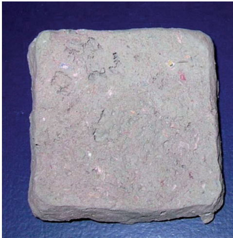
Abbildung 6: Papierplatte hergestellt ohne das Triebmittel \text{NaHCO}_3 .
