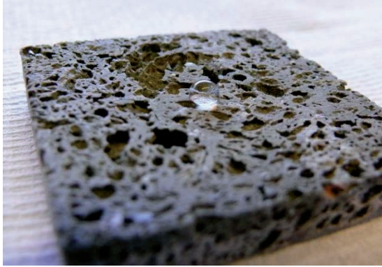
Abbildung 31: Nachträgliche Hydrophobierung mit OFS0777 von Xiameter.
