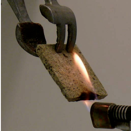
Abbildung 19: Papierplatte aus Papierstaub mit 25,14 % Boratgehalt, links während des Brandtests, rechts nach einer Flammdauer von 20 s ohne zu löschen, die Probe glimmt wenig.
