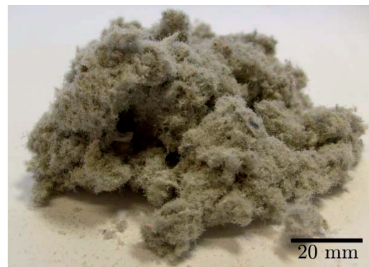
Abbildung 2: Papierstaub mit hohem Boratgehalt von 25,14 % (PSHB).
