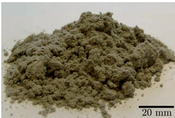
Abbildung 1: Papierstaub (Feinstofffraktion), mit normalem Boratgehalt von 4,79 % (PSNB).
