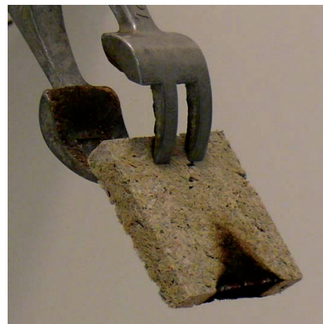
Abbildung 20: Papierplatte aus Celluloseflocken mit (\text{NH}_4)_5\text{P}_5\text{O}_{10} (17,43 %), \text{Al}(\text{OH})_3 und Borat (0,74 %), links während des Brandtests, rechts nach einer Flammdauer von 20 s ohne zu löschen, die Probe glimmt wenig.
