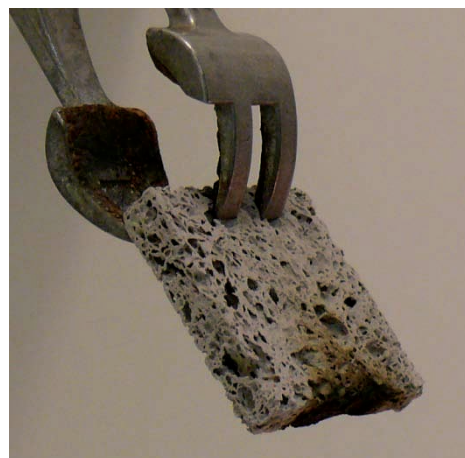
Abbildung 18: Papierplatte aus Papierstaub mit 4,79 % Boratgehalt, links während des Brandtests, rechts nach einer Flammdauer von 20 s ohne zu glimmen.
