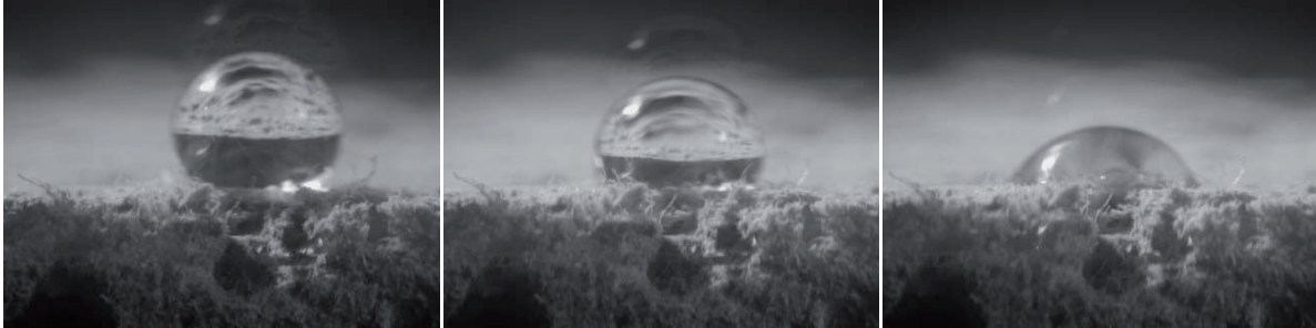
Abbildung 29: Wassertropfen auf einer mit Acrylbinder gebundenen Probe nach 0 s (links), 180 s (mitte) und 360 s (rechts).
