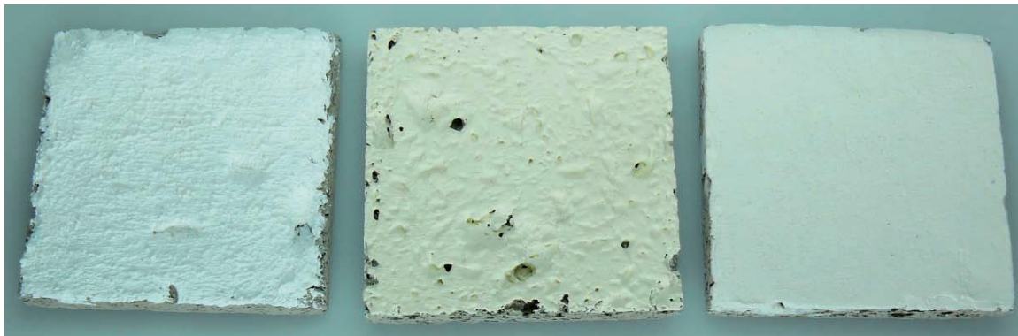
Abbildung 44: Papierplatten nach der Oberflächenbehandlung. Links, Papierplatte mit einem rauen Streichputz auf Kalkbasis für den Innenbereich, mittig Papierplatte mit Acrylfarbe gestrichen, rechts Papierplatte mit Gips verputzt.
