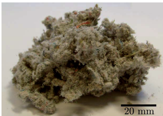
Abbildung 3: Celluloseflocke mit (\text{NH}_4)_5\text{P}_5\text{O}_{10} (17,43 %), \text{Al}(\text{OH})_3 und Borat (0,74 %) (CFNA).
