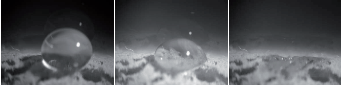
Abbildung 27: Wassertropfen auf einer mit DC 520 hydrophobierten Probe nach 60 s (links), 180 s (mitte) und 300 s (rechts).
