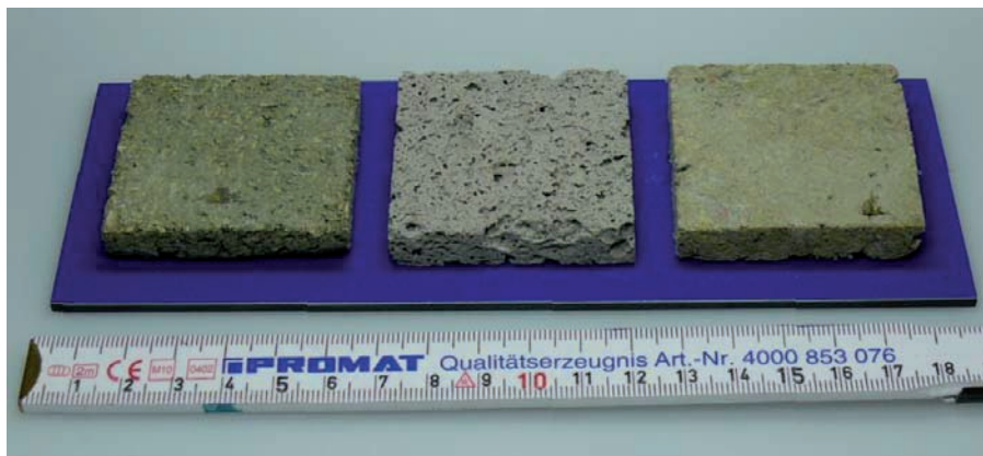
Abbildung 11: Die Struktur der Proben variiert je nach Ausgangsmaterial, links Papierplatte mit geringem Boratgehalt (0,38 %), mittig Papierplatte mit 4,79 % Boratgehalt, rechts Papierplatte aus Celluloseflocke.
