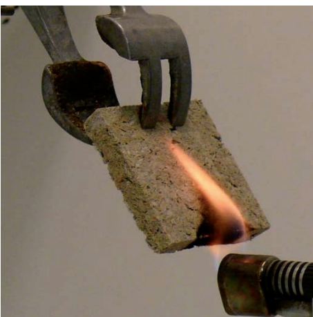
Abbildung 21: Papierplatte aus Papierstaub mit 0,38 % Boratgehalt, links während des Brandtests, rechts nach einer Flammdauer von 20 s ohne zu löschen, die Probe glimmt wenig.
