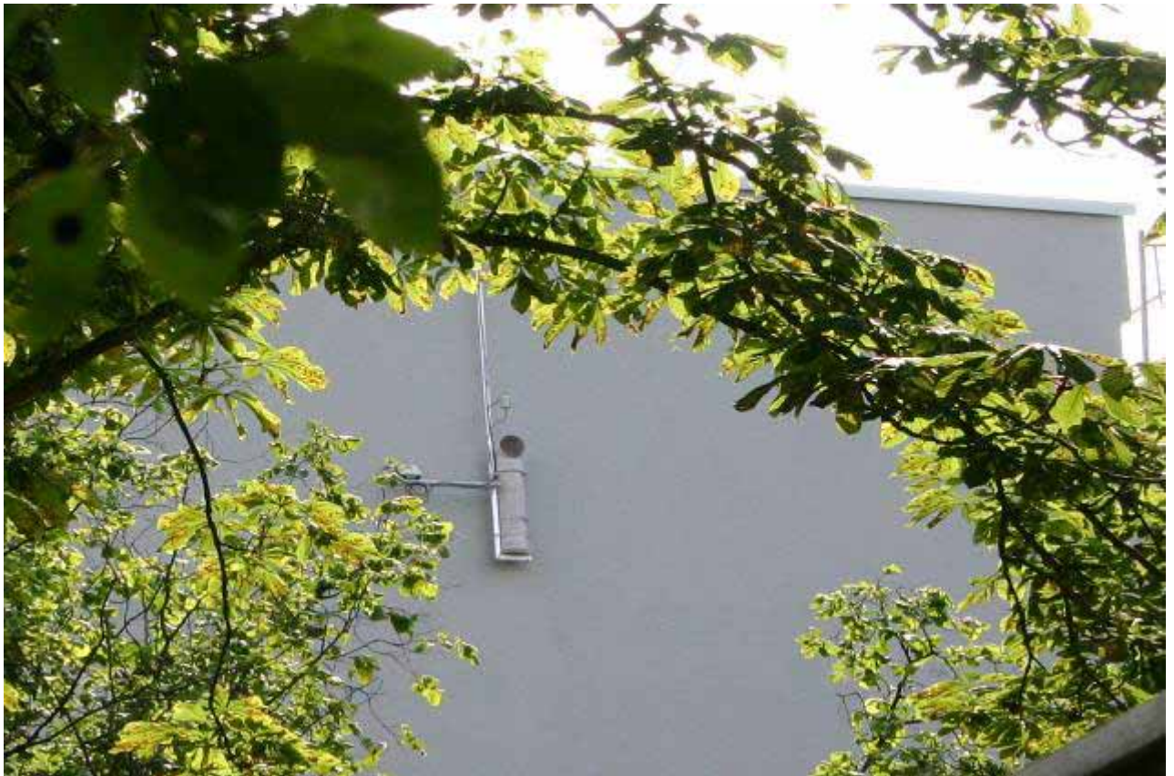
Abbildung 8.: Fassadenstativ mit Schlagregensammler, der vom 21.08.2007 bis 10.01.2008 neben dem elektronischen Regenmesser die Schlagregenbelastung der Fassade erfasste. Links der Ausleger mit dem elektronischen Regenmesser.
