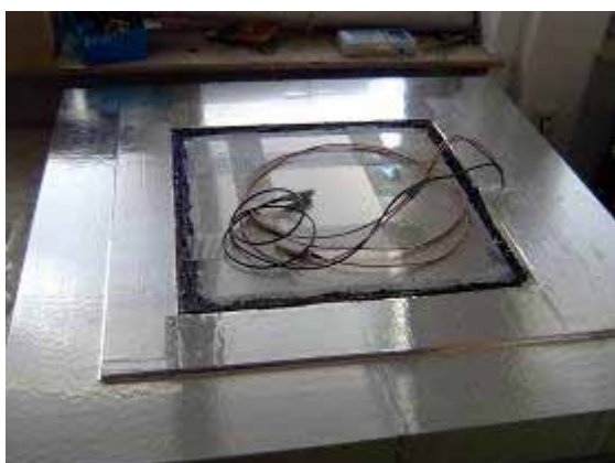
Abbildung 21: Einbaurahmen mit Folienkaschierung und eingebauter Probe inkl. Kabeldurchführung
