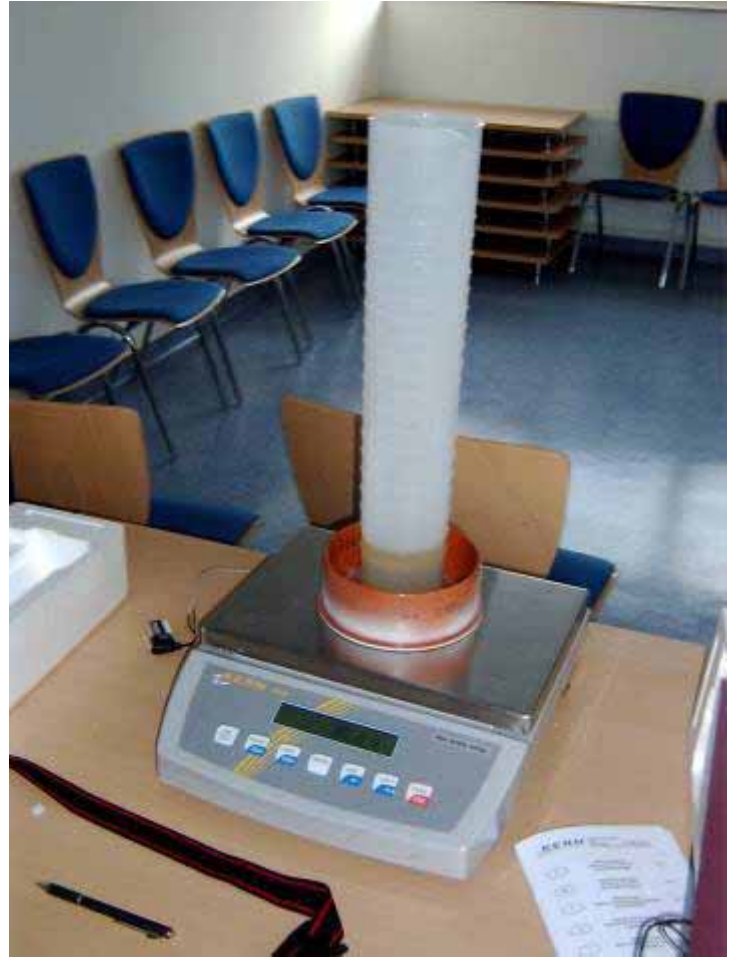
Abbildung 6.: Schlagregensammler, der vom 21.08.2007 bis 10.01.2008 neben dem elektronischen Regenmesser die Schlagregenbelastung der Fassade erfasste. Die gesammelte Wassermenge wurde vor Ort durch Wägung bestimmt.
