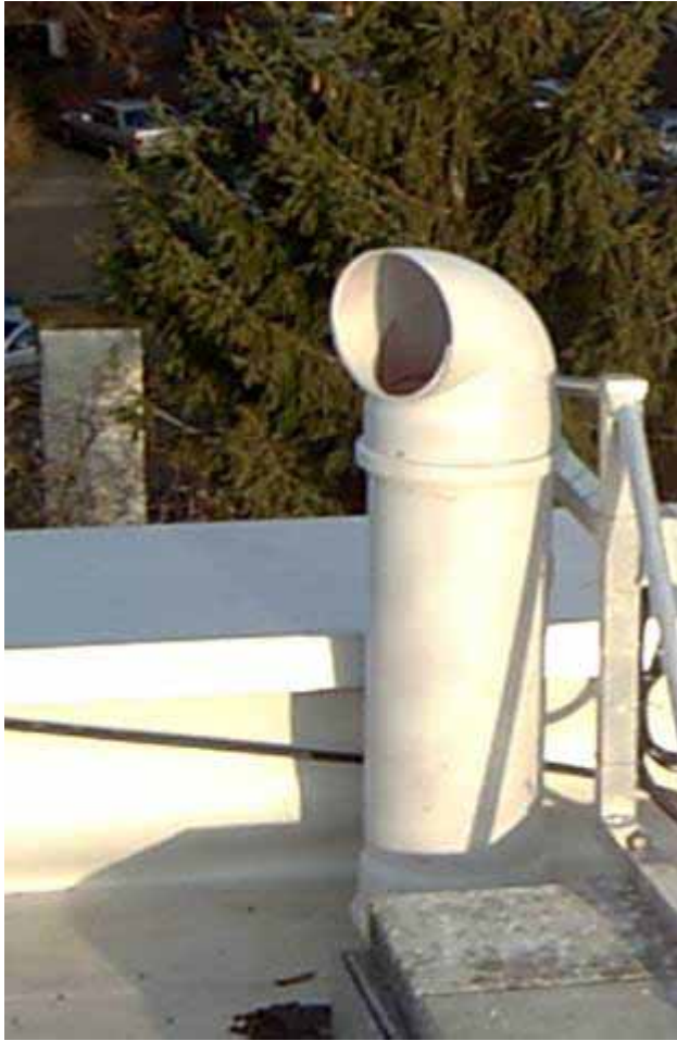
Abbildung 6.: Schlagregensammler, der vom 21.08.2007 bis 10.01.2008 neben dem elektronischen Regenmesser die Schlagregenbelastung der Fassade erfasste. Die gesammelte Wassermenge wurde vor Ort durch Wägung bestimmt.
