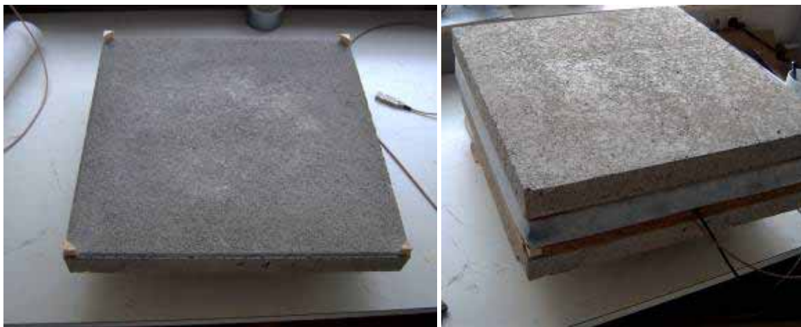
Abbildung 16 Abstandshalter für die Ausgleichsschicht und Schichtaufbau (obere Betonplatte nur zum Verpressen)
