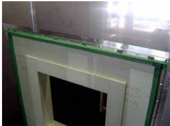
Abbildung 19: Differenzklimakammer-Prüfstand (Klima 1: „Außenklima bzw. Kaltseite“, Klima 2: „Innenklima bzw. Warmseite“)
