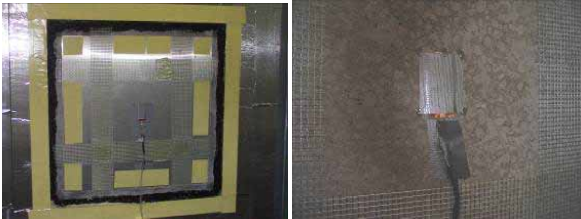
Abbildung 25: Oberflächentempersensoren auf Betonplatte (kaltseitig) bzw. VIP-Element (warmseitig)
