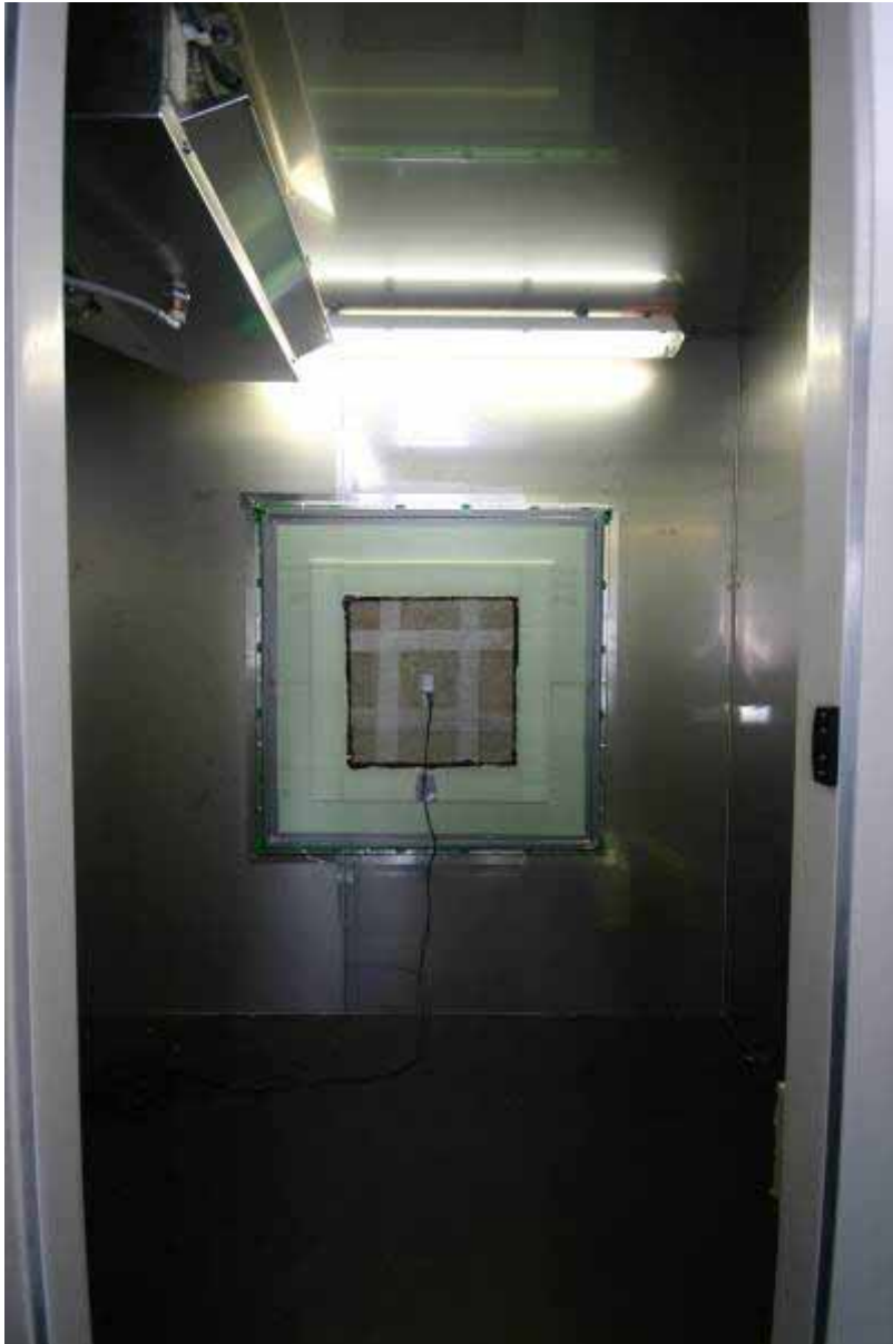
Abbildung 22: Blick in die „kaltseitige“ Hälfte der Klimakammer mit fertig eingebauter Probe und Oberflächentempersensor auf der Betonplatte
