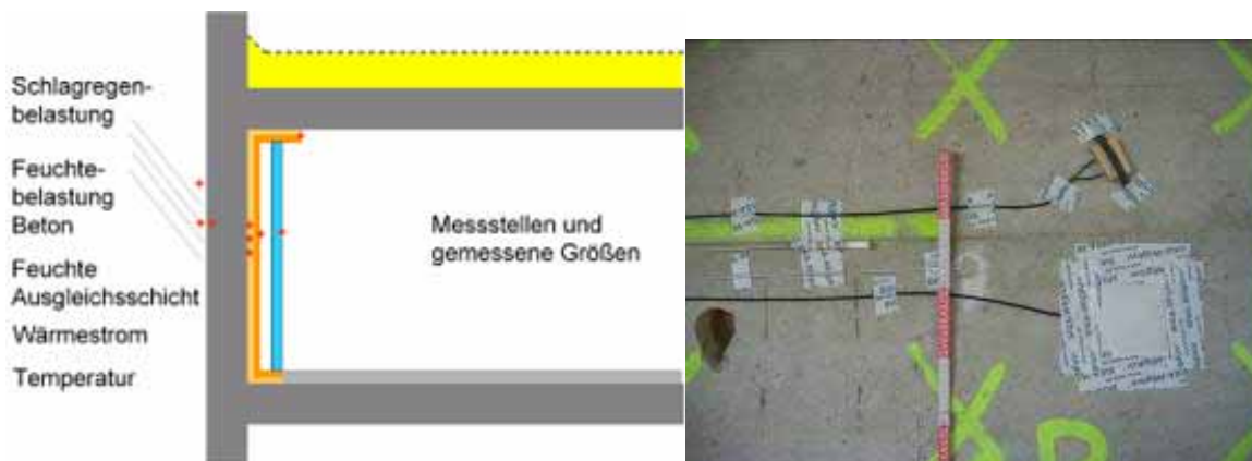
Übersicht Messstellen und Sensorfeld an der Innseite der Außenwand
