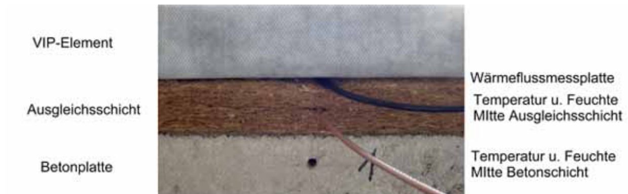
Abbildung 23 Schichtaufbau und Sensorpositionen im Probenkörper
