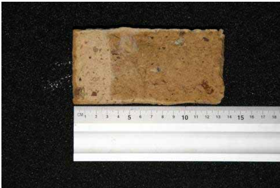
Abbildung 14: Hydrophobierungsprobe: Die Eindringtiefe der Hydrophobierung wurde anhand einer Materialprobe durch Auflegen auf einen befeuchteten Schwamm sichtbar gemacht (der heller Bereich vom ca. 3 cm hat praktisch kein Wasser aufgenommen).
