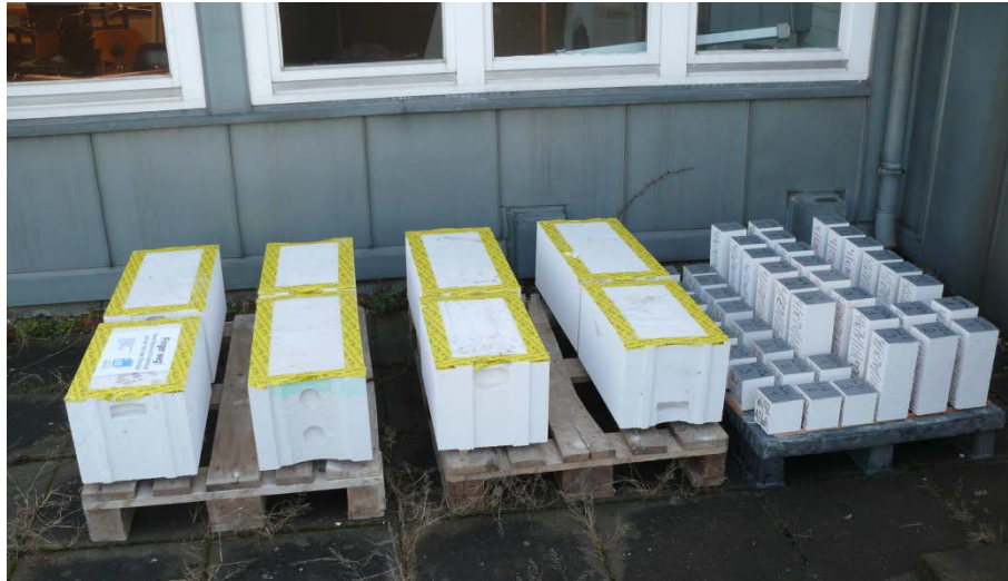
Abbildung 17: Zusätzliche Lagerung bei freier Bewitterung einzelner Proben (AL18+9)
