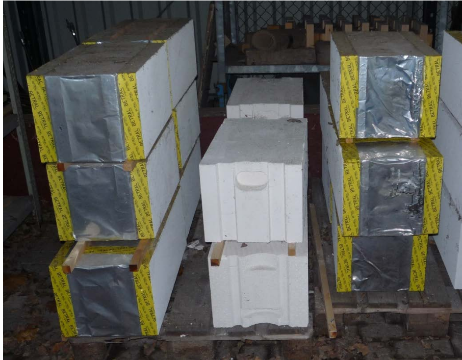
Abbildung 14: Steine mit Aluminiumfolie ummantelter Stoß- und Lagerfuge in der Außenlagerung (rechts und links im Bild)
