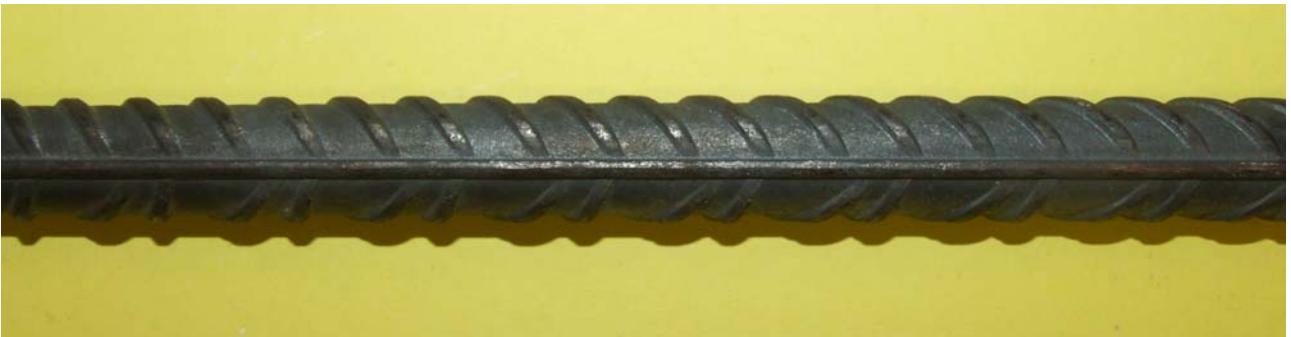
Bild B20: Betonstabstahl B500 B mit zwei Rippenreihen, davon eine alternierend, d_s = 14 mm
