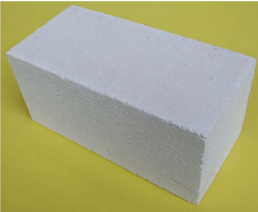
Bild B14: Teilstück (Format 2DF) aus Porenbeton-Planstein PP 4-0,55 (l/b/h 240/115/113 mm)
