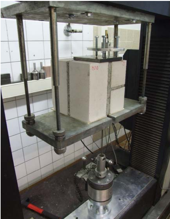
Bild 17: Ausziehversuche an Lagerfugenbewehrung; Prüfkörper und Prüfeinrichtung
