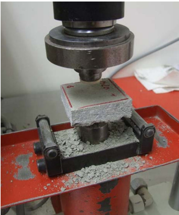
Bild B37: Prüfung der Fugendruckfestigkeit an aus der Lagerfuge entnommenen Mörtelscheiben nach /15/
