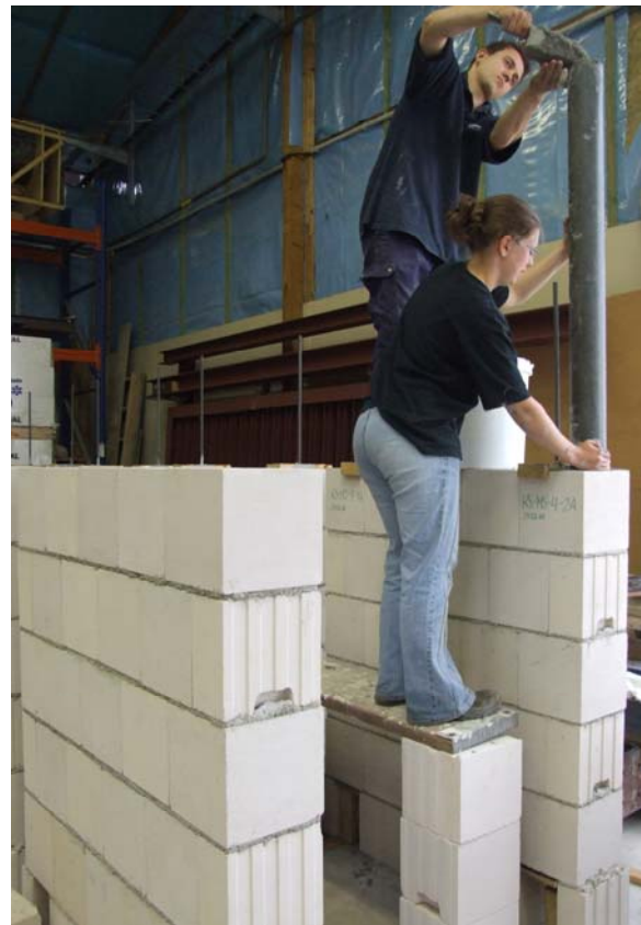
Bild 59: Untersuchungen an vertikal angeordneter Bewehrung in großen Aussparungen, Einfüllen des Mörtels direkt an der Wandoberkante (links) bzw. durch ein 1,25 m langes Aufsatzrohr (rechts)
