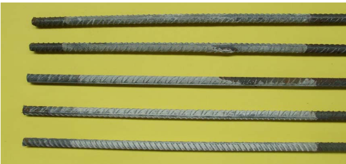
Bild B51: Untersuchungen an vertikal angeordneter Bewehrung in kleinen Aussparungen, Fehlstellen im Verbundbereich infolge unzureichender Verdichtung im Verfüllkanal, Betonstabstahl B500 B, Bewehrungsdurchmesser d_s = 14 mm
