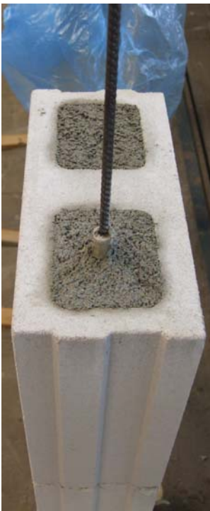
Bild 19: Prüfkörper und Prüfeinrichtung zur Bestimmung des Verbundverhaltens von vertikaler Bewehrung in Formsteinen mit kleinen Aussparungen
