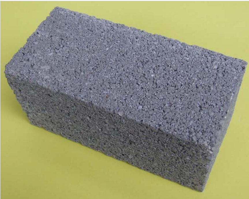
Bild B15: Leichtbetonstein V 4-1,0 2DF (l/b/h 240/115/113 mm)
