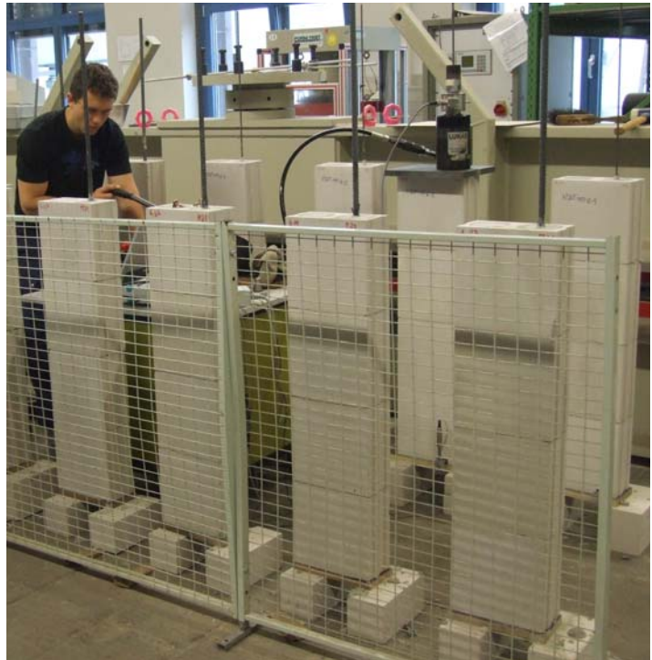
Bild 19: Prüfkörper und Prüfeinrichtung zur Bestimmung des Verbundverhaltens von vertikaler Bewehrung in Formsteinen mit kleinen Aussparungen
