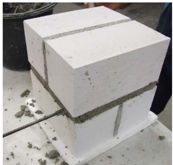
Bild B35: Untersuchungen an horizontal angeordneter Bewehrung in der Lagerfuge, Mauerwerkprüfkörper aus Leichtbeton- (links) und Porenbetonsteinen (rechts)
