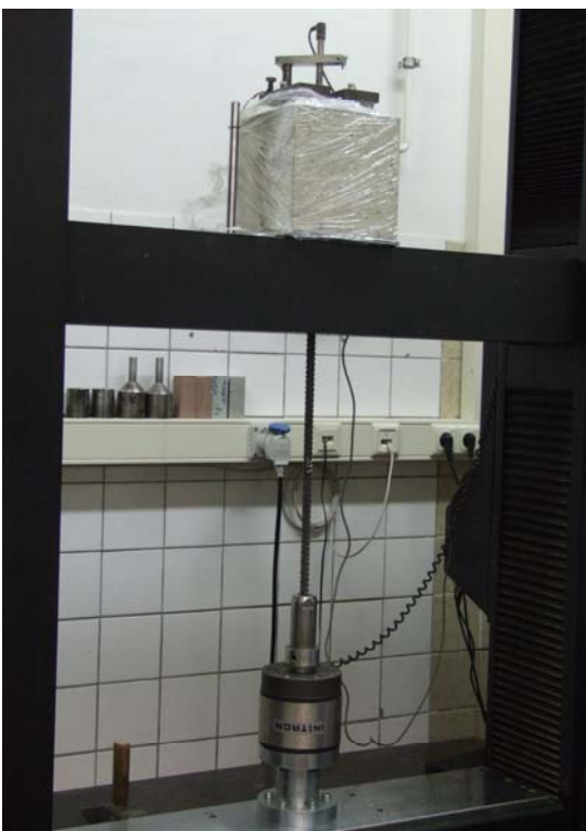
Bild 15: Ausziehversuche an Würfeln nach /X12/; Prüfkörper und Prüfeinrichtung
