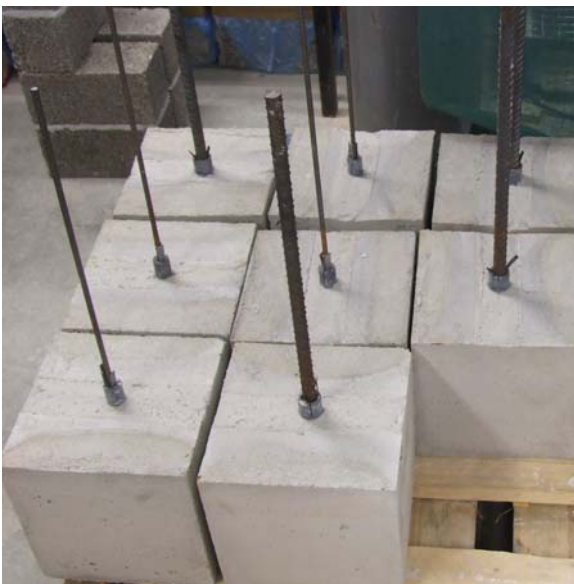
Bild B22: Untersuchungen zum Verbund zwischen Bewehrung und Mörtel bzw. Beton nach /X12/, Herstellung der Prüfkörper
