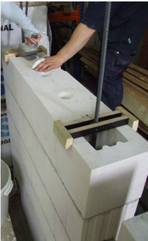
Bild 59: Untersuchungen an vertikal angeordneter Bewehrung in großen Aussparungen, Einfüllen des Mörtels direkt an der Wandoberkante (links) bzw. durch ein 1,25 m langes Aufsatzrohr (rechts)
