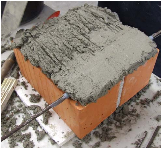
Bild B33: Untersuchungen an horizontal angeordneter Bewehrung in der Lagerfuge, Herstellung des Mauerwerkprüfkörpers aus Hochlochziegeln
