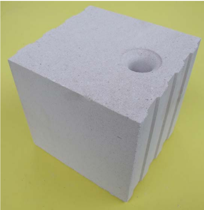
Bild B17: Kalksandstein KS 20-2,0-1,2 8DF (l/b/h 248/240/238 mm)
