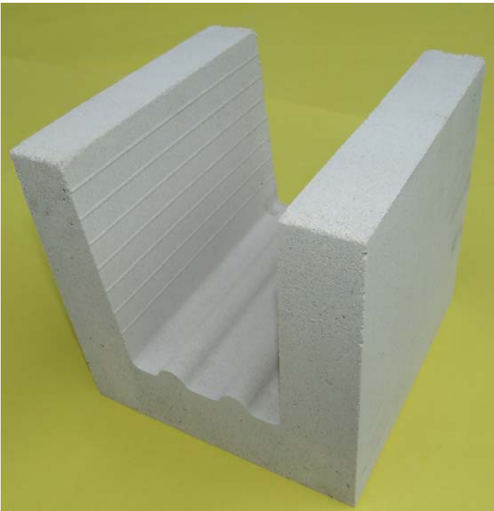
Bild B18: Kalksandstein U-Schale KS-U 20-2,0-1,2-240
