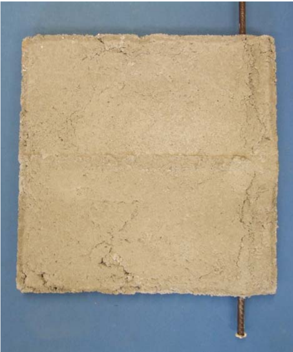
Bild B44: Untersuchungen an horizontal angeordneter Bewehrung in der Lagerfuge, Mörtel aus der Lagerfuge mit Ausbildung von Längsrissen entlang des Stabes
