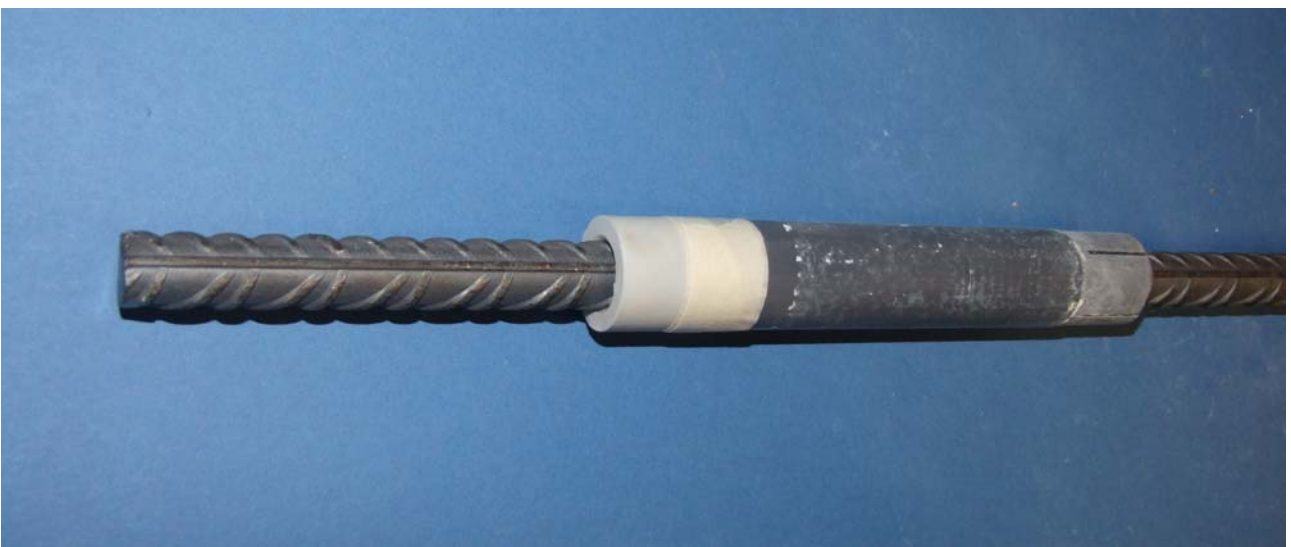
Bild B21: Bewehrung mit Kunststoffrohrumhüllung für Ausziehversuche nach RILEM /X12/
