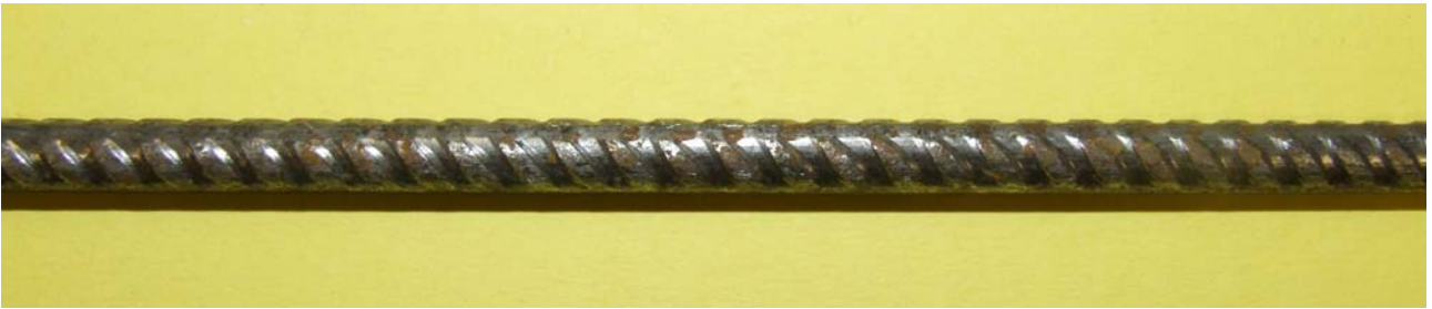
Bild B19: Betonstahl in Ringen B500 A mit drei Rippenreihen, d_s = 6 mm
