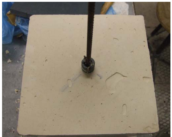
Bild B22: Untersuchungen zum Verbund zwischen Bewehrung und Mörtel bzw. Beton nach /X12/, Herstellung der Prüfkörper
