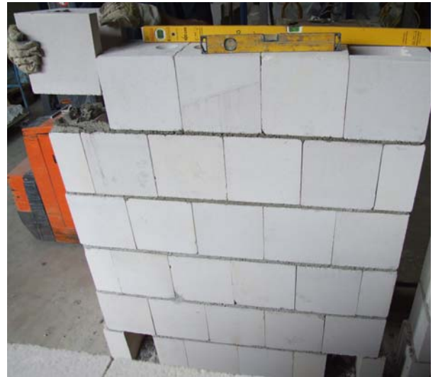
Bild B58: Untersuchungen an vertikal angeordneter Bewehrung in großen Aussparungen, Herstellung der Prüfwände mit gegenläufiger Anordnung der U-Schalen
