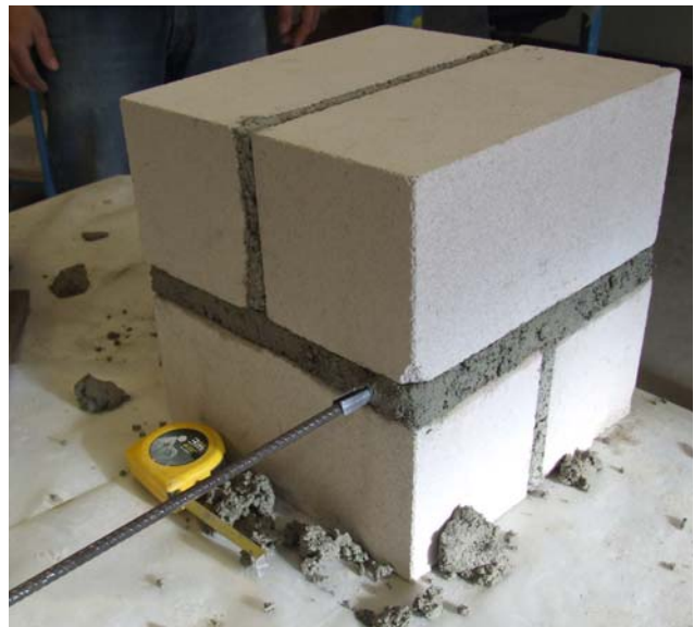
Bild B34: Untersuchungen an horizontal angeordneter Bewehrung in der Lagerfuge, Herstellung des Mauerwerkprüfkörpers aus Kalksandsteinen
