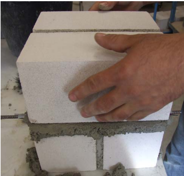
Bild B34: Untersuchungen an horizontal angeordneter Bewehrung in der Lagerfuge, Herstellung des Mauerwerkprüfkörpers aus Kalksandsteinen
