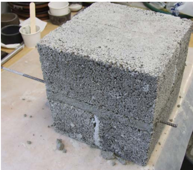
Bild B35: Untersuchungen an horizontal angeordneter Bewehrung in der Lagerfuge, Mauerwerkprüfkörper aus Leichtbeton- (links) und Porenbetonsteinen (rechts)
