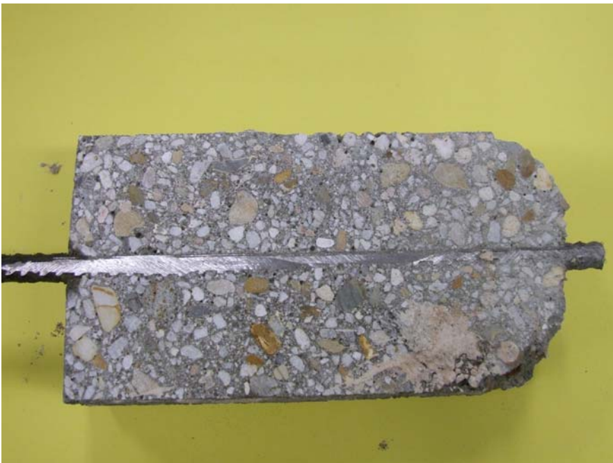
Bild B68: Untersuchungen an vertikal angeordneter Bewehrung in großen Aussparungen, Verbundbereich zwischen Beton C25/30 und Bewehrung, Bewehrungsdurchmesser d_s = 14 mm
