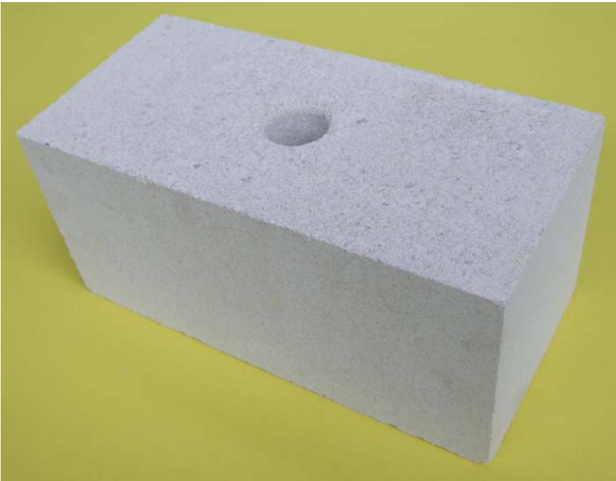
Bild B11: Kalksandstein KS 20-2,0 2DF (l/b/h 240/115/113 mm)
