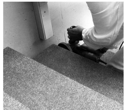
Abb. 2: Beispiel einer Probeentnahme an einer Außentreppe durch Herausschneiden
