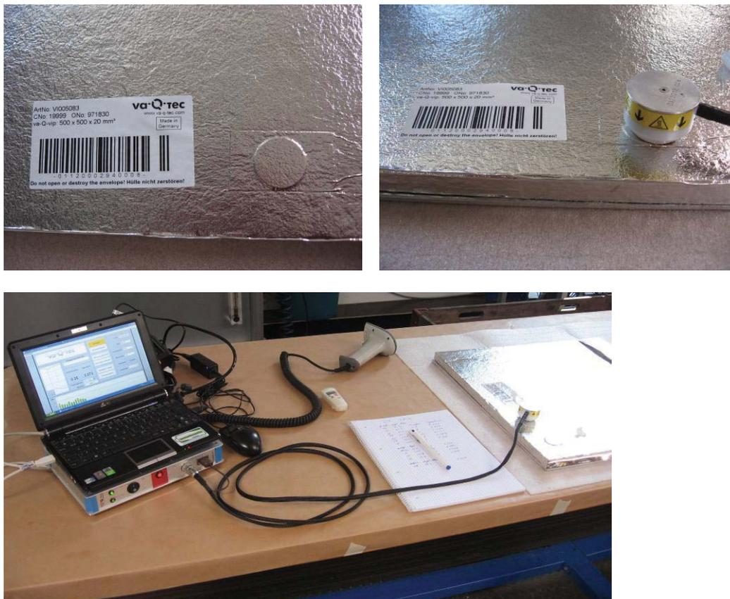
**Abbildung 8** Gasinnendruckmessung mit dem va-Q-check-Verfahren:
