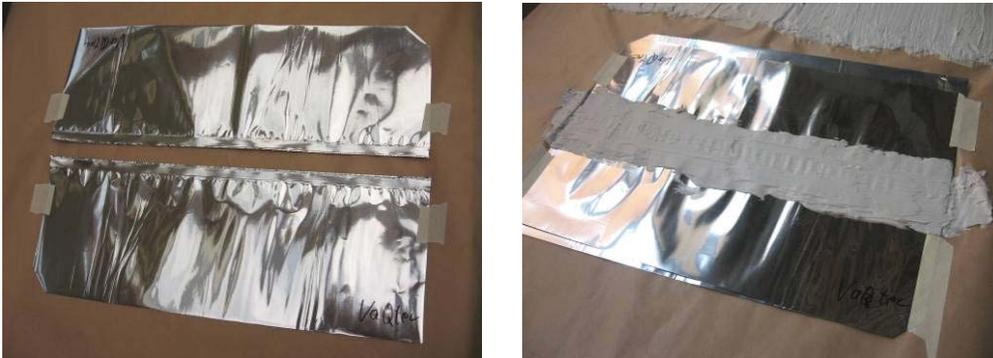
**Abbildung 5** 50 cm lange Siegelnähte unbeschichtet und beschichtet
