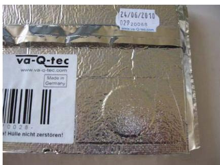
Abbildung 3 va-Q-check-Sensor
