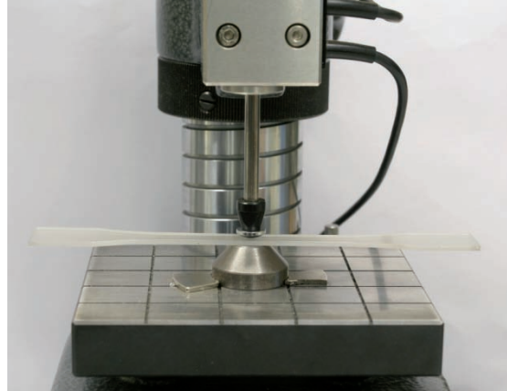
Abbildung 4-3: links: Stanze zur Stanzung der Probekörper, rechts: Dickenmessung an einem Probekörper
