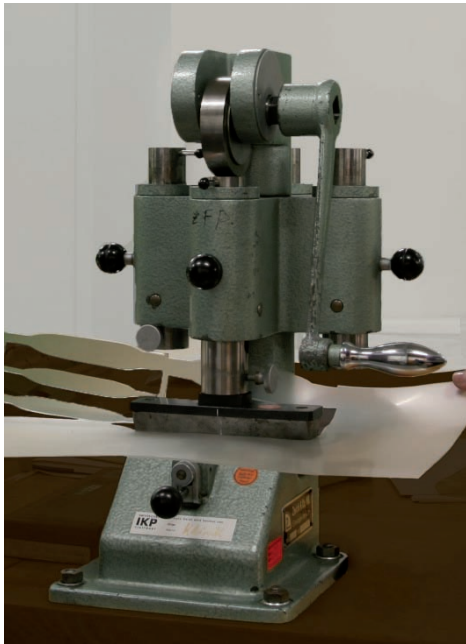
Abbildung 4-3: links: Stanze zur Stanzung der Probekörper, rechts: Dickenmessung an einem Probekörper
