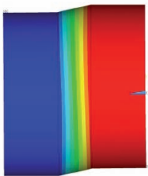
Abbildung 4-16: Verformungsbild eines Scherprobekörpers mit vergrößerter Zwischenschichtdicke ( t_{SG} = 6 \text{ mm} ), E = 560 \text{ N/mm}^2 , \mu = 0,458 , aufgebrachte Verformung = 1 mm
