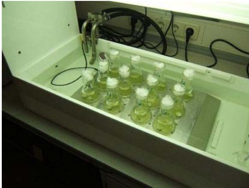
Bild 1: Lichtbank mit temperierbarem Wasserbad für die Anzucht von Algen
