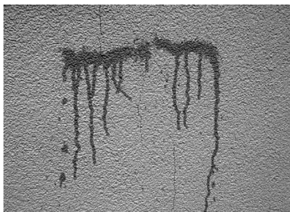
Abb. 5: Überprüfung der kapillaren Wasseraufnahme durch eine Benetzungsprobe
