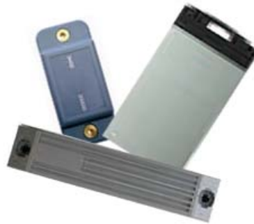
Abbildung 15: Aktive und passive RFID-Tags (Quelle www.gaorfid.com)
