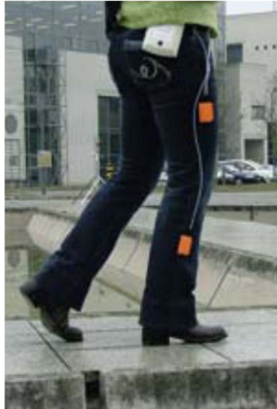
Abbildung 10: Trägheitssensoren [Renaudin, Yalak, Tome, & Merninod, 2007]
