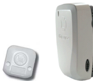
Abbildung 22: Ubisense Tag und Sensor [Becker, 2008]
