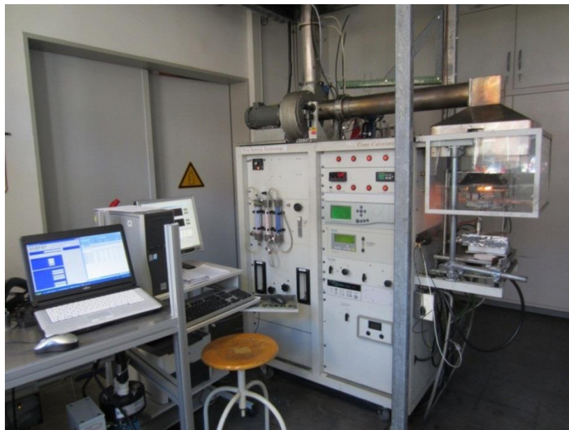
Abbildung 7: Cone Calorimeter der BAM (bestehend aus konischem Heizelement, Abbrandwaage, Rauchabzugssystem und Analyseeinheit)
