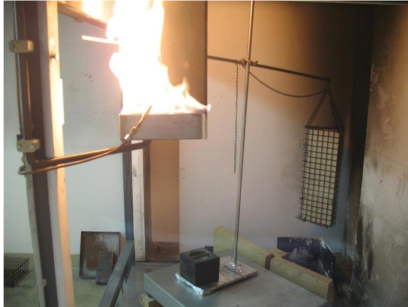
Abbildung 10: Versuchsaufbau im Single Burning Item Test und Modifizierung
