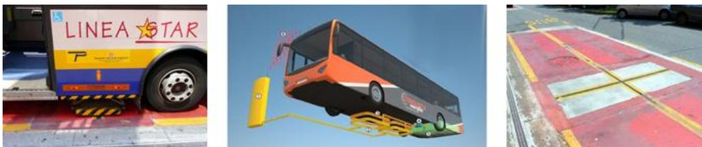
Abb. 106 Linienbusse in Turin, die induktiv mit Strom versorgt werden. Die mittlere Abbildung zeigt das Schema der Induktion, bestehend aus zwei Spulen. Quelle: Conductix-Wampfler
