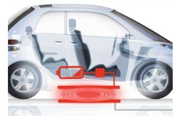
Abb. 104 Funktionsschema der beiden Spulen, zwischen denen sich ein Magnetfeld aufbaut; Quelle: SEW eurodrive
