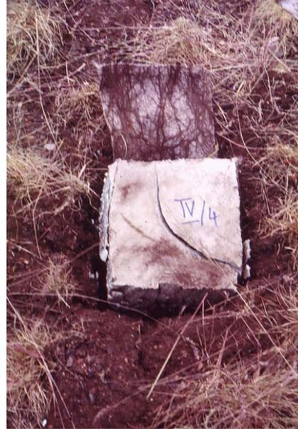
Bild 4: Fotografische Aufnahmen von Dach 4 bei der Entnahme der extrudierten Polystyrol-Hartschaumstoffe (Hersteller A und B) für die Messung der Feuchtegehalte.
