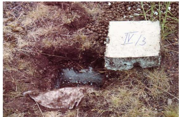
Bild 3: Fotografische Aufnahmen von Dach 3 bei der Entnahme der extrudierten Polystyrol-Hartschaumstoffe (Hersteller A und B) für die Messung der Feuchtegehalte.
