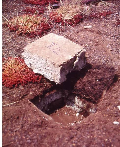
Bild 2: Fotografische Aufnahmen von Dach 2 bei der Entnahme der extrudierten Polystyrol-Hartschaumstoffe (Hersteller A und B) für die Messung der Feuchtegehalte.
