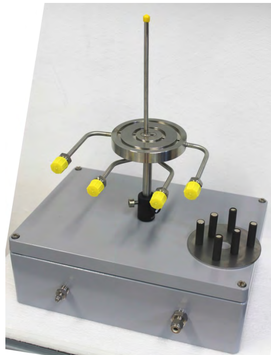
Abbildung 38: Messadapter für die Siegelnahtprüfung
