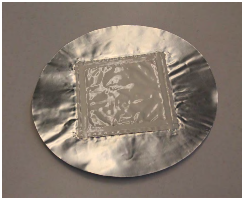
Abbildung 34: Probe mit auflaminierten Strukturen zeigt Welligkeit durch Verzug
