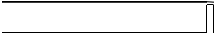
Abbildung 8: Randausbildung "überlappend Rand" - Alternative Ausbildung zu "Überlappend Mitte" – wird teilweise noch verwendet bei Paneelen großer Dicke
