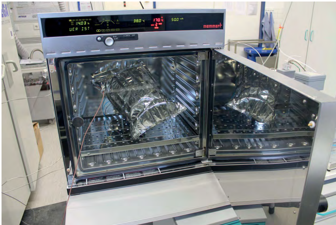
Abbildung 43: Prüfkörper mit Siegelnahtmessadapter in Klimaschrank
