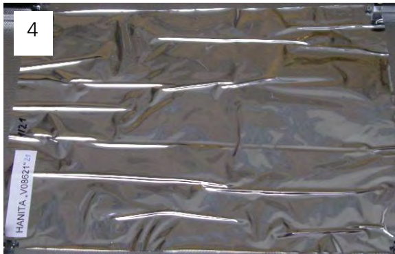
Abbildung 21: Bilder der Hanita VIP V08621 nach den Alterungsstufen 0-5, zunehmende Delamination ab der 3. Alterungsstufe
