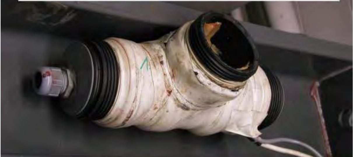
Abb. 3: Prüfzelle mit Anschluss für Heizbänder (Foto: Prüfzelle 1)
