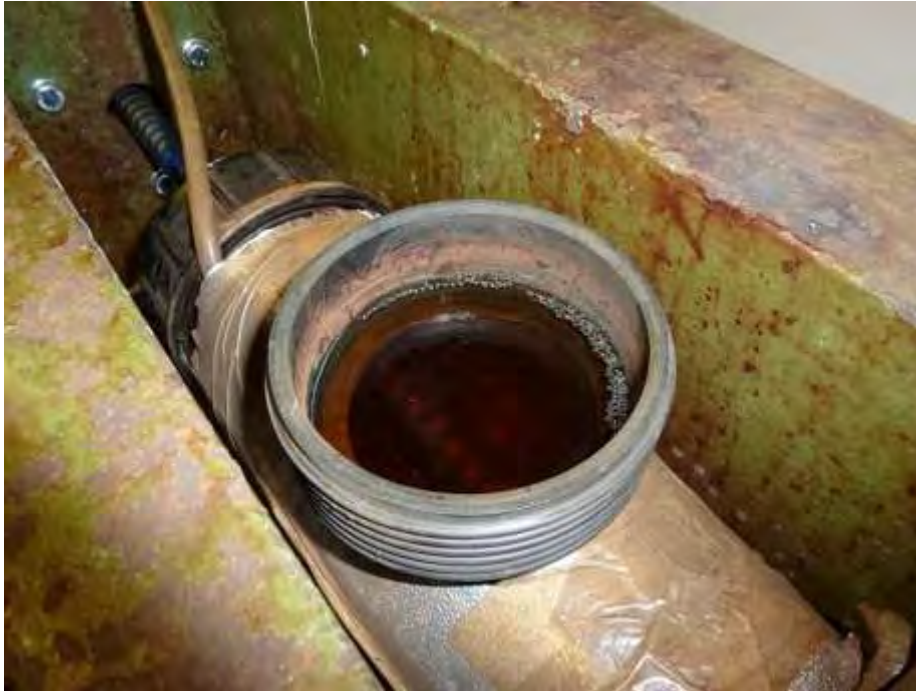
Abb. 12: Innenraum der Prüfzelle nach Einfüllen der Prüflösung
