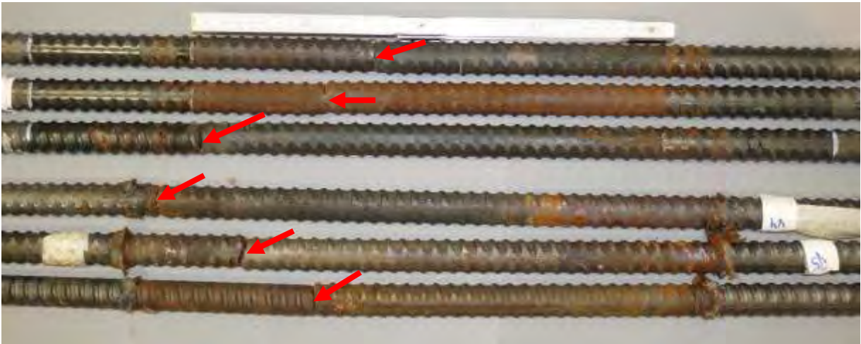
Abb. 7: Proben 1 bis 6 (von oben nach unten) nach der Prüfung, Bruchstelle durch Pfeil gekennzeichnet,
