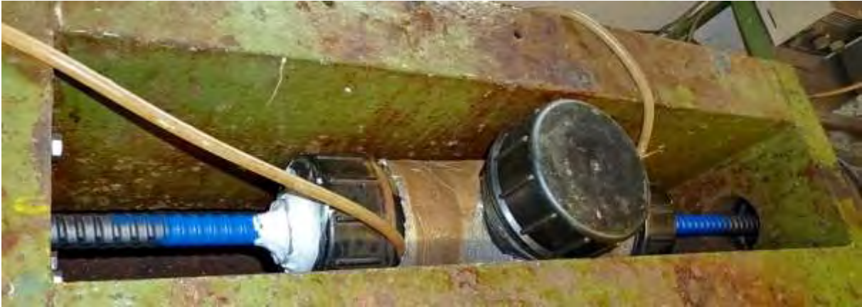
Abb. 10: Prüfzelle im Spannrahmen mit Kunststoffschlauch der Heizung
