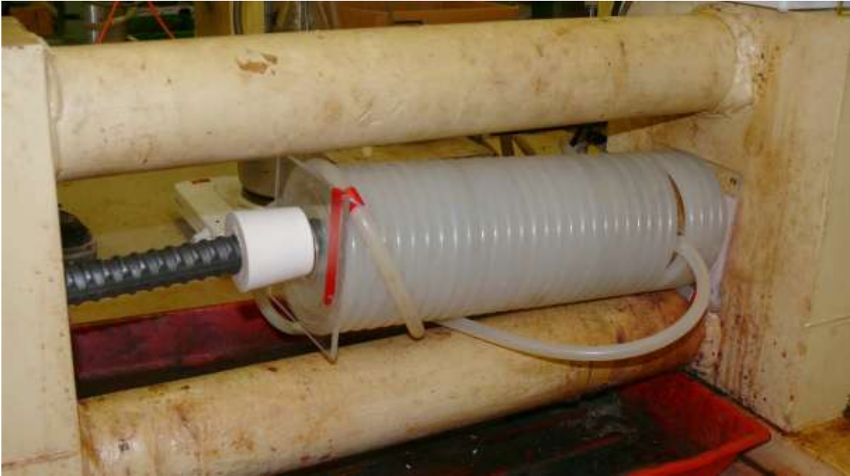
Abb. 14: Prüfzelle im Spannrahmen mit Kunststoffschlauch der Heizung
