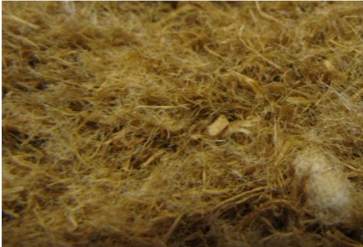
**Abbildung 11: Dämmstoff aus Holzfaser**
