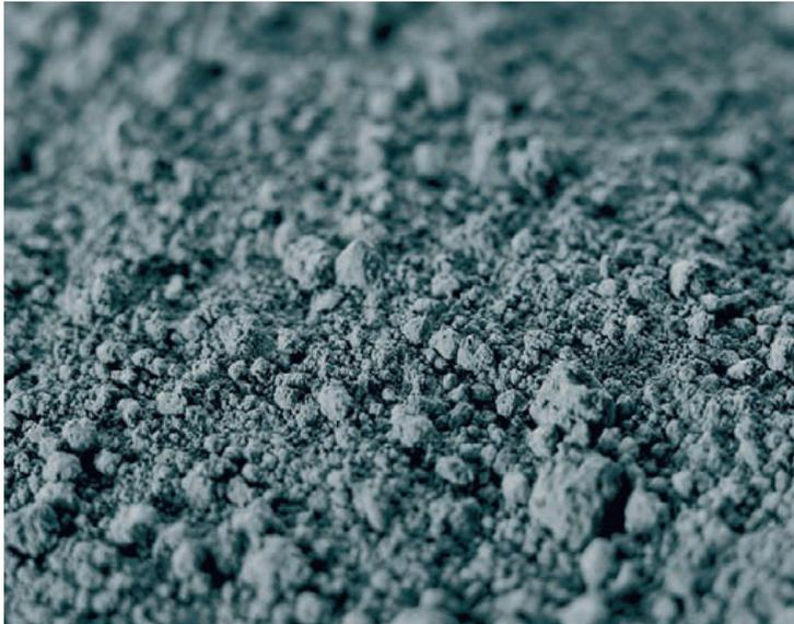
Abbildung 21: Dämmstoff aus pyrogener Kieselsäure
