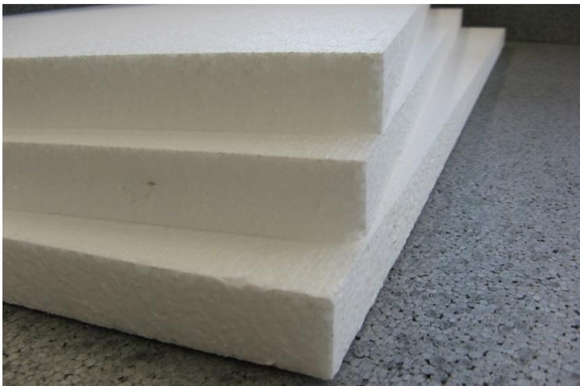
**Abbildung 18: Dämmstoffplatten aus expandiertem Polystyrol (EPS)**
