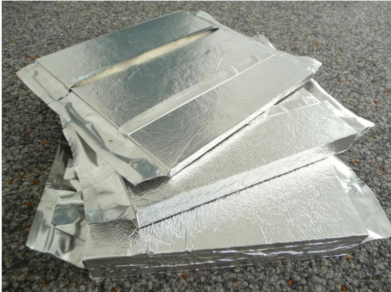
Abbildung 24: Vakuumisolationspaneele (VIP)
