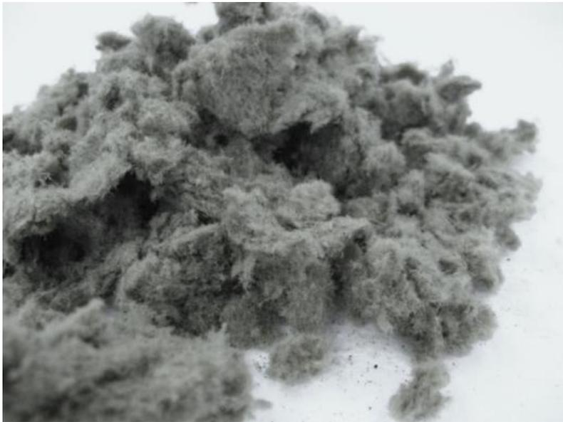
**Abbildung 25: Dämmstoff aus Zellulose**
