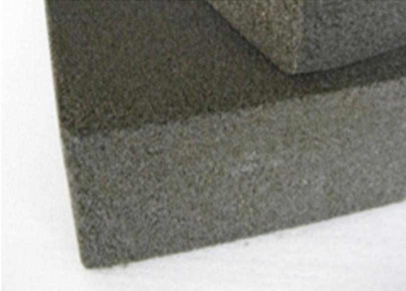
**Abbildung 23: Dämmstoffplatten aus Schaumglas (CG)**
