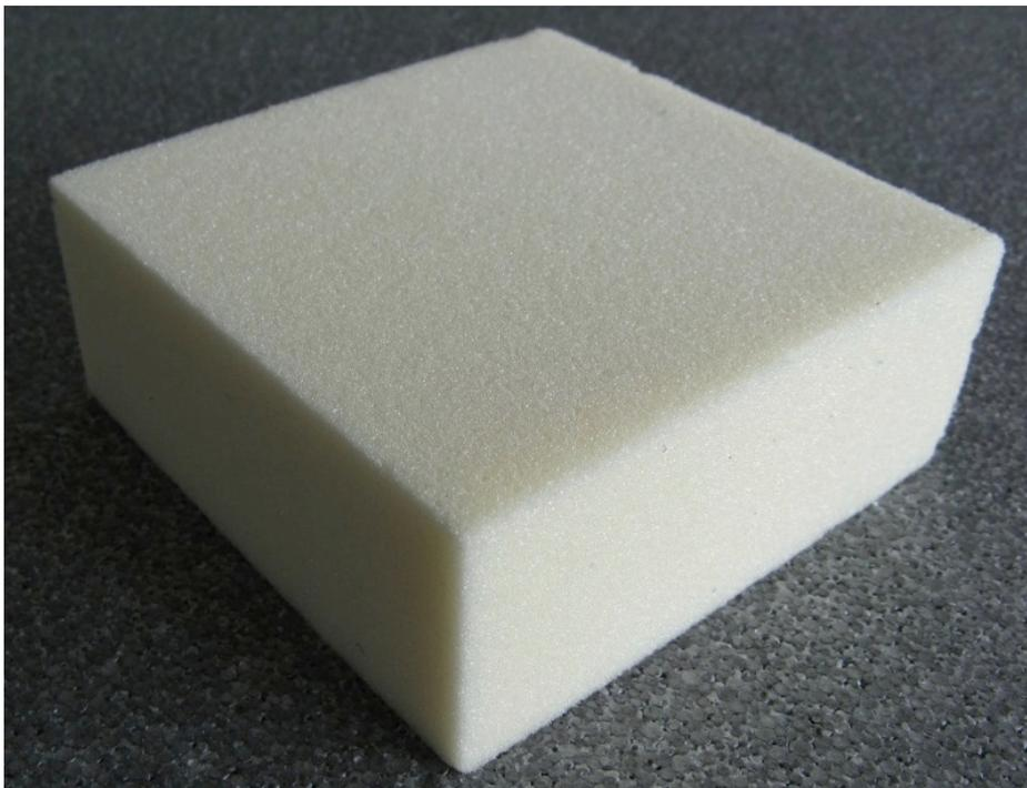
Abbildung 20: Dämmstoff aus Polyurethan (PU)
