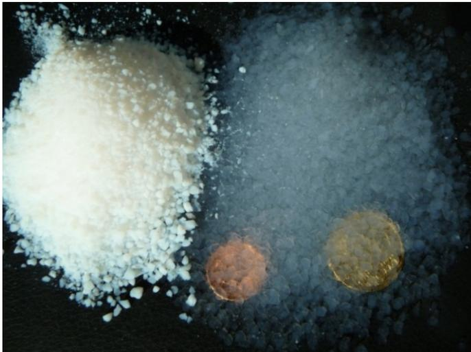
Abbildung 8: Dämmstoff aus Aerogel
