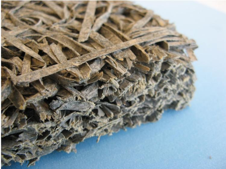
**Abbildung 12: Holzwole-Leichtbauplatte (HWL)**
