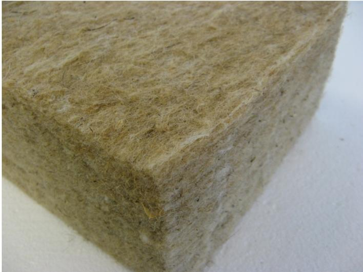
**Abbildung 10: Dämmstoff aus Hanffasern**
