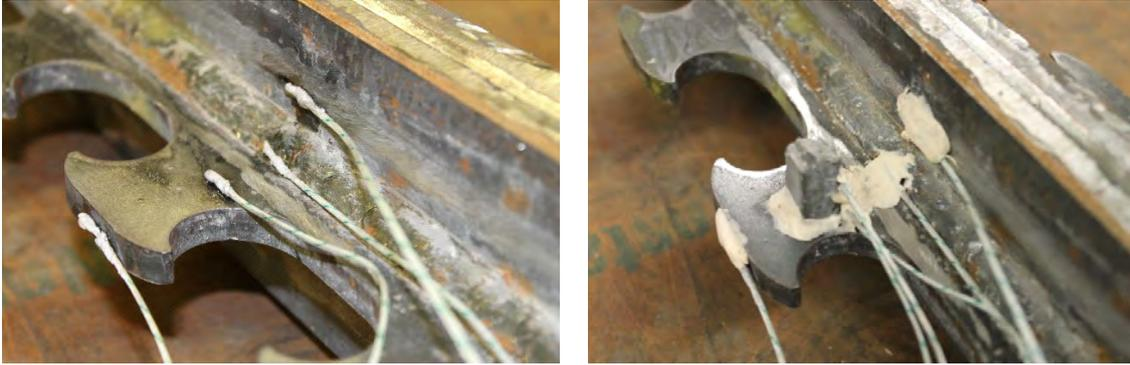
**Abbildung 4.56: Fotodokumentation – Einbau der Messtechnik**
