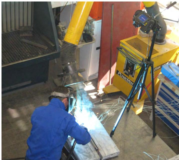
Abbildung 4.60: Versuchsdurchführung mit Thermographie und Thermoelementen
