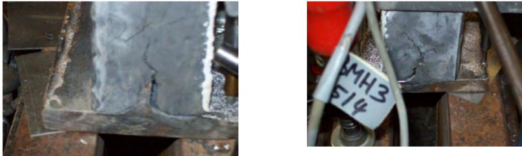
Abbildung 5.34: Rissbildung auf der linken und der rechten Seite des Versuchskörpers 3-1r im zweiten Versuch
