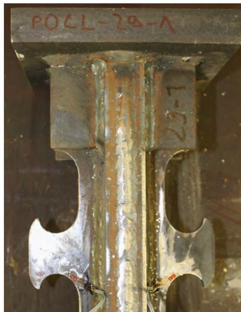
Abbildung 4.17: Lage der DMS zur Messung der Dehnungen während des zyklischen Versuchs am POCL-29-1
