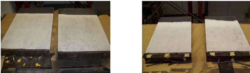
Abbildung 5.21: Versuchskörper mit Muster für die optische Messung: 3-1r, 3-1l, 2-2r und 2-2l (von links nach rechts)
