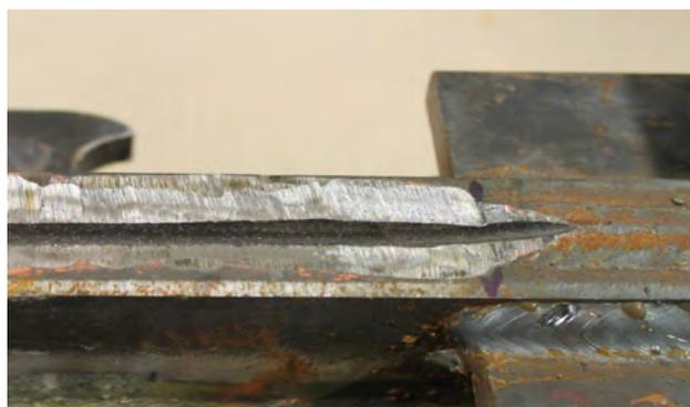
Abbildung 4.55: Schweißnahtvorbereitung
