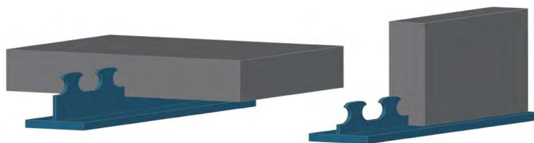
**Abbildung 4.1:** Verbunddübelleisten in Platten (links) und in Scheiben (rechts)
