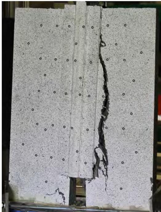
Abbildung 4.25: Versagensform bei Versuchskörpern mit Randeinfassung - Schubversagen
