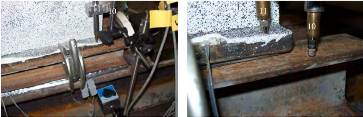
Abbildung 5.27: Wegaufnehmer 11 und Wegaufnehmer 10 auf der Vorderseite des Versuchskörpers
