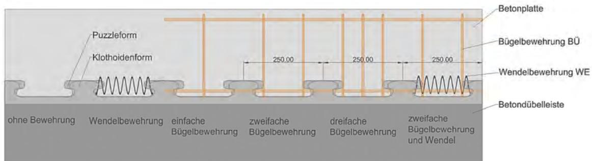
Abbildung 2.25: Darstellung der untersuchten Betondübel [28]
