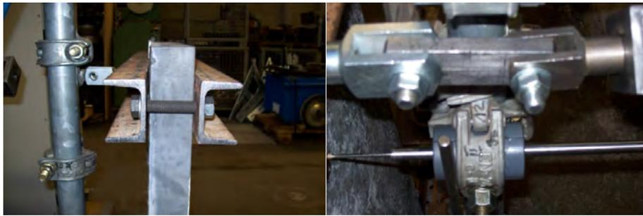
Abbildung 5.25: Stahlkonstruktion zur Lastübertragung von Zylinder auf Prüfkörper (links) und Gelenk zwischen Stahlkonstruktion und Zylinder (rechts)
