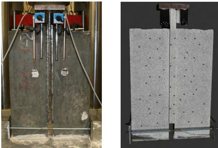
**Abbildung 4.6:** Vorbereitung der Versuchskörper mit konventioneller Messtechnik (links) und für das optische Messsystem (rechts)
