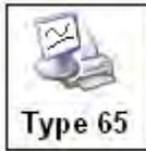
Die verschiedenen Variablen werden über diesen Type angezeigt. Das ist sehr hilfreich, denn damit bietet sich die Möglichkeit, während einer Simulation zu sehen, wie die Ergebnisse bis zum aktuellen Zeitschritt aussehen. Die dargestellten Variablen werden für weitere Analysen in einer separaten Datei gespeichert.
