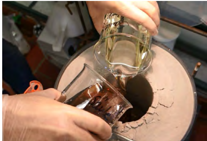
Abbildung 12: Zeitgleiches Eingießen der Komponenten in die Hohlform
