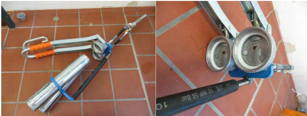
Abbildung 9: Aufgeschraubte Kartuschenpumpe (rechts Detailansicht)
