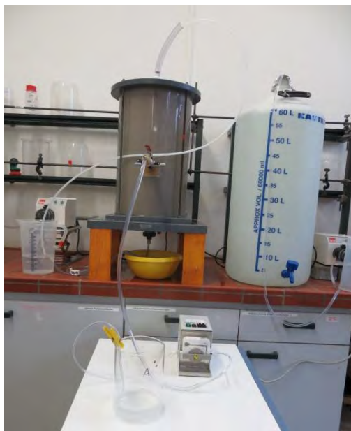
Abbildung 16: Injektion mit Peristaltikpumpe
