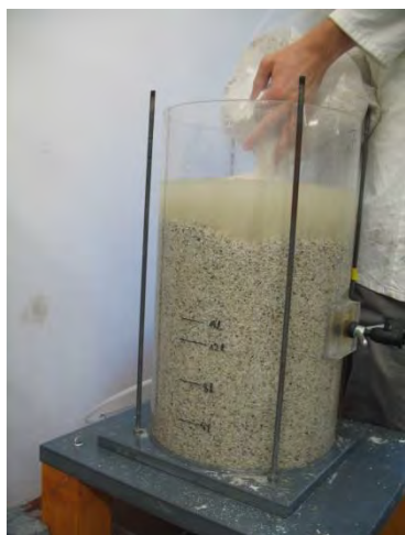
Abbildung 7: Trübung beim Einschlämmen des Grobsandes
