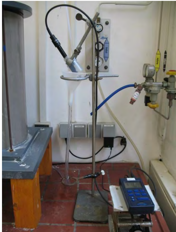
Abbildung 17: Durchflusszelle zur kontinuierlichen Bestimmung der elektrischen Leitfähigkeit
