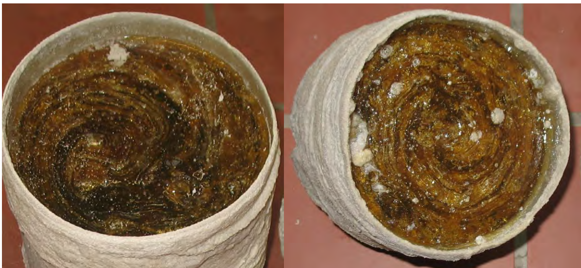
Abbildung 37: PU-Prüfkörper mit Schlieren
