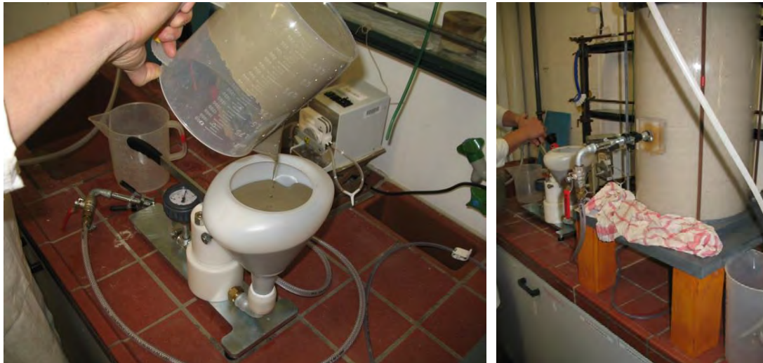
Abbildung 8: Befüllen des Materialtrichters mit Zementleim und Zementleim-Injektion
