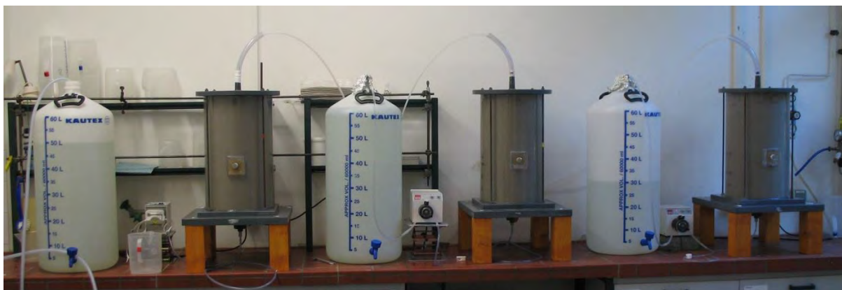
Abbildung 2: Säulenanlage mit Vorratsbehältern
