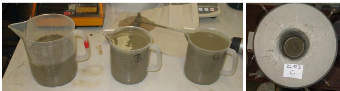
Abbildung 11: Aufteilen auf 1000ml Zementleim je Säule (links) und mit Zementleim befüllte Hohlform im Säulensand (rechts)
