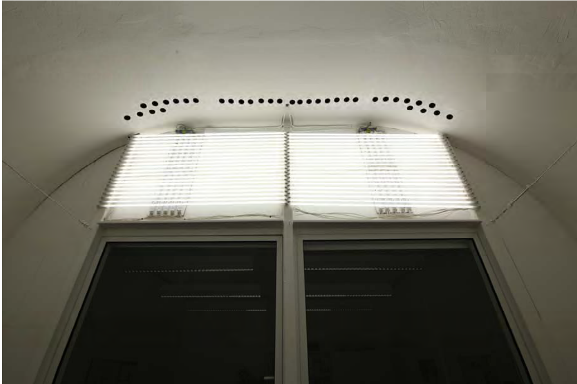
Abbildung 12: künstlicher Himmel mit 40 Leuchtstofflampen vom Typ T5 865 80 W
