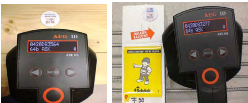
Bild 81: Lesung des LF-ASK-Tag unter dem bedruckten RFID-Etiketts mit dem H5-Reader am Beispiel eines Holzpanels vom Dachmodell (links) und eines Balkon-Isokorbs (rechts).
