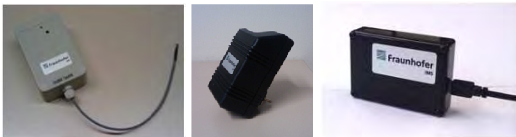
Bild 55 : Beispiele für Sensornetzwerk-Komponenten als Prototyp (Fraunhofer IMS): Sensortransponder für Temperatur, Feuchte, Licht mit externem Sensor am Kabel (links), PLC-Gateway (Mitte) und Basisstation zum Datenempfang (rechts).
