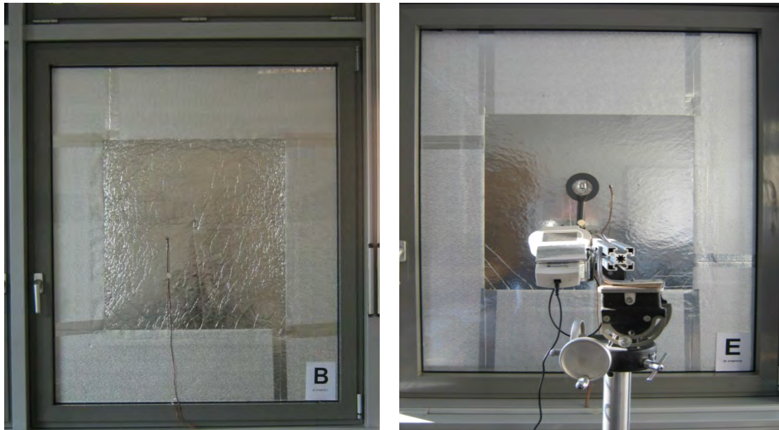
Bild 39: Testfassade mit VIP-Paneel B (links) und Lesegerät auf Stativ vor dem VIP-Paneel E (rechts).
