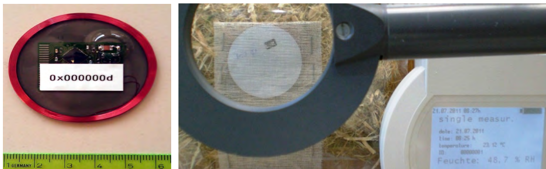
Bild 49: Ansicht des IMS-LF-Feuchte-Tags (links) und als Prototyp (grau, rechts) in Handfammung.
