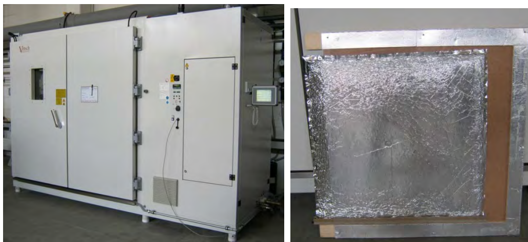
Bild 36: Klimakammer (links) zum Test des Vakuumdämmpaneels in einer Rahmenkonstruktion zum Schutz gegen Beschädigung (rechts).
