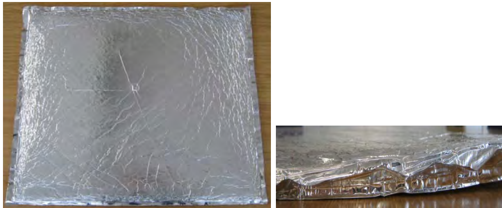
Bild 35: VIP mit RFID-Drucksensor-Transponder in der Paneelmitte (links) und Randdetail (rechts).
