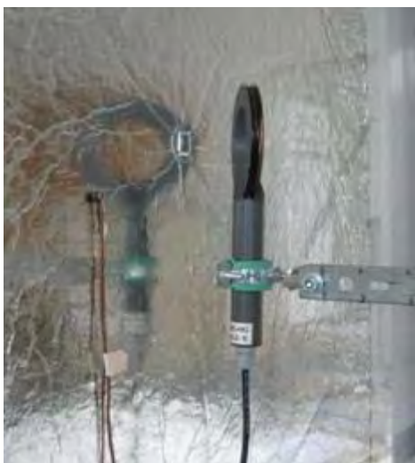
Bild 44: Testanordnung zur Bestimmung des Einflusses der Antennenhalterung
