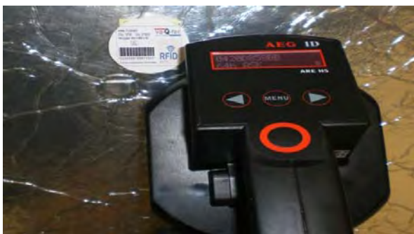
Bild 80: Lesung des LF-ASK-Tag unter dem bedruckten RFID-Etiketts neben dem VIP-Drucksensor.
