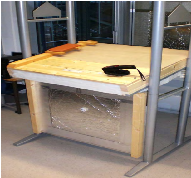
Bild 66: RFID-Demonstrator mit Modellinstallationen an Holzdach und VIP-Wand.
