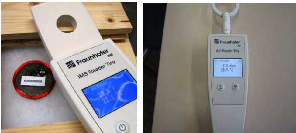
Bild 82: Lesung des LF-Feuchtesensors (links) und des LF-VIP-Drucksensors (rechts) mit dem Tiny-Lesegerät in unterschiedlicher Antennenbauart.
