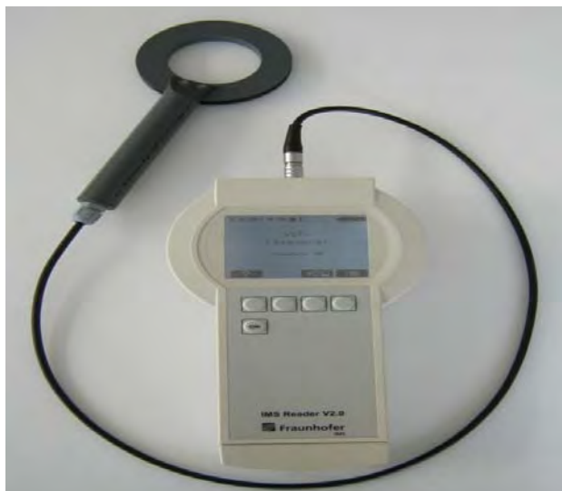
Bild 27 : Prototyp-Lesegerät für IMS-Sensor-Transponder mit externer Antenne
