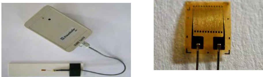
Bild 17: Aktiver RFID-Transponder mit externem DMS-Sensor auf Trägerplatte (links) und DMS-Sensor (Nahaufnahme), nach 11 .
