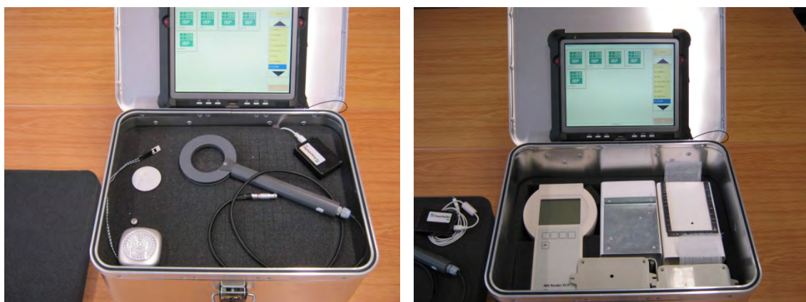
Bild 62: Demonstrator zur Präsentation der RFID-Sensortechnik bei RLT-Anlagen
