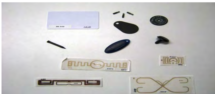
Bild 6: Übersicht passiver RFID-Transponder: oben links in Kartenform (PVC weiß), oben rechts gekapselt in Glasröhrchen, mit Loch zum Anschrauben, als Schlüsselanhänger oder in Nagelform (schwarz). Die 4 aufgedruckten Antennen-Inlays (unten) sind Teile von passiven UHF-Transpondern in Kartenform.
