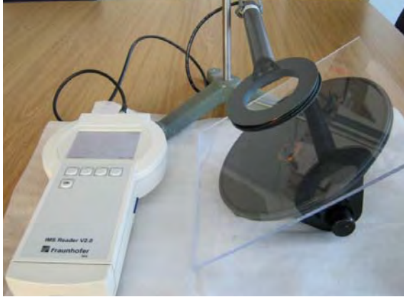
Bild 46: Messaufbau mit Lesegerät, Antenne und Drucksensor zwischen Scheibe und Saugheber.
