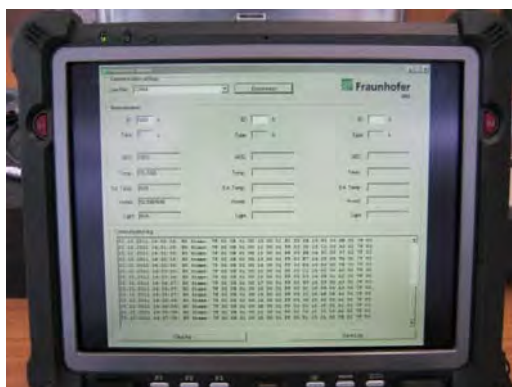
Bild 86: Visualisierung der Daten aus RFID-Feuchtesensoren mit SensornetView
