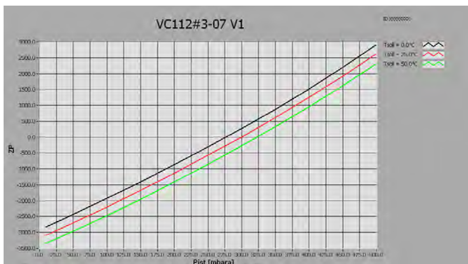
Bild 31: Druckkurven der aktuellen Druck-Sensoren bei drei Temperaturstufen.
