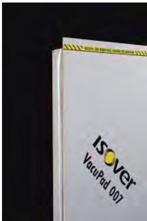
Bild 77: Ansicht des VIP-Paneels „VacuPad“ (links) und Auslese von VIP-Drucksensoren mit dem AEG-Reader durch die GK-Innenbekleidung.
