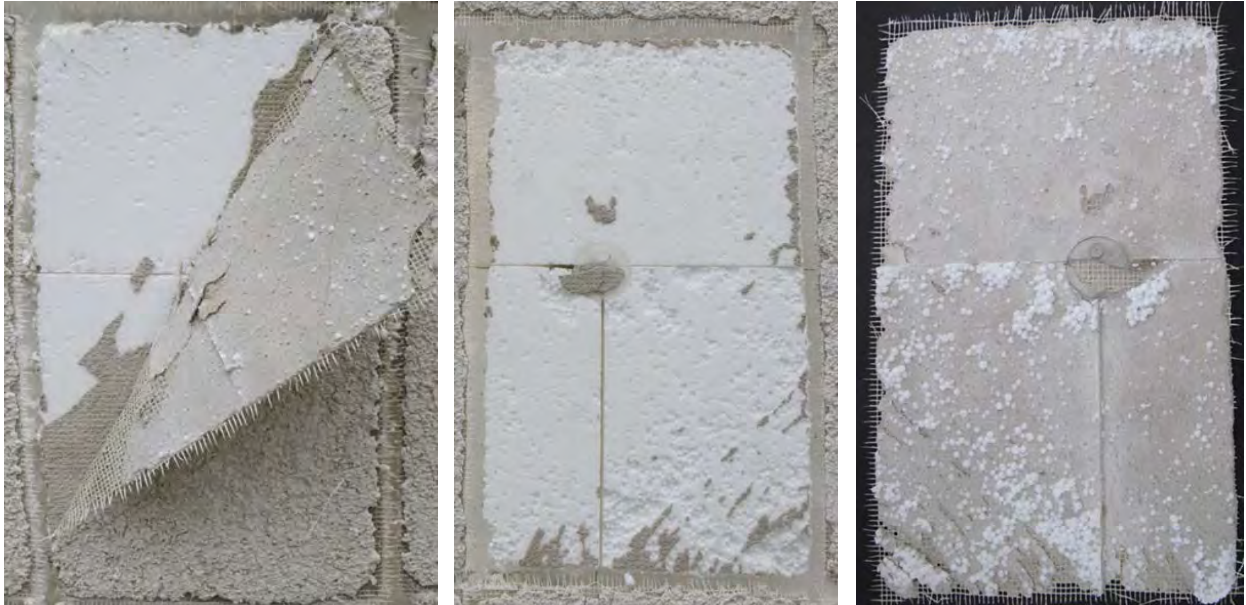
Bild 25: Abschälen der Decklage ohne (links) und mit Berücksichtigung des Schälwinkels und der Schälgeschwindigkeit (Mitte, Hartschaum): Rückseite der Decklage (rechts).
