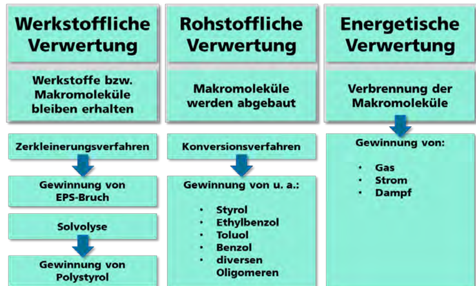
Bild 21: Zusammenfassung der geeigneten Verwertungsverfahren für EPS-Dämmstoff.
