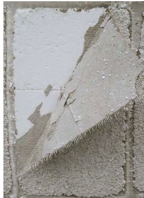
Bild 23: Abschälen der Decklage ohne Berücksichtigung des Abschälwinkels.
