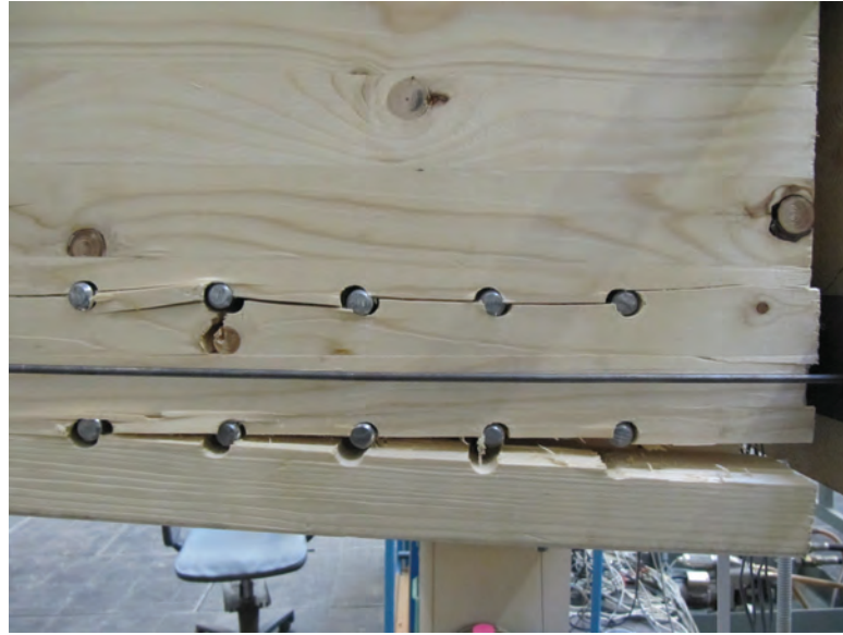
Abb. 4.15: Typisches Versagen bei gestreckten Stabdübelanordnungen
