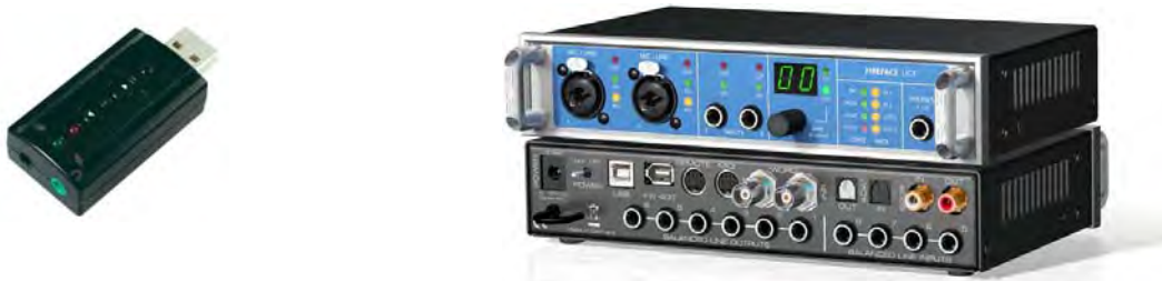
Bild 40: Beispiele für Audio-Interfaces, einfach und hochwertig. Links eine einfaches USB-Interface mit 'Consumer'-Anschluss für ca. 10 Euro. Rechts ein professionelles Audio-Interface höchster Qualität (oben Vorder-, unten Rückseite), das etwa das 100-fache kostet. (Bildquelle rechts: RME).
