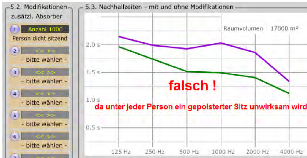
Bild 26: Im Fall des vermessenen Konzertsaales ist eine einfache Berechnung der Wirkung zusätzlicher Personen nicht möglich, da jede Person ein Polster verdeckt und als Absorber unwirksam macht.
