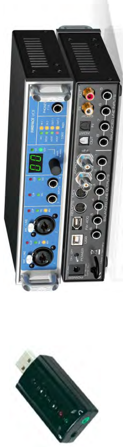
Grafik A.4 Beispiele für Audio-Interfaces, einfach und hochwertig. Links eine einfaches USB-Interface mit 'Consumer'-Anschluß für ca. 10 Euro. Rechts ein professionelles Audio-Interface höchster Qualität (oben Vorder-, unten Rückseite), das etwa das 100-fache kostet. (Bildquelle rechts: RME)
