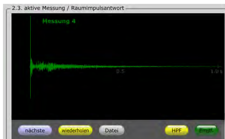
Bild 17: Eine gemessene Raum-Impulsantwort eines Konzertsaals mit etwa 2 Sekunden Nachhallzeit.
