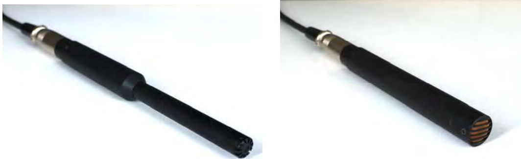
Bild 37: Ein Meßmikrofon (links) und eine Studio-Kondensatormikrofon mit Kugel-Charakteristik (rechts).
