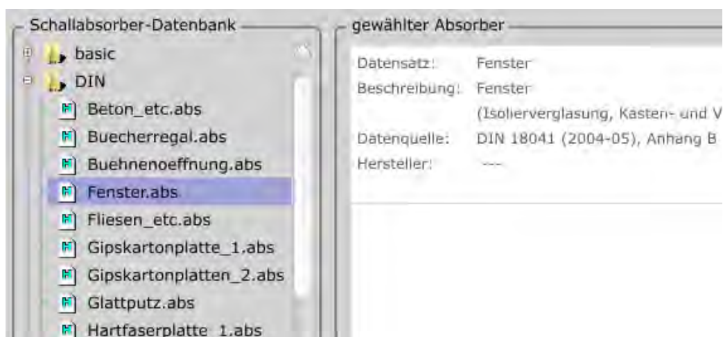
Bild 29: Der Schallabsorber-Browser: links die Baumstruktur, rechts der ausgewählte Absorber.
