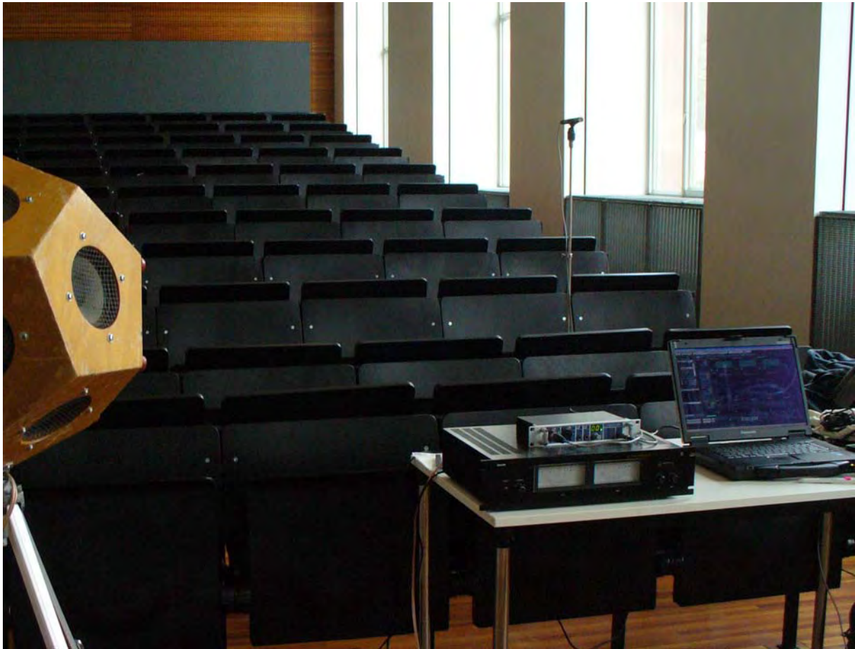
Bild 5: Ein Teil der für den Algorithmenvergleich verwendeten Raumimpulsantworten wurde in Räumen der Universität Wuppertal gemessen. Hier der Messaufbau in einem Hörsaal.
