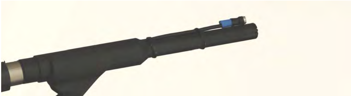
Bild 9: Ein Messmikrofon und eine Elektretmikrofon-Kapsel, für eine Vergleichsmessung übereinander montiert.
