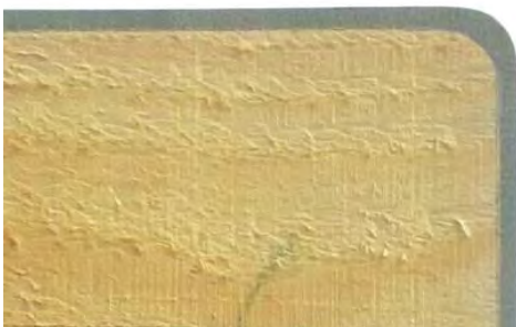
a) ausgerundete Ecke mit gleichmäßiger Schichtdicke
