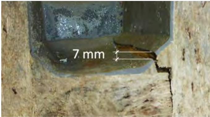
Abbildung 8-33: Riss in der PUR-Beschichtung nach eingprägter Verformung
