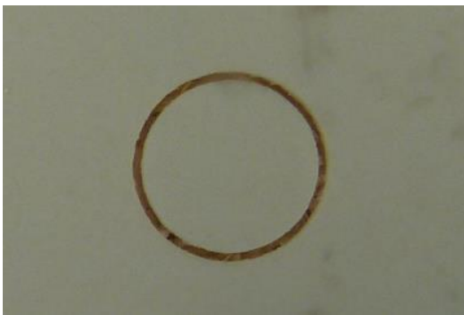
Abbildung 8-18: Ausschnitt vor der Haftzugprüfung (links) und geklebte Prüfstempel an der Probenwand (rechts)
