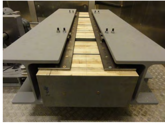
Abbildung 7-17: Aufbau des Ermüdungsversuchs in der Klimakammer
