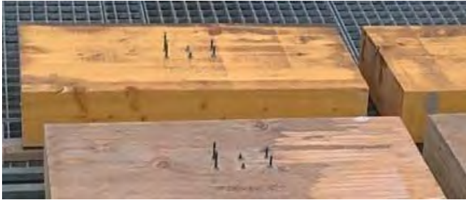
Prüfserie1: direkt bewitterte, unbeschichtete Probe
