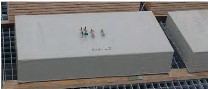
Prüfserie2: direkt bewitterte, beschichtete Probe
