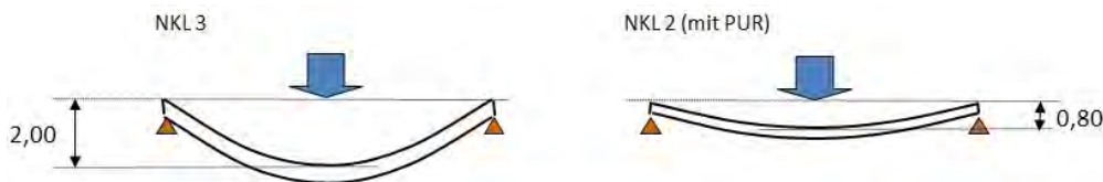
Abbildung 2-5: Beispielkriechverformung für NKL 3 und NKL 2 (mit PUR)
