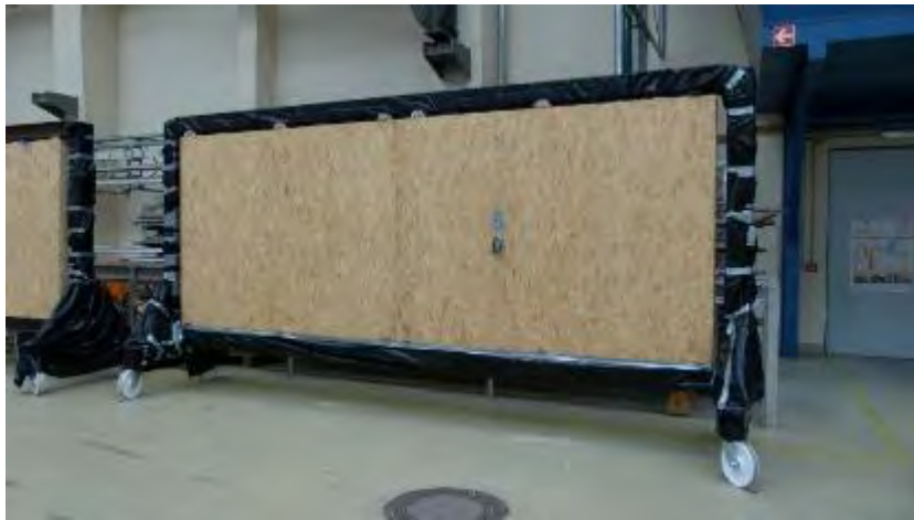
Abbildung 8-2: Trägerrahmen mit Wand und Sensoren vor der Beschichtung
