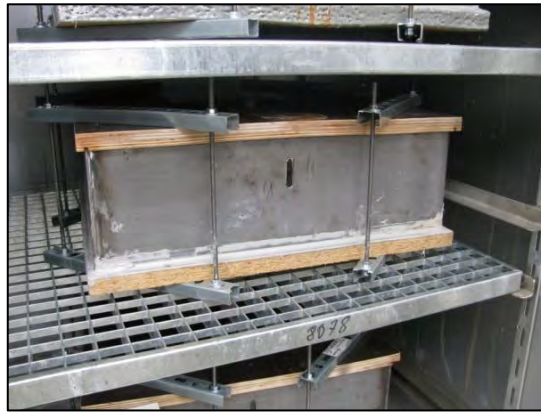
Abbildung 7-2 Probe bei Wasseralterung
