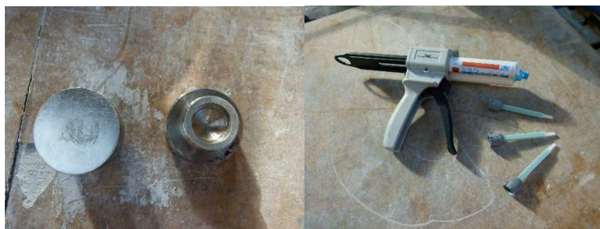
Abbildung 7-5: Prüfstempel 50 mm (links) / Polyurethanhaftzugklebers Quicksolid (rechts)
