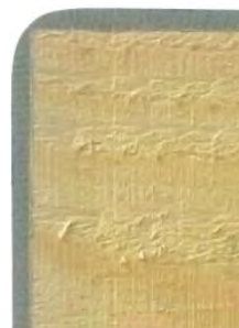
b) zu geringe Beschichtungsstärke an Kanten
