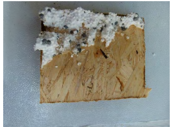
Abbildung 8-31 Ausschnitt harter Stoß mit 1kg
