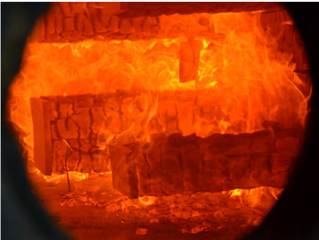
Abbildung 4-11: Blick durch die Brenneröffnung in den Brandraum unmittelbar nach Versuchsende
