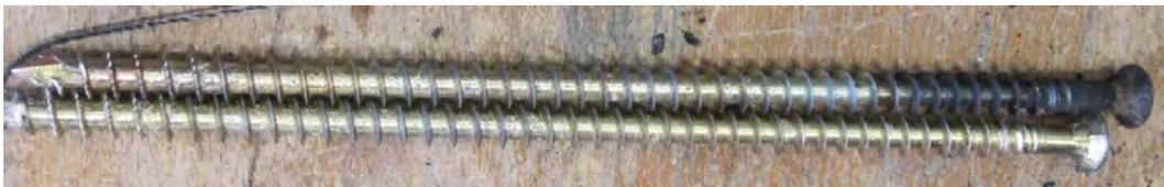
Abbildung 4-29: Verkohlung an der Schraube, die über den Nebenträger eingedreht wurde (Prüfkörper 1, Ø12 mm bei einem Randabstand von 36 mm, 30 Minuten Brandbeanspruchung), die zweite Schraube, die über den Hauptträger eingedreht wurde und am Kopf geschützt war, zeigt keine Verkohlung auf.
