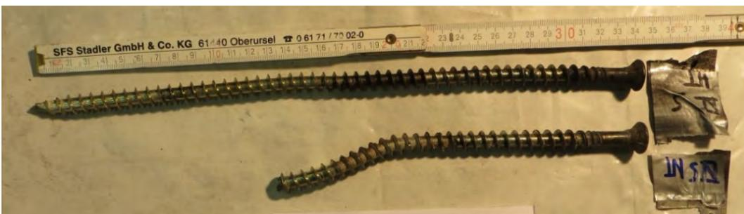
Abbildung 5-35: Verfärbung der Vollgewindeschrauben aus S4 mit ungeschütztem Kopf: Schwarzfärbung nur in ca. 30 mm Tiefe vom Kopf aus vorhanden (Bereich mit  $T > 300^{\circ}\text{C}$ )- Zugschrauben oben, Druckschraube unten
