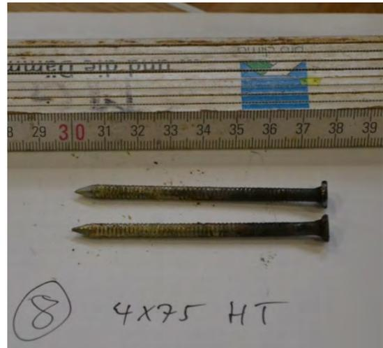
Abbildung 4-23: Prüfkörper 8, Nägel 4 x 75 mm aus dem HT, deutlich erkennbar ist ein unverfärbter Bereich auf ca. 30 mm von der Nagelspitze
