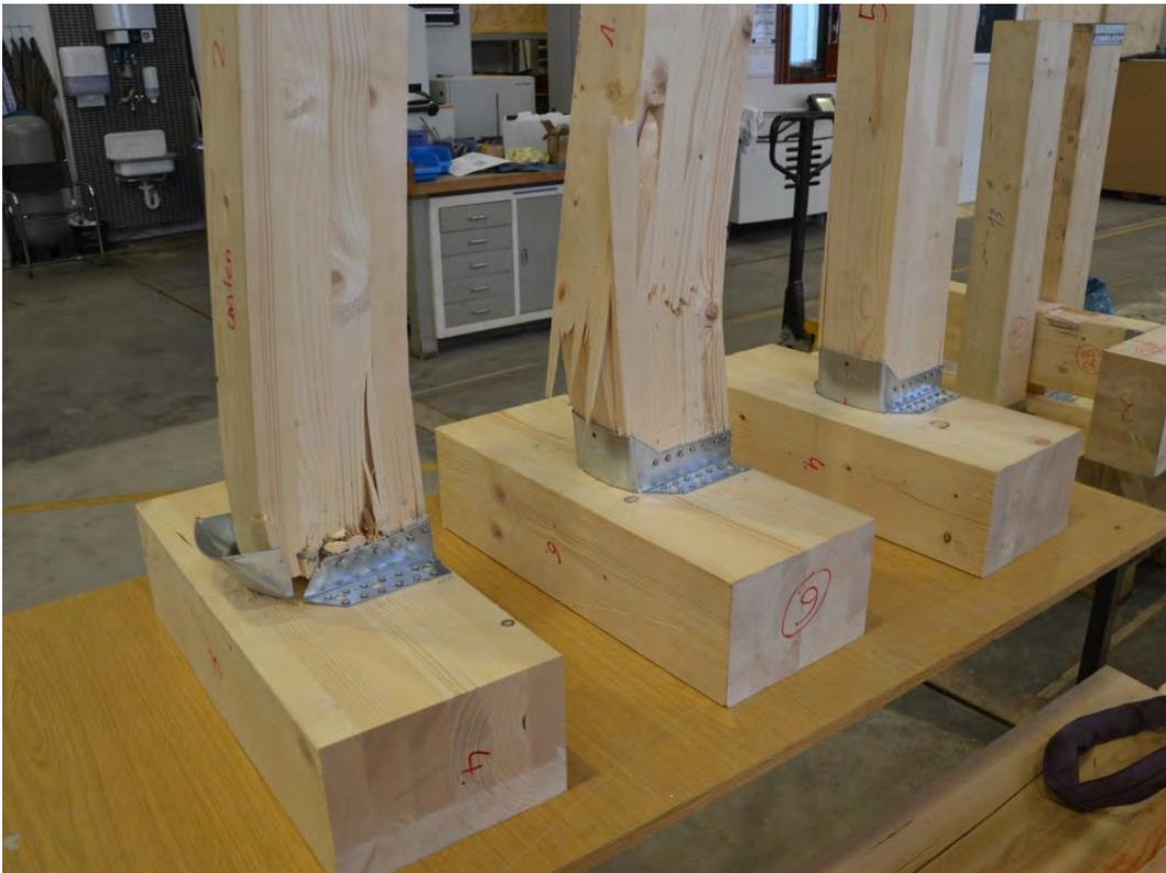
Abbildung 5-10: Versagensbilder von Balkenschuhverbindungen, Serie B1. Bei dem vorderen Prüfkörper ist ein Versagen der Verbindung nach Aufreißen des Bleches zu erkennen, bei dem in Bildmitte erkennbaren Bauteil trat Versagen durch Überschreiten der Biegefestigkeit im Lasteinleitungsbereich auf.
