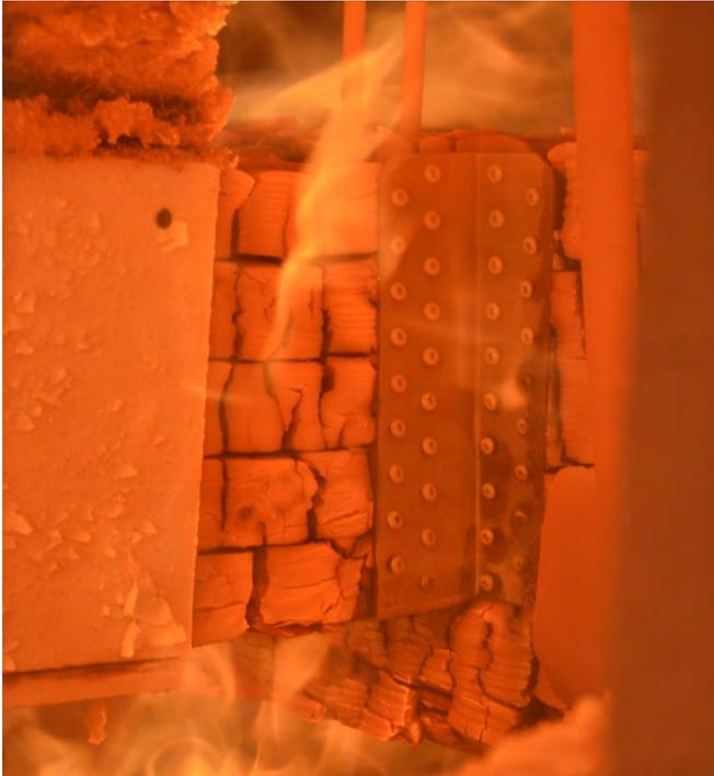
Abbildung 5-23: Ansicht einer Balkenschuhverbindung während des Brandversuchs (Versuchskörper B3a), nach ca. 20 min Brandeinwirkung.
