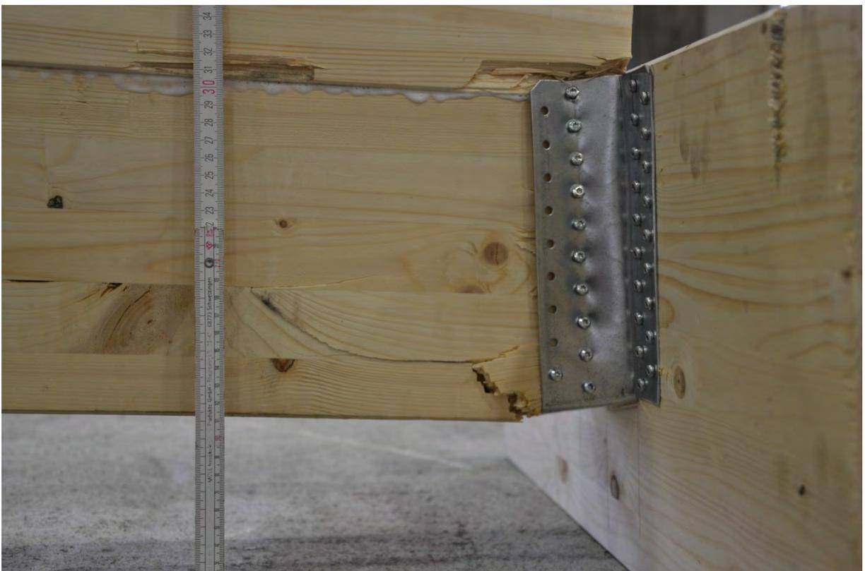
Abbildung 2-4: Exemplarisches Bruchbild der Balkenschuhverbindung aus Abbildung 2-3.
