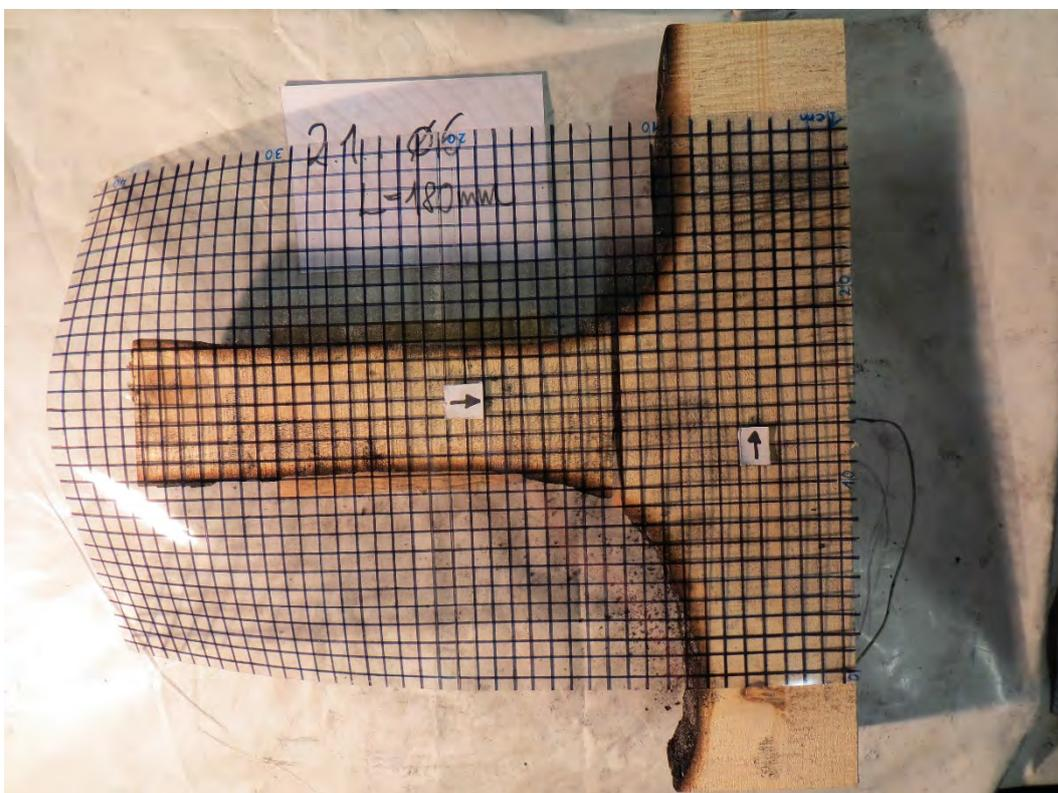
Abbildung 11-112: Versuchskörper S2, unbelastet; Horizontalschnitt
