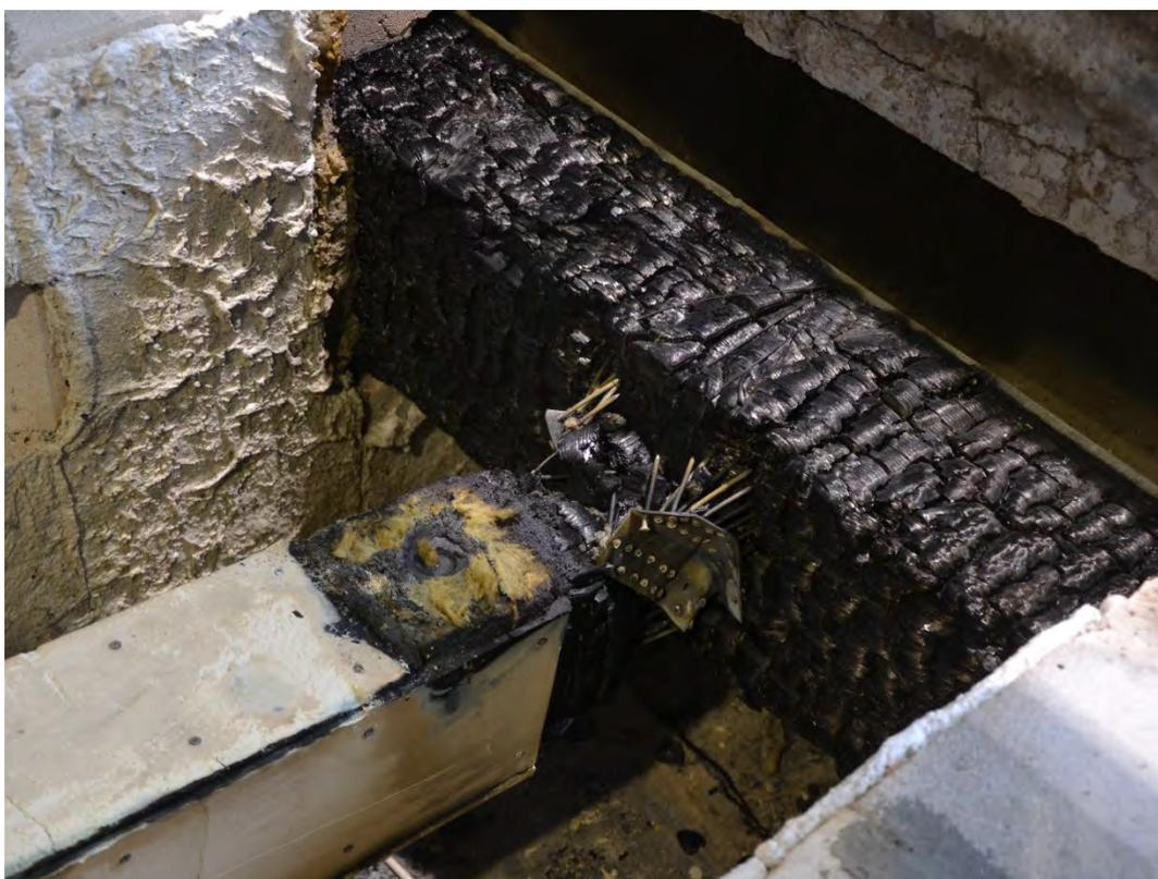
Abbildung 11-93: Versuchskörper B3a nach der Versuchsdurchführung
