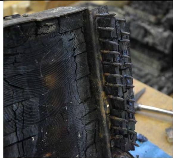
Abbildung 4-17: Versuchskörper 5 Detailansicht der 5 x 50 mm Schrauben
