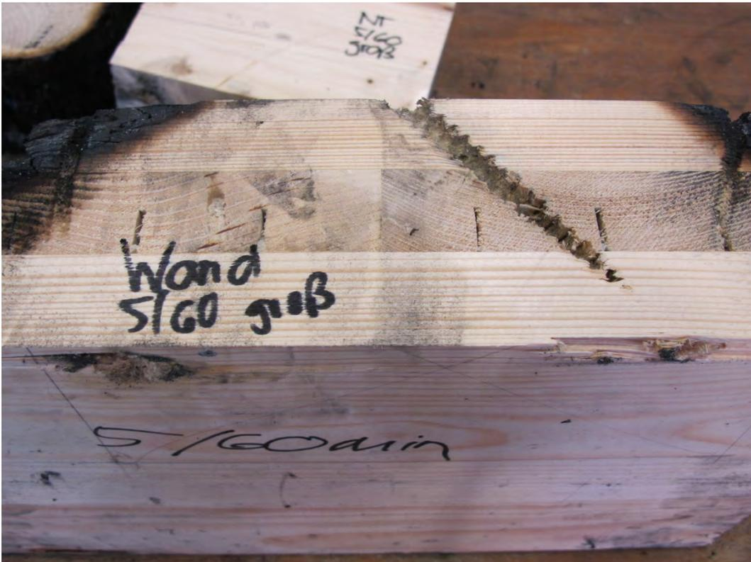
Abbildung 11-69: Schnitt durch den Hauptträger
