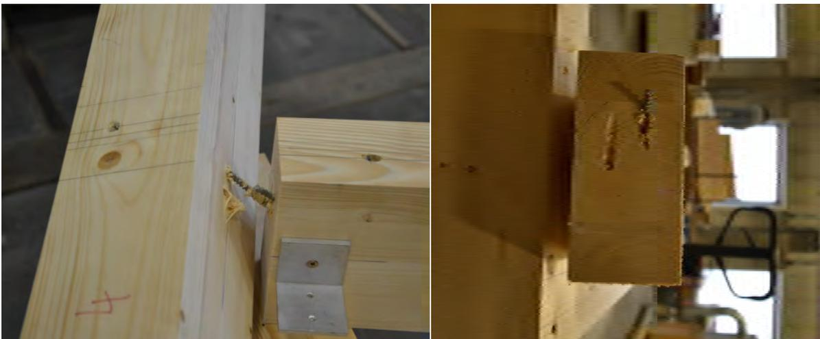
Abbildung 5-12: Versagensbild der Haupt-Nebenträgerverbindung mit gekreuzten Vollgewindeschrauben
