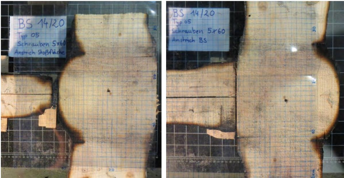
Abbildung 6-2: Horizontalschnitt durch den Prüfkörper, links: mit Anstrich in der Fuge, rechts: mit Anstrich des Balkenschuhs
