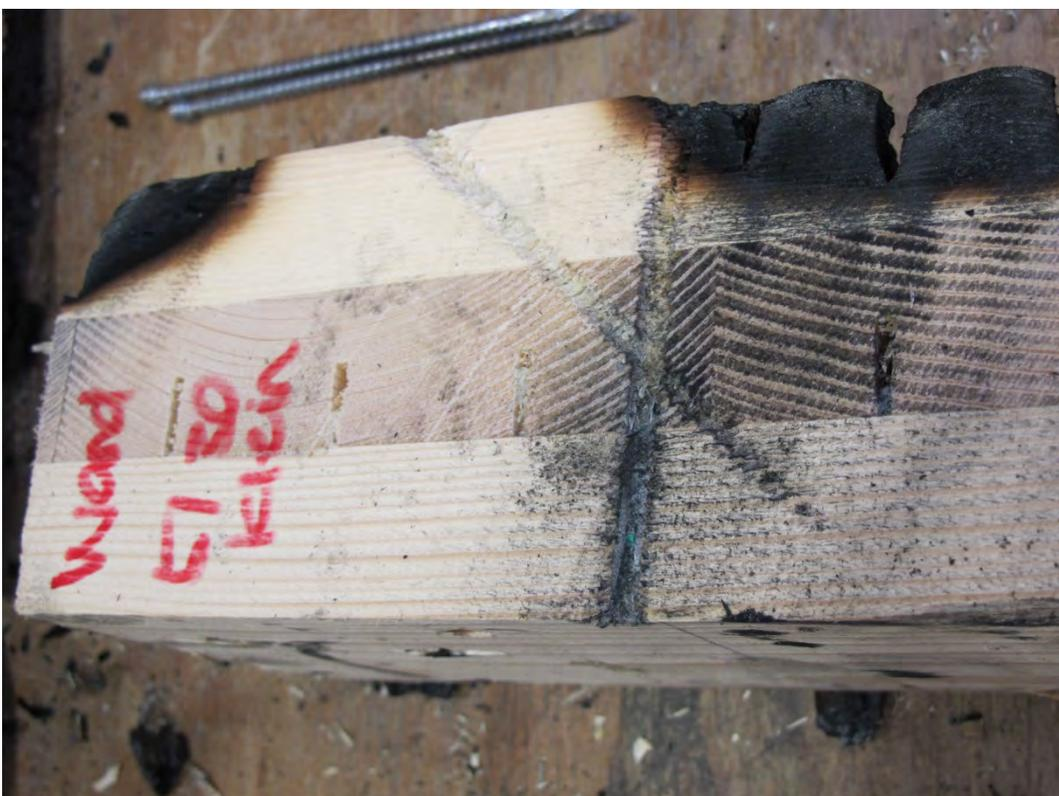
Abbildung 11-48: Schnitt durch den Hauptträger
