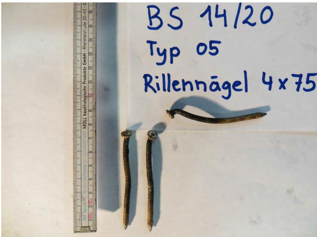
Abbildung 11-103: Versuchskörper B4, Verbindungsmittel nach der Versuchsdurchführung
