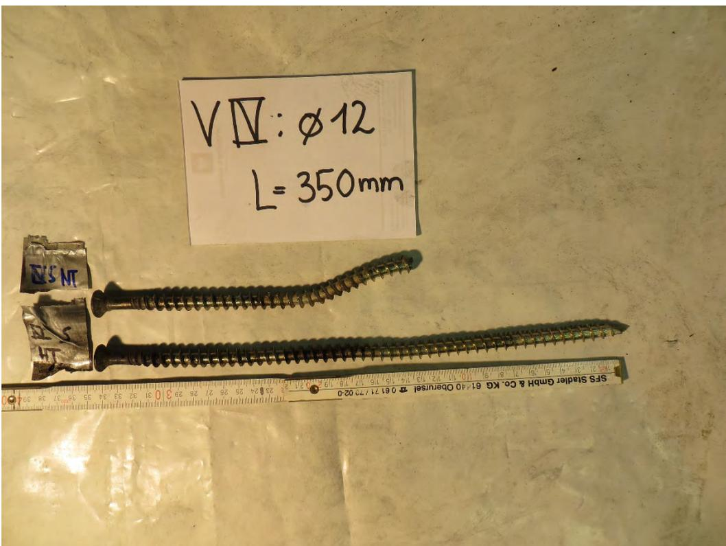
Abbildung 11-128: Versuchskörper S4, Verbindungsmittel nach der Versuchsdurchführung, die Schraube des Nebenträgers wurde abgerissen
