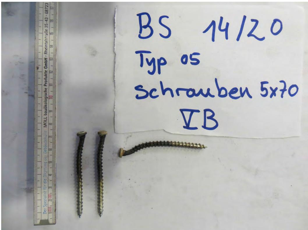
Abbildung 11-97 Verbindungsmittel nach der Versuchsdurchführung
