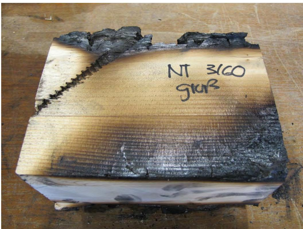
Abbildung 4-31: Verkohlung entlang der Schraube, die am Nebenträger eingeschraubt wurde (Prüfkörper 3, Ø12 mm bei einem Randabstand von 56 mm, 60 Minuten Brandbeanspruchung)
