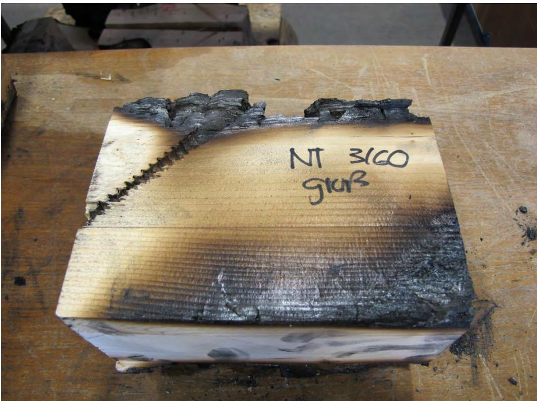
Abbildung 11-66: Schnitt durch den Nebenträger
