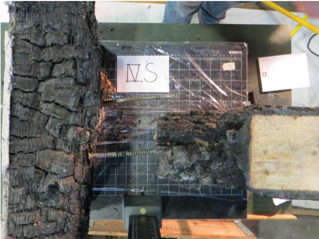
Abbildung 5-34: Ausgezogene Vollgewindeschrauben aus dem Haupt- und Nebenträger (S4)
