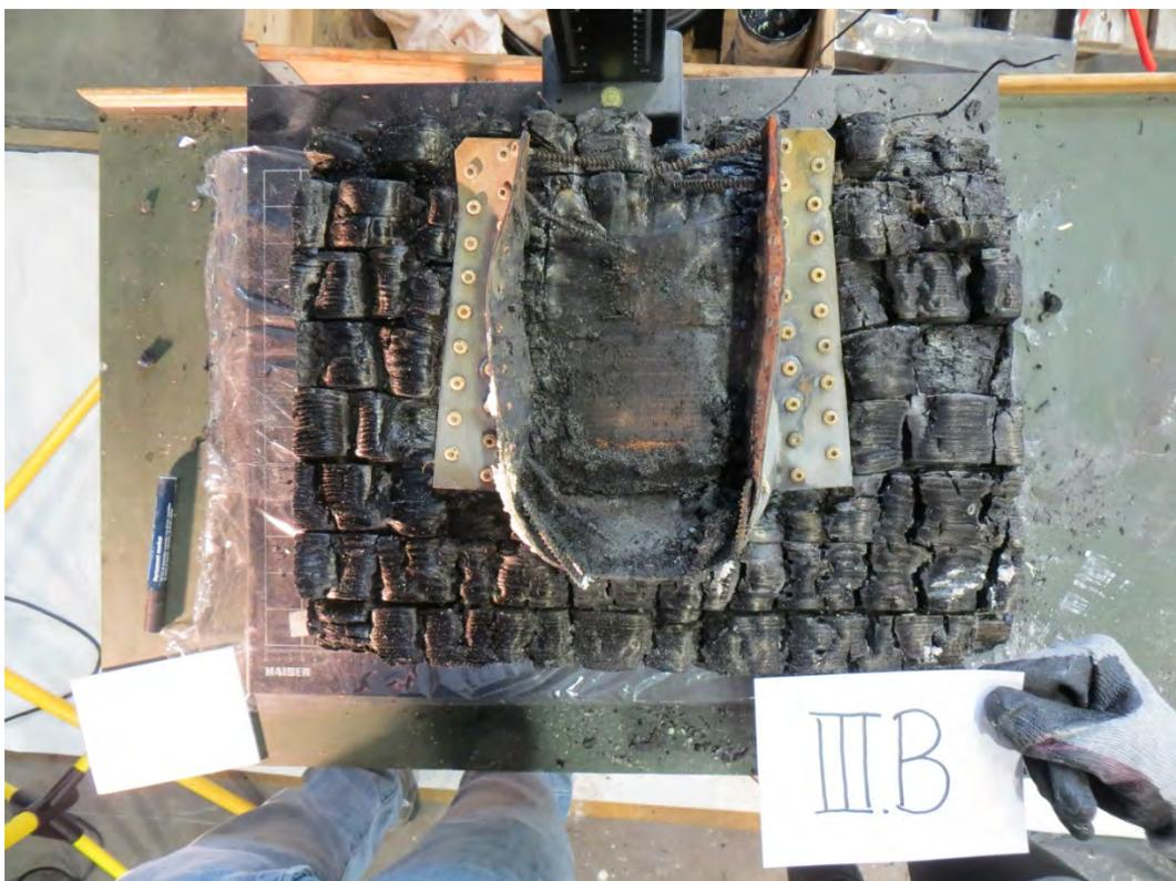
Abbildung 11-89: Versuchskörper B3, Balkenschuh nach der Versuchsdurchführung
