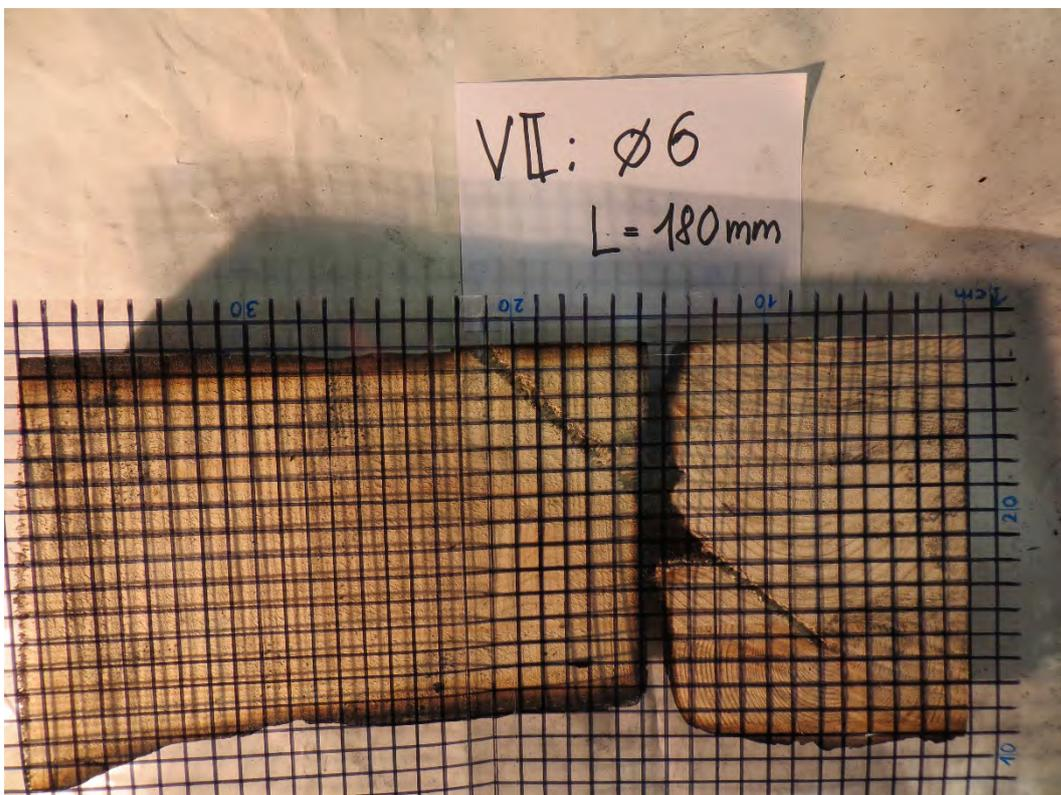
Abbildung 11-114: Versuchskörper S2, Vertikalschnitt durch Schraube des Nebenträgers
