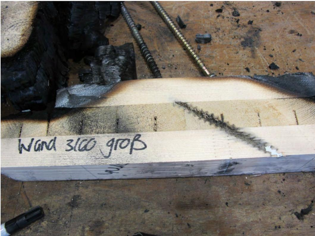
Abbildung 11-65: Schnitt durch den Hauptträger
