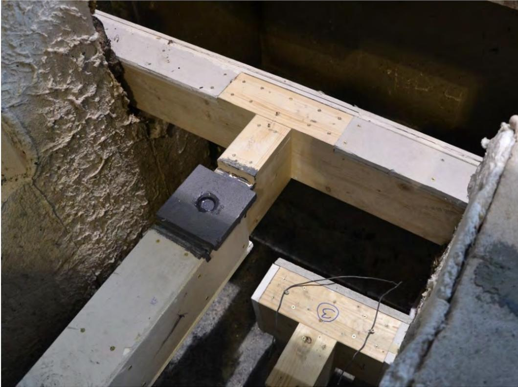
Abbildung 5-17: In Ofen eingebauter Prüfkörper mit Lasteinleitungsplatte. Die Ofendecke, der Druckstempel zur Lasteinleitung und die Einrichtung zur Wegmessung sind noch nicht montiert.
