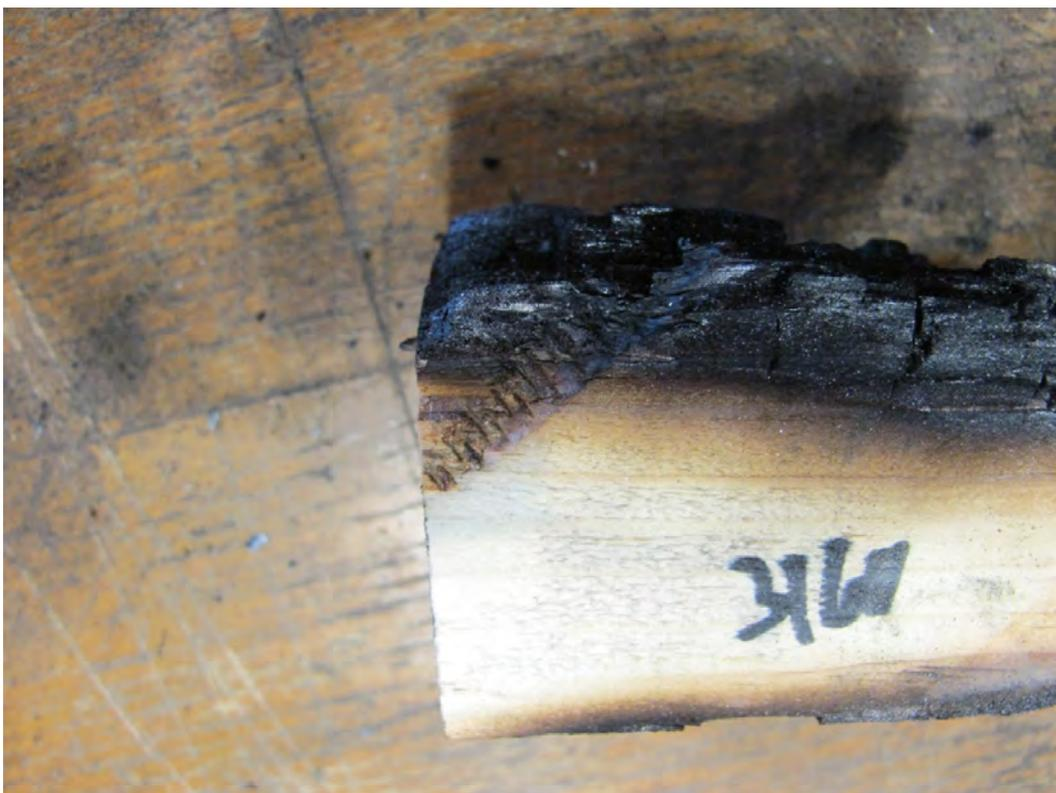
Abbildung 11-59: Schnitt durch den Nebenträger
