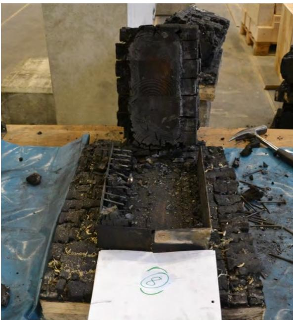
Abbildung 4-21: Prüfkörper 8, Ansicht nach Demontage des NT
