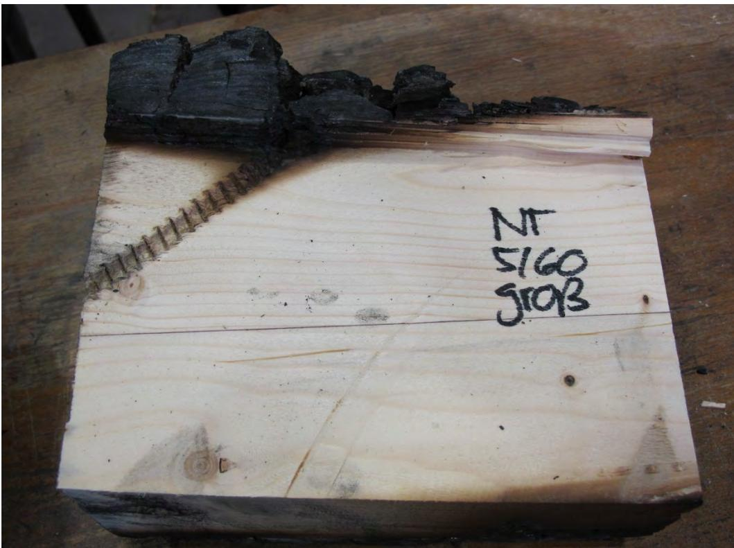
Abbildung 11-70: Schnitt durch den Nebenträger
