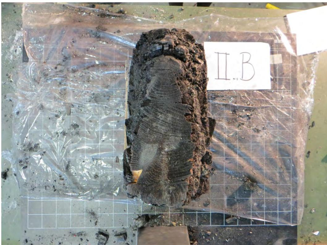
Abbildung 11-84: Versuchskörper B2, Stirnfläche des Nebenträgers
