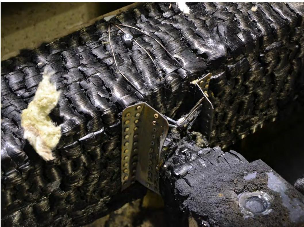
Abbildung 11-79: Versuchskörper B2 nach der Versuchsdurchführung
