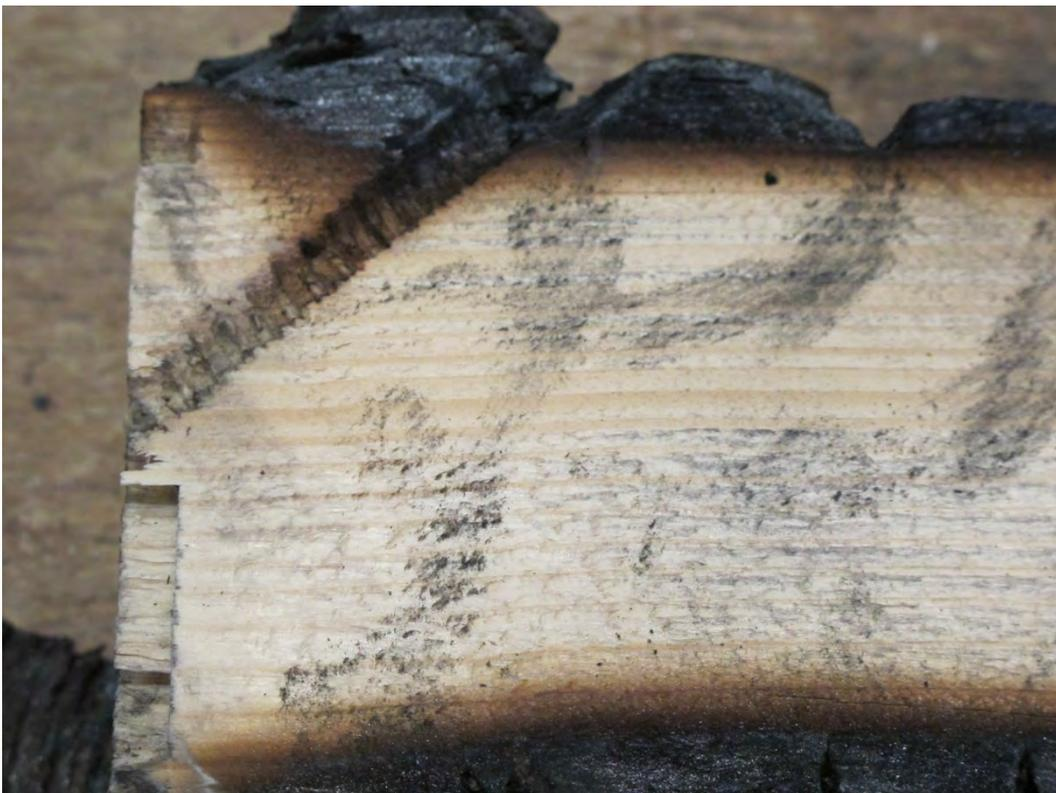
Abbildung 11-49: Schnitt durch den Nebenträger
