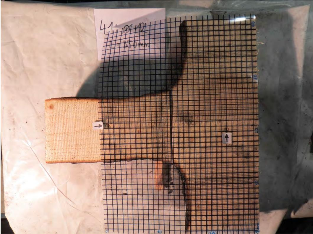
Abbildung 11-125: Versuchskörper S4, unbelastet; Horizontalschnitt
