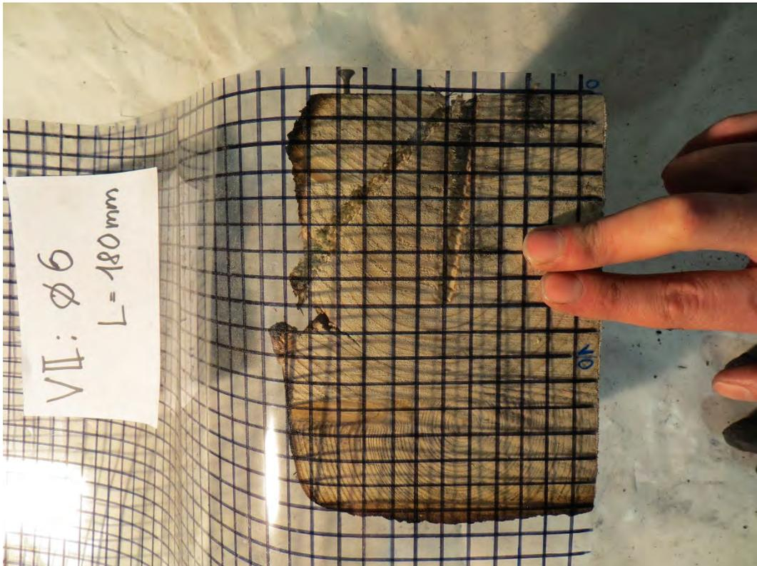
Abbildung 11-113: Versuchskörper S2, Vertikalschnitt durch Schraube des Hauptträgers
