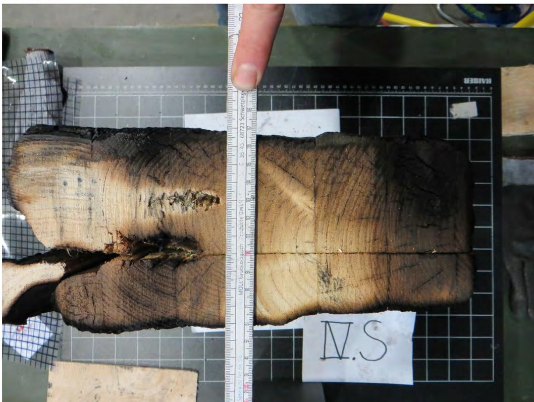
Abbildung 11-129: Versuchskörper S4, Randüberdeckung der Schrauben
