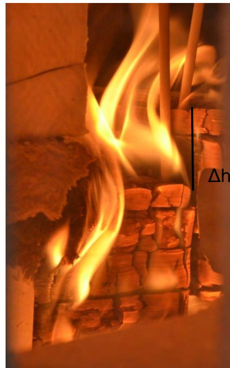
Abbildung 5-27: Versuchskörper unmittelbar nach Erreichen der Maximallast. (Versuchskörper S3). Gut erkennbar ist die Relativverschiebung des Nebenträgers mit einhergehendem Spalt zwischen Haupt- und Nebenträger
