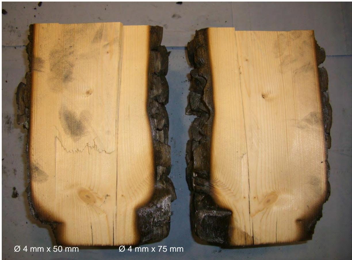
Abbildung 4-15: Horizontaler Schnitt durch den Nebenträger des Prüfkörpers 2
