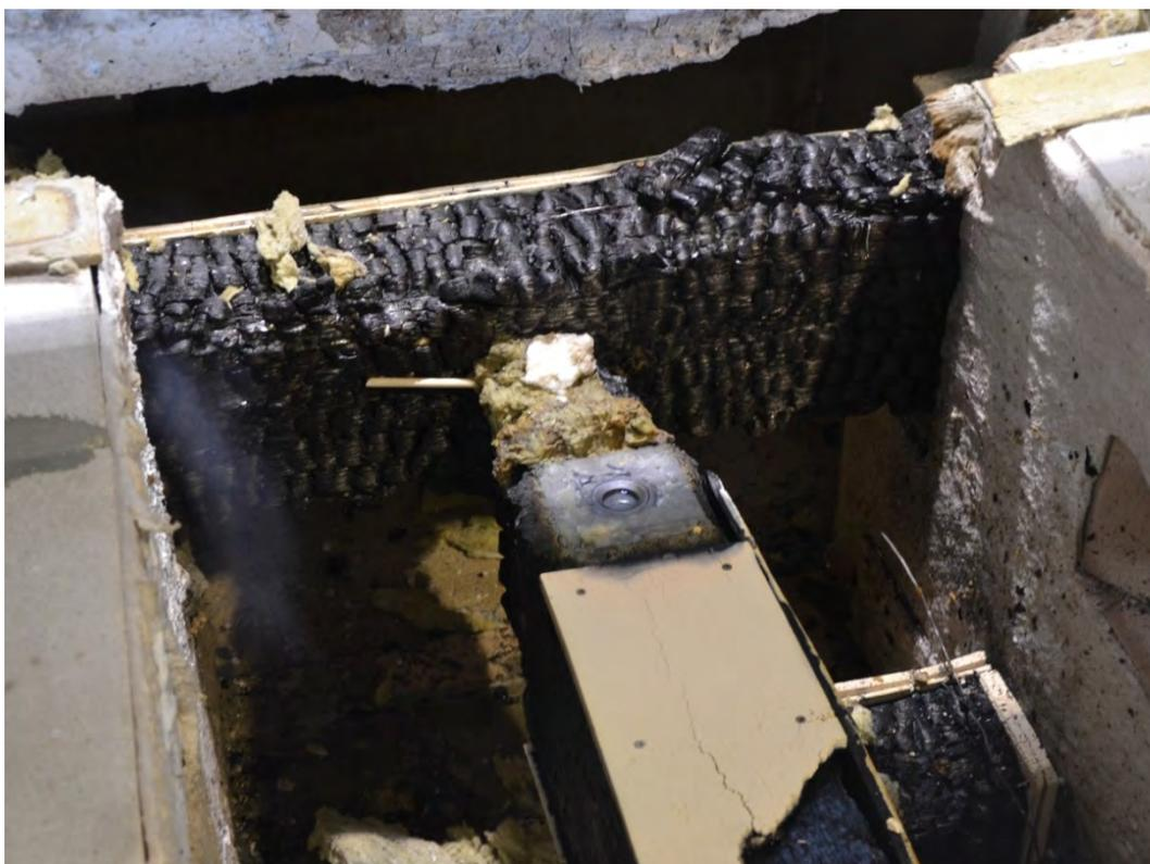
Abbildung 5-28: Versuchskörper unmittelbar nach dem Versuchsende und dem Ablöschen sowie Entfernen der Ofendecke und Belastungseinrichtung. (Versuchskörper S4)
