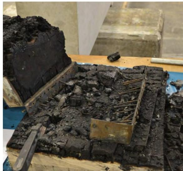
Abbildung 4-14: Versuchskörper 2 nach Entfernen des Nebenträgers
