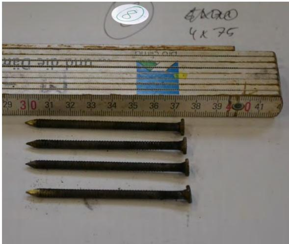
Abbildung 4-22: Prüfkörper 8, Nägel 4 x 75 mm aus dem NT, deutlich erkennbar ist die dunkle Verfärbung auf der gesamten Länge
