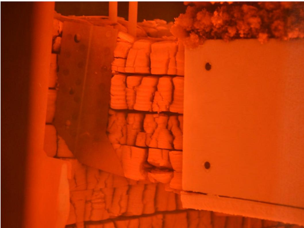
Abbildung 11-71: Versuchskörper B1 im Ofen
