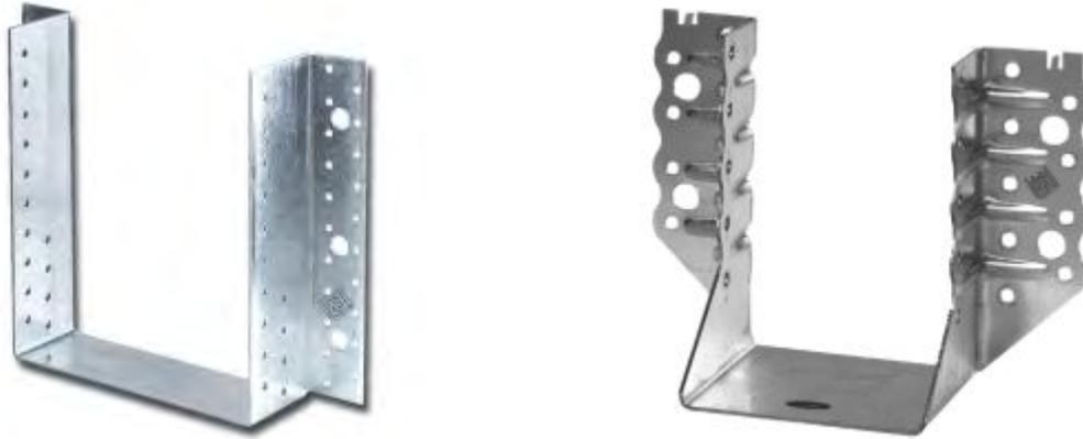
Abbildung 2-1: Beispiele für praxisübliche Balkenschuhtypen. Rechts eine Variante für große Holzquerschnitte, links ein kleinerer Verbinder mit zusätzlichen Sicken zur Verbesserung des Tragverhaltens bei zweiachsiger Beanspruchung. (Quelle: GH Baubeschläge)
