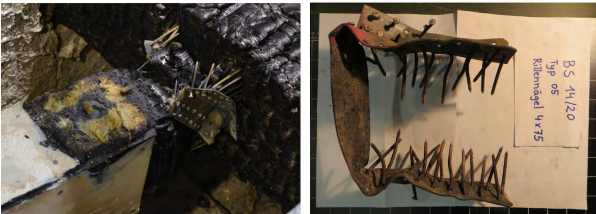
Abbildung 5-24: links: Versuchskörper unmittelbar nach dem Versuchsende und dem Ablöschen sowie Entfernen der Ofendecke und Belastungseinrichtung. rechts: Nach dem Brandversuch abgelöster Balkenschuh. Gut erkennbar ist die starke Verformung des Bleches und der Verbindungsmittel. (Versuchskörper B4).
