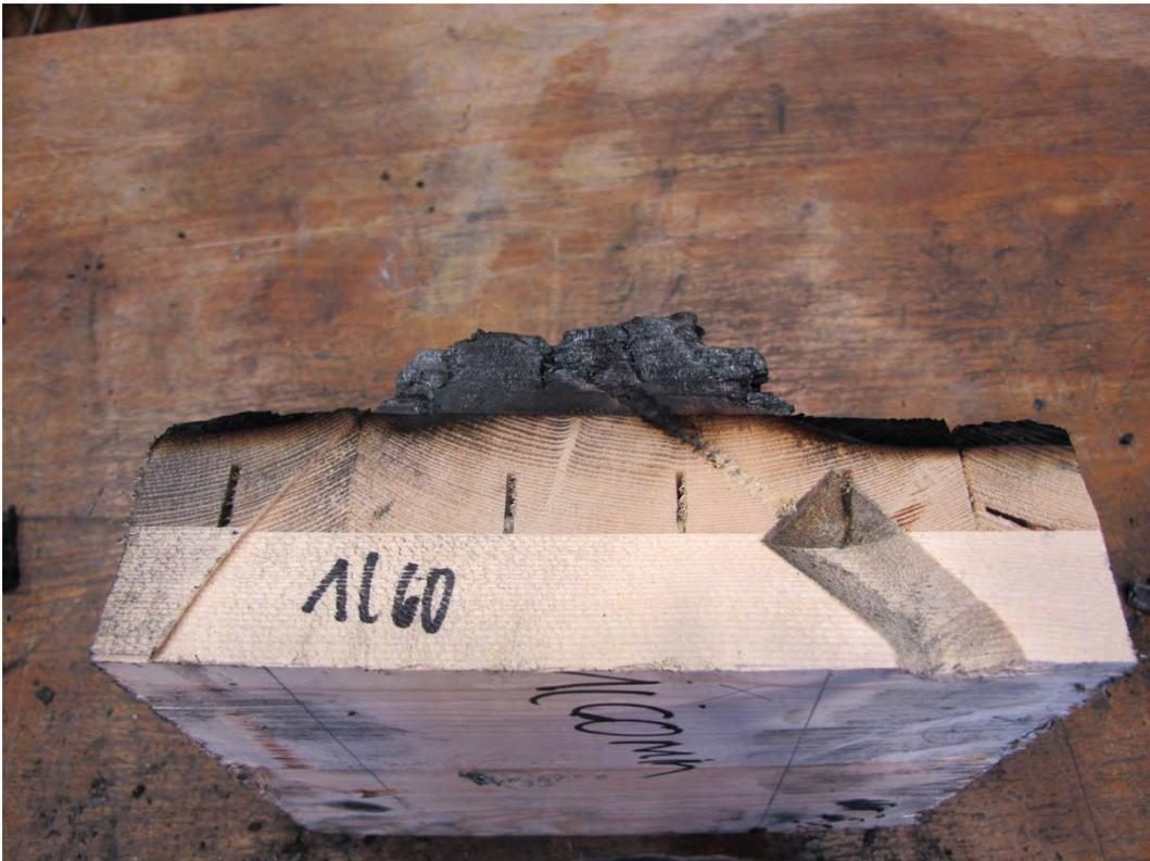
Abbildung 11-55: Schnitt durch den Hauptträger
