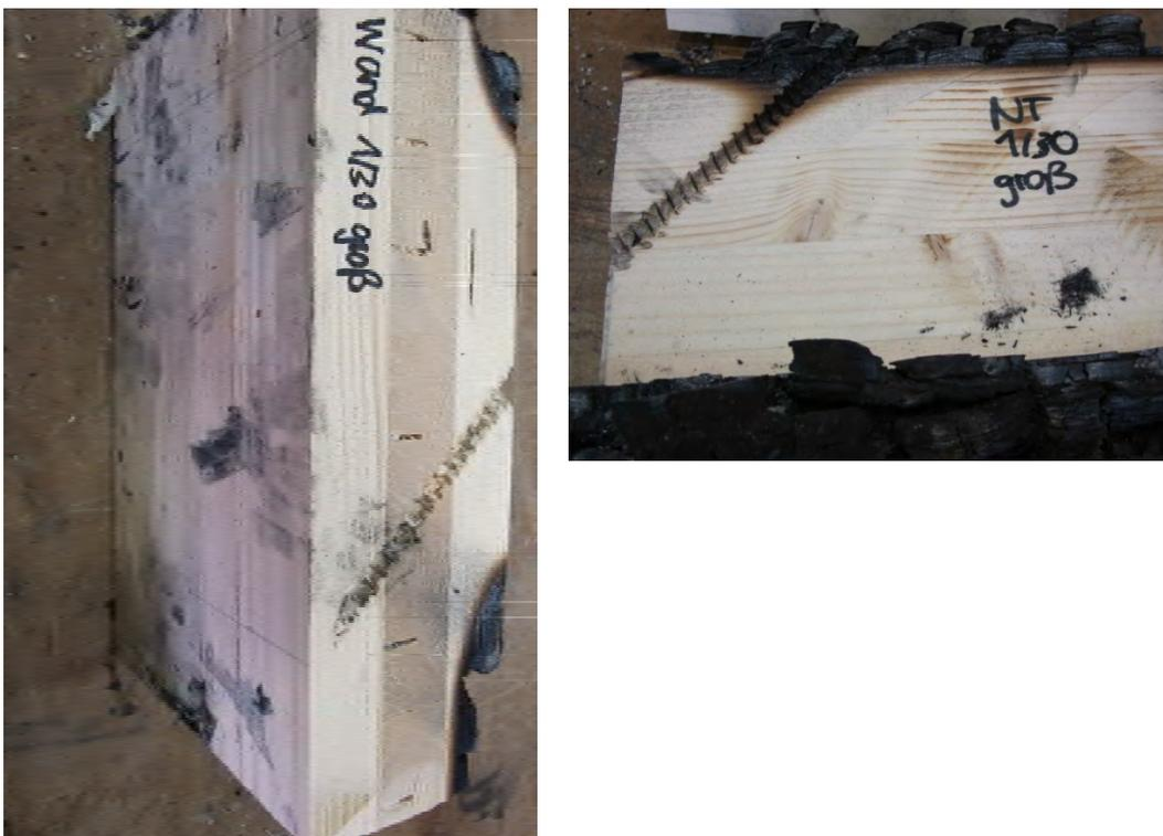
Abbildung 4-30: Verkohlung entlang der Schraube, die am Nebenträger eingeschraubt wurde (Prüfkörper 1, Ø12 mm bei einem Randabstand von 36 mm, 30 Minuten Brandbeanspruchung)
