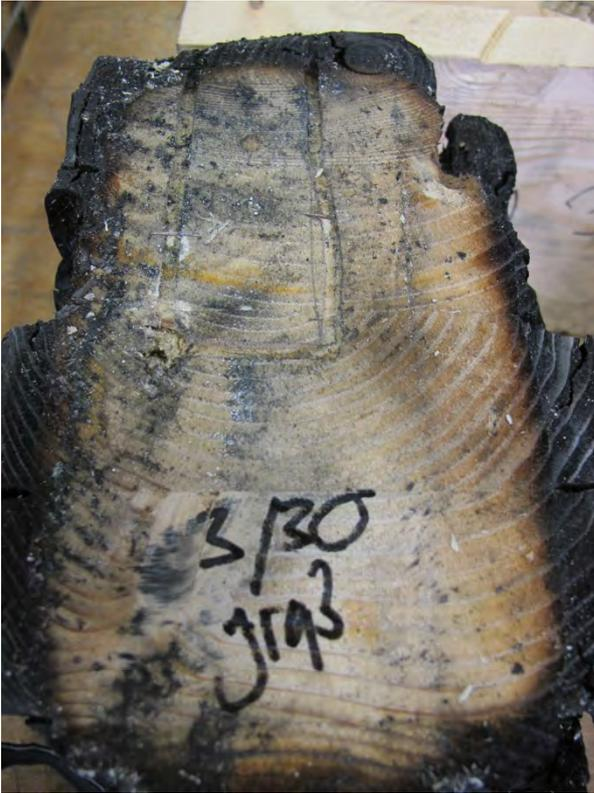
Abbildung 11-53: Hirnholzende des Nebenträgers im Anschlussbereich zum Hauptträger
