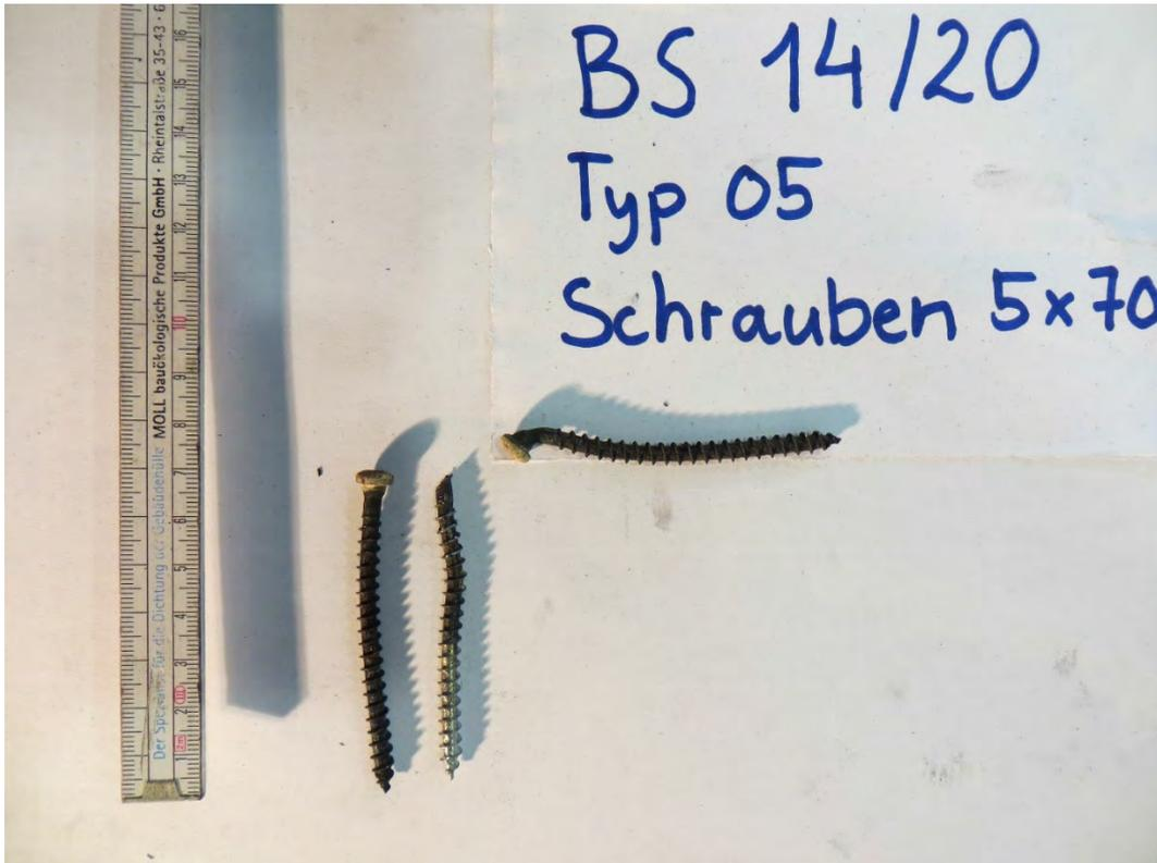
Abbildung 11-90: Versuchskörper B3, Verbindungsmittel nach der Versuchsdurchführung
