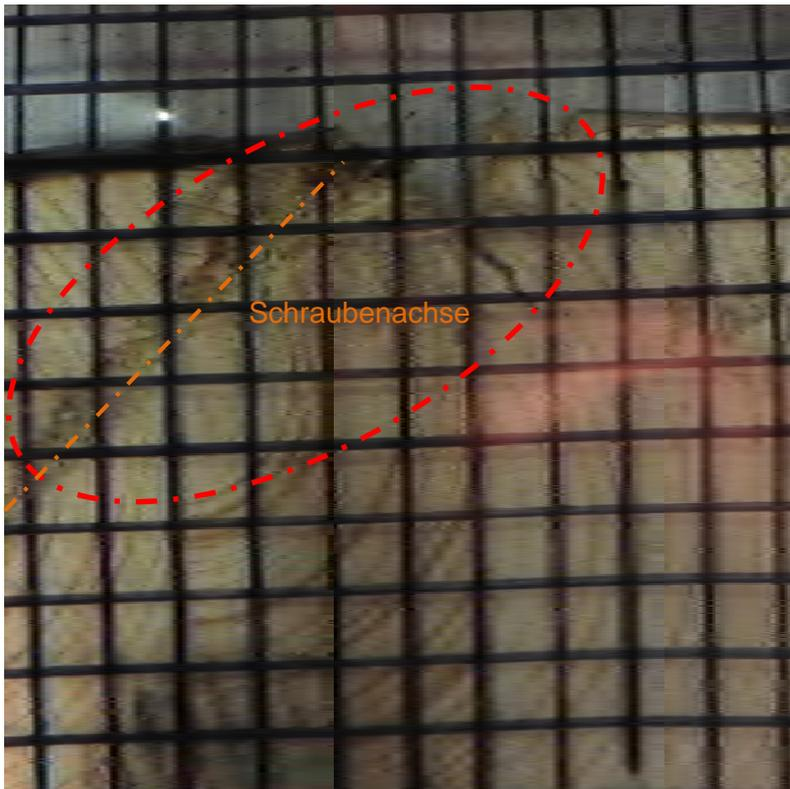
Abbildung 5-30: Schnitt durch die Längsachse der Schraube, die im Hauptträger eingeschraubt wurde. Versuchs-körper S3. Hierbei wird ersichtlich, dass die Schraube durch das Holz gezogen wurde
