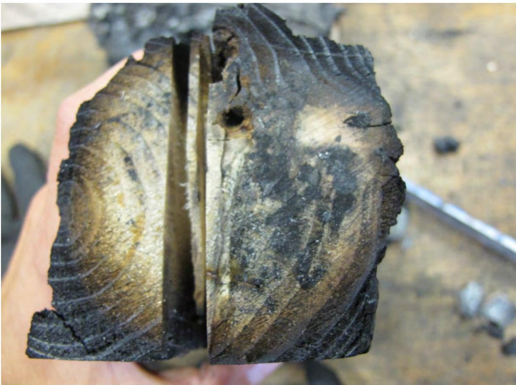
Abbildung 11-62: Anschlussende des Nebenträgers an den Hauptträger
