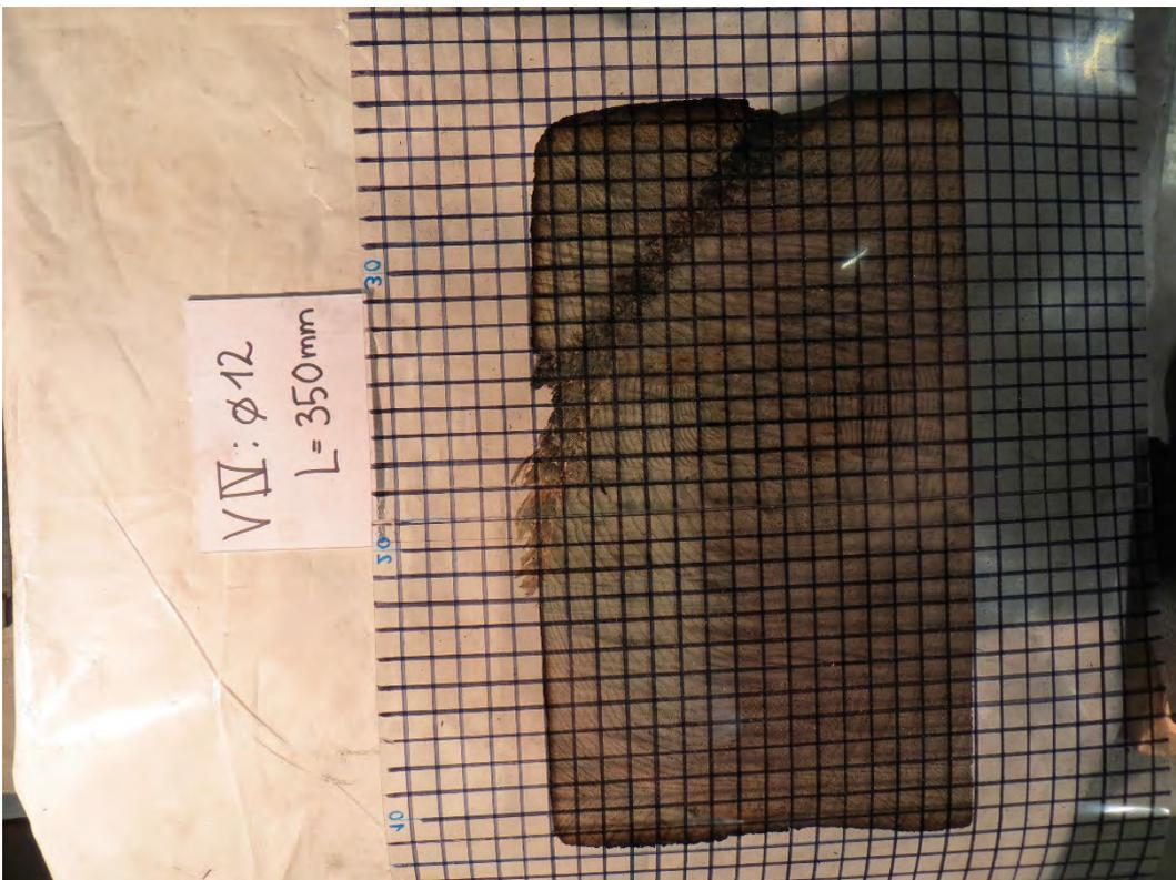
Abbildung 11-126: Versuchskörper S4, Vertikalschnitt durch Schraube des Hauptträgers
