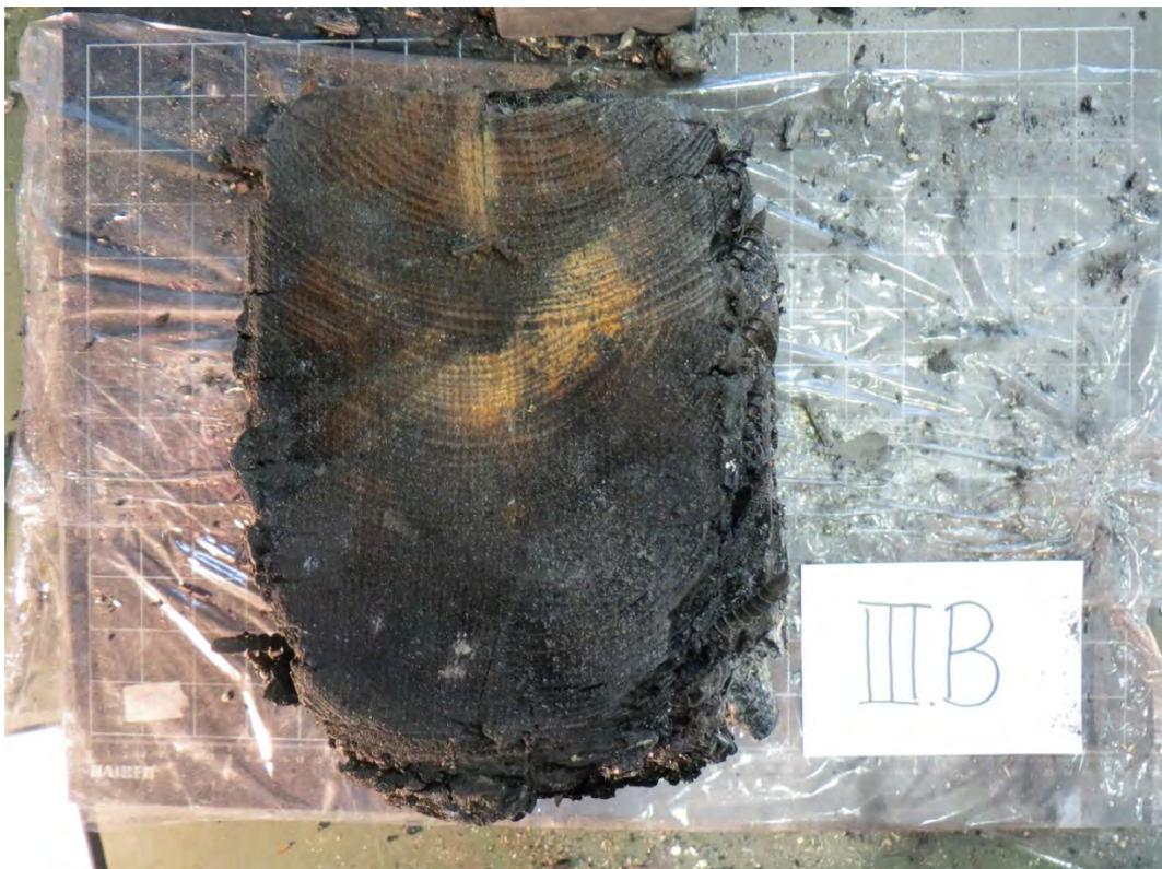
Abbildung 11-91: Versuchskörper B3, Stirnfläche des Nebenträgers
