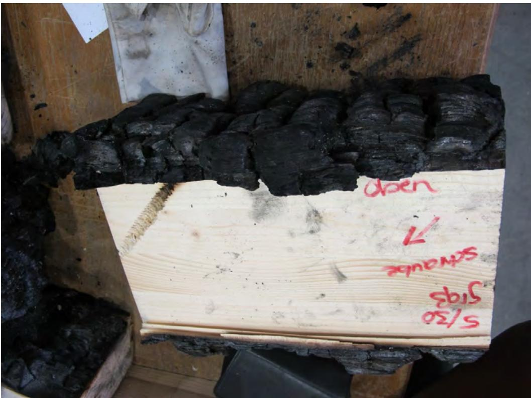
Abbildung 11-54: Schnitt durch den Nebenträger
