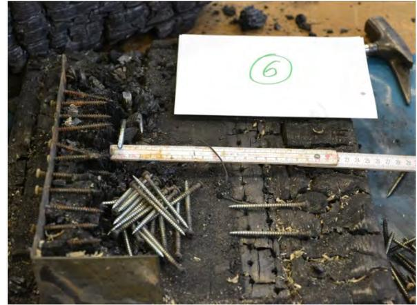
Abbildung 4-20: Prüfkörper 6, Balkenschuh nach Demontage des Nebenträgers, gut erkennbar sind die teilweise noch blanken Schraubenspitzen 5 x 70 mm.
