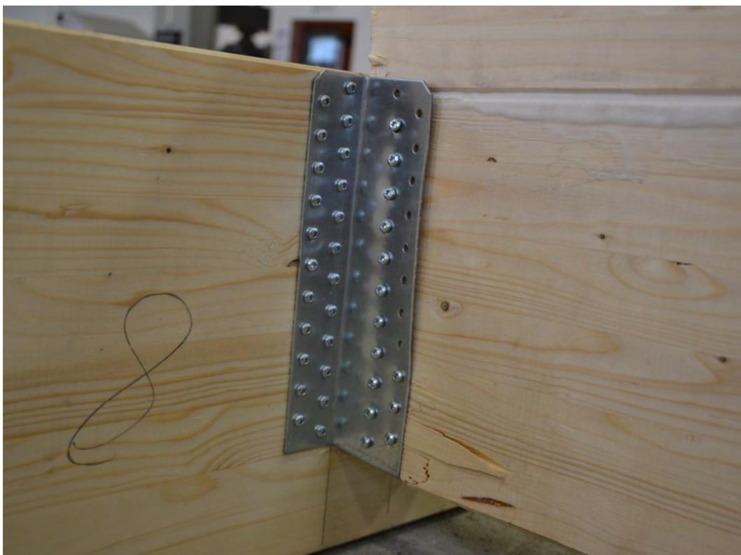
Abbildung 5-9: Bruchbild des Versuchskörpers B2-4 nach 15 mm Relativverschiebung
