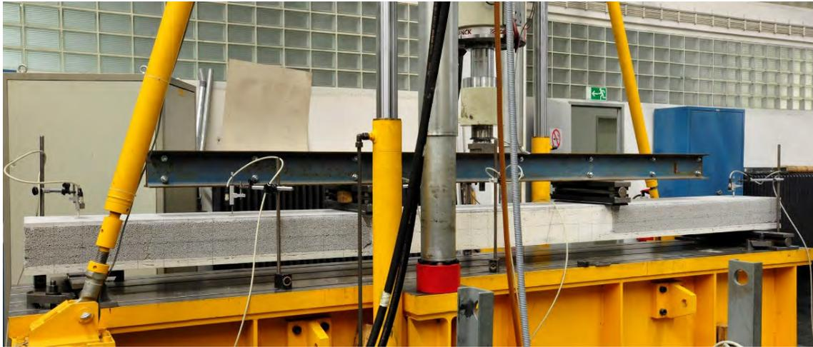
Abb. 5-11: Prüfaufbau der Hauptausführung auf dem Nutentisch der MPA Stuttgart
