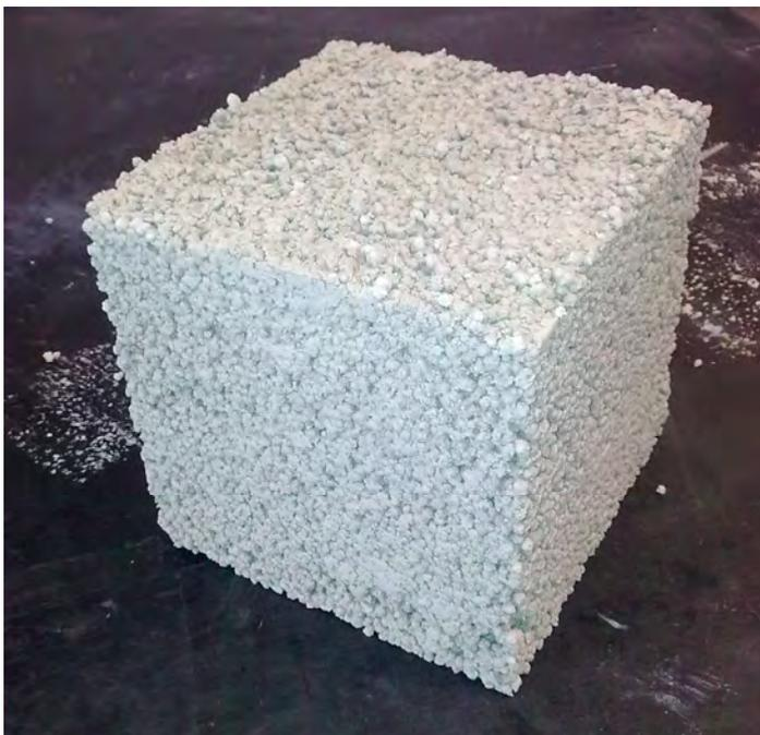
Abb. 3-4: Frischbetonwürfel KLM mit ausreichender Grünstandfestigkeit (Kantenlänge 150 mm)
