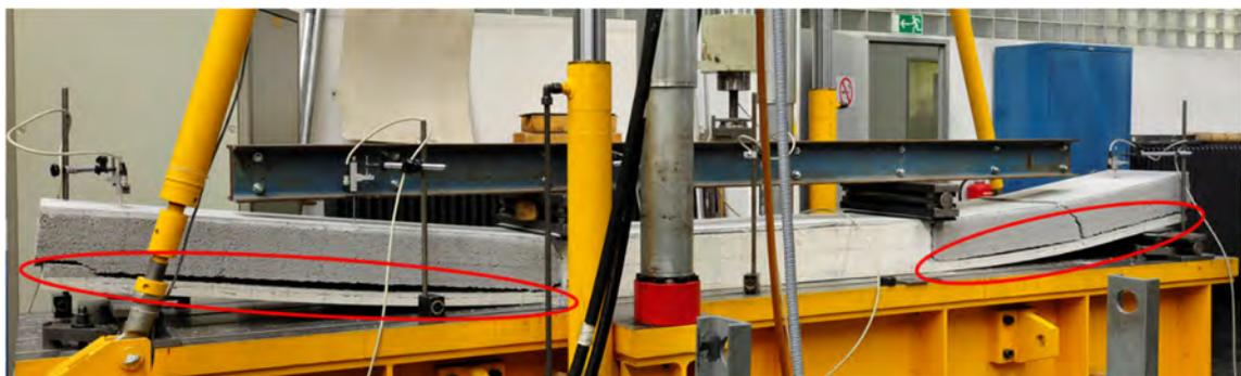
Abb. F-3: Versagen des Prüfkörpers V0.1 in der Längsfuge auf dem Prüftisch der MPA Stuttgart
