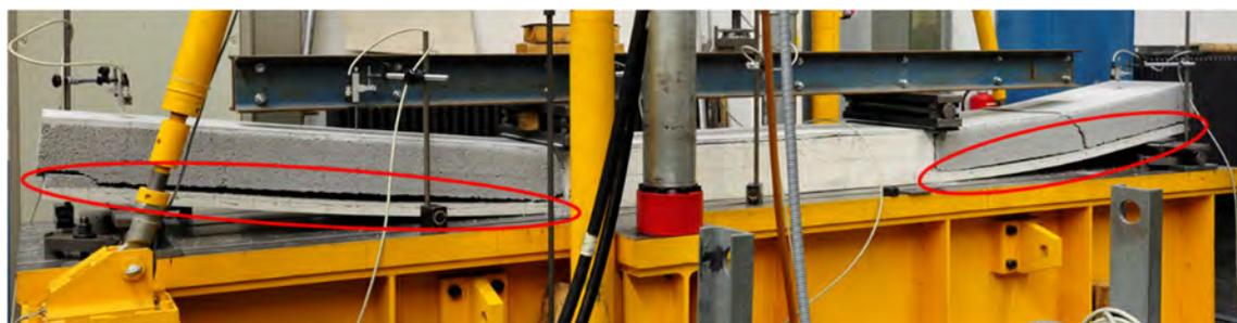
Abb. 5-18: Versagen des Bauteils 0.1 in der unteren Längsfuge
