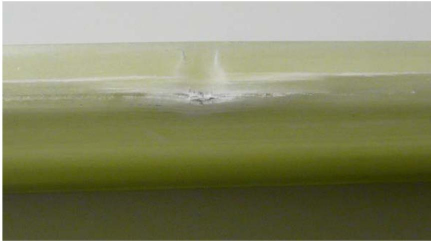
*Abbildung 75: Durch Auflager im Biegeversuch beschädigte Probenoberfläche*
