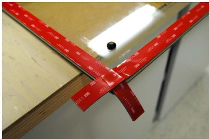
*Abbildung 37: 3M VHB-Klebeband auf VIG montiert*
