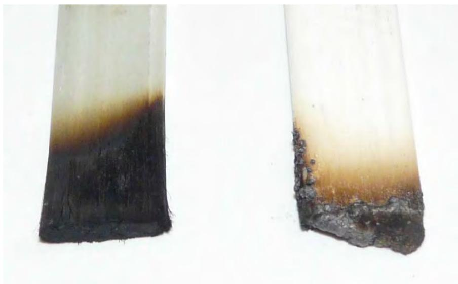
Abbildung 52: Gegenüberstellung des Ergebnisses von Brandprüfungen ohne und mit Brandschutzmatrix
