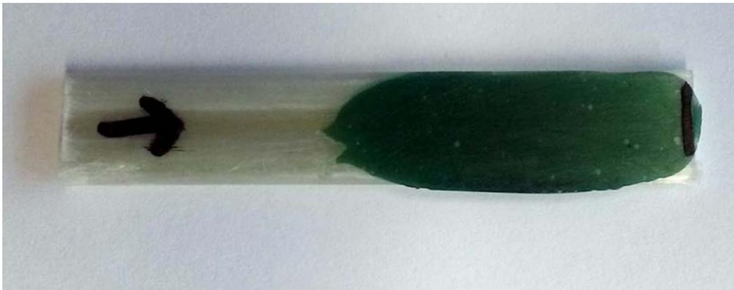
Abbildung 37: Klebung mit nur einseitiger Oberflächenvorbereitung
