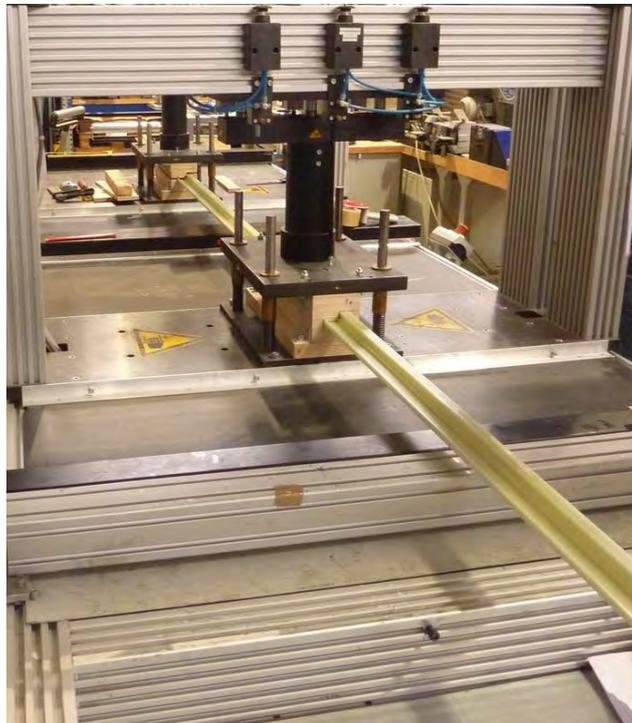
*Abbildung 57: Fensterprofilrahmen in der Abzugsvorrichtung*
