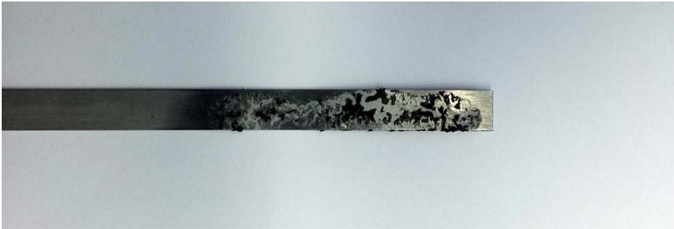
*Abbildung 39: Kohäsives Versagen der Klebung*
