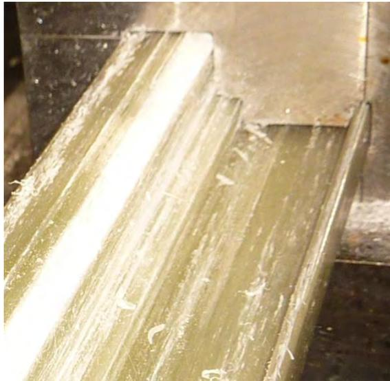
*Abbildung 61: Ablagerungen auf der Profiloberfläche.*
