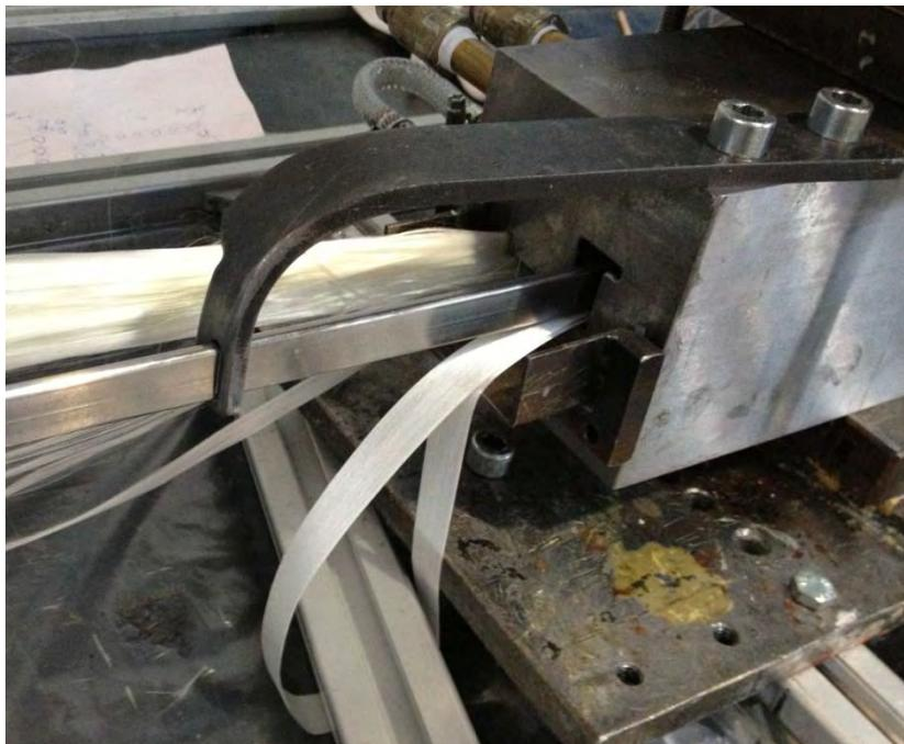
*Abbildung 55: Einschleusen des Fasermaterial mit Zugbändern, Kernhalterung mit Kern*
