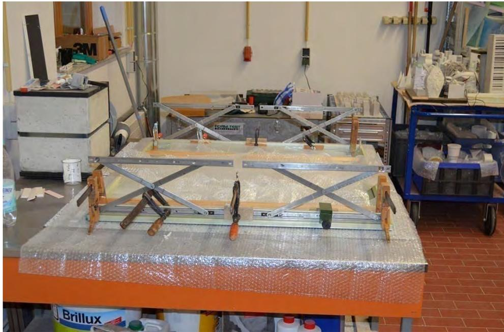
*Abbildung 81: Kleben der Scharniere an den Rahmen, Aushärtung*
