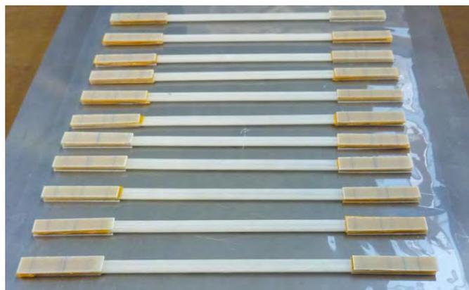
*Abbildung 50: Zugstäbe mit Aufleimern für die Zugprüfungen*
