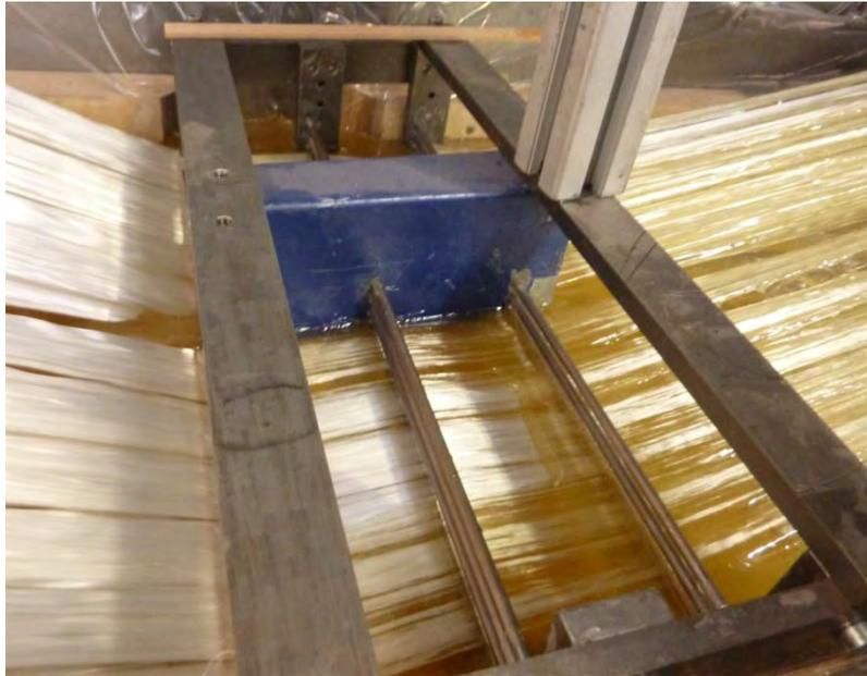
*Abbildung 56: Führung im Harzbad mit Umlenkung der Glasfasern*
