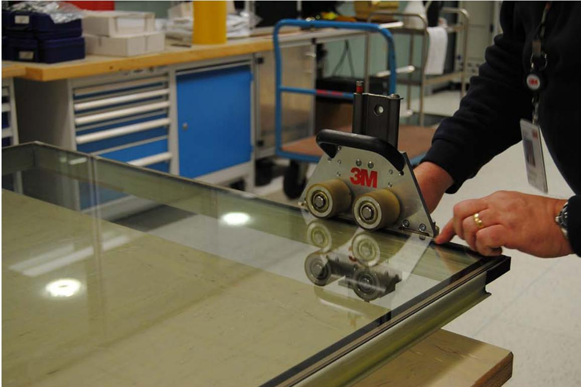
*Abbildung 80: Verkleben und Anpressen von Scheibe und Rahmen mit VHB-Klebeband*
