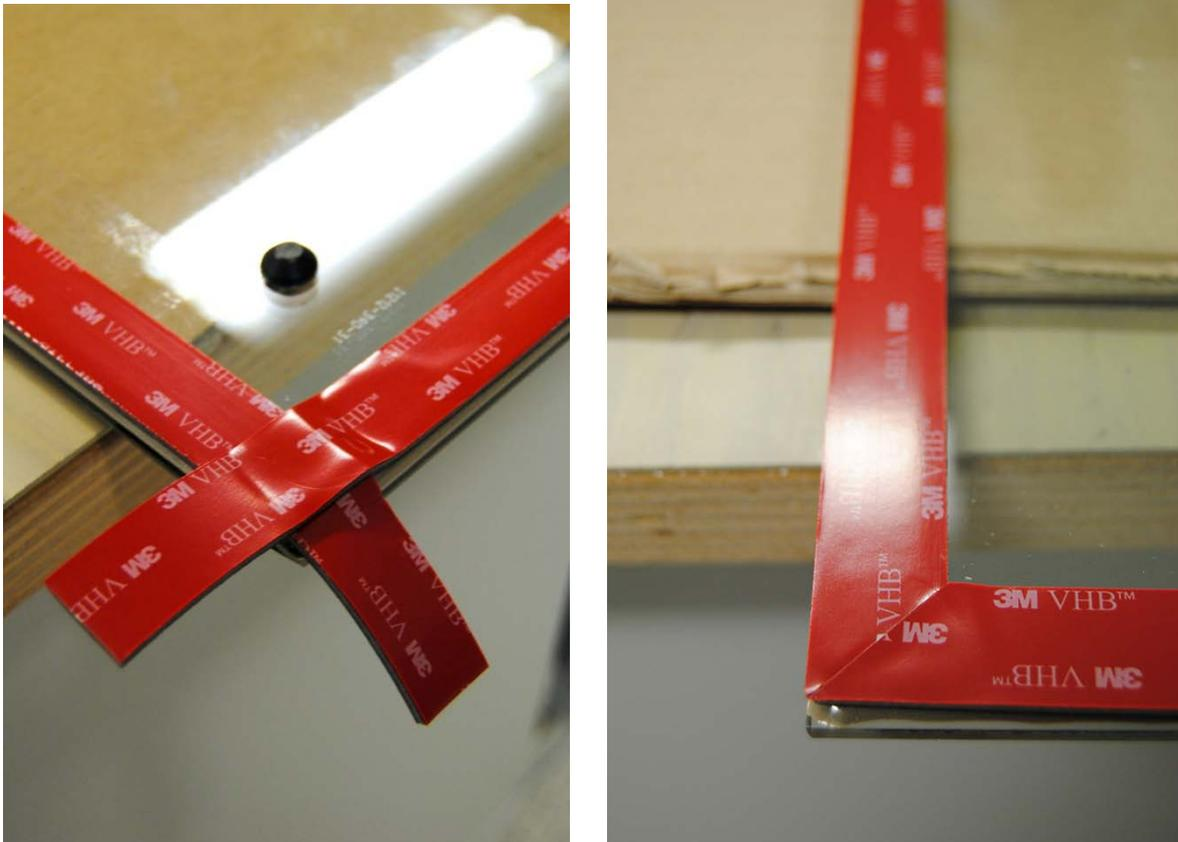
Abbildung 79: Scheibe mit VHB-Tape vor und nach Zuschnitt
