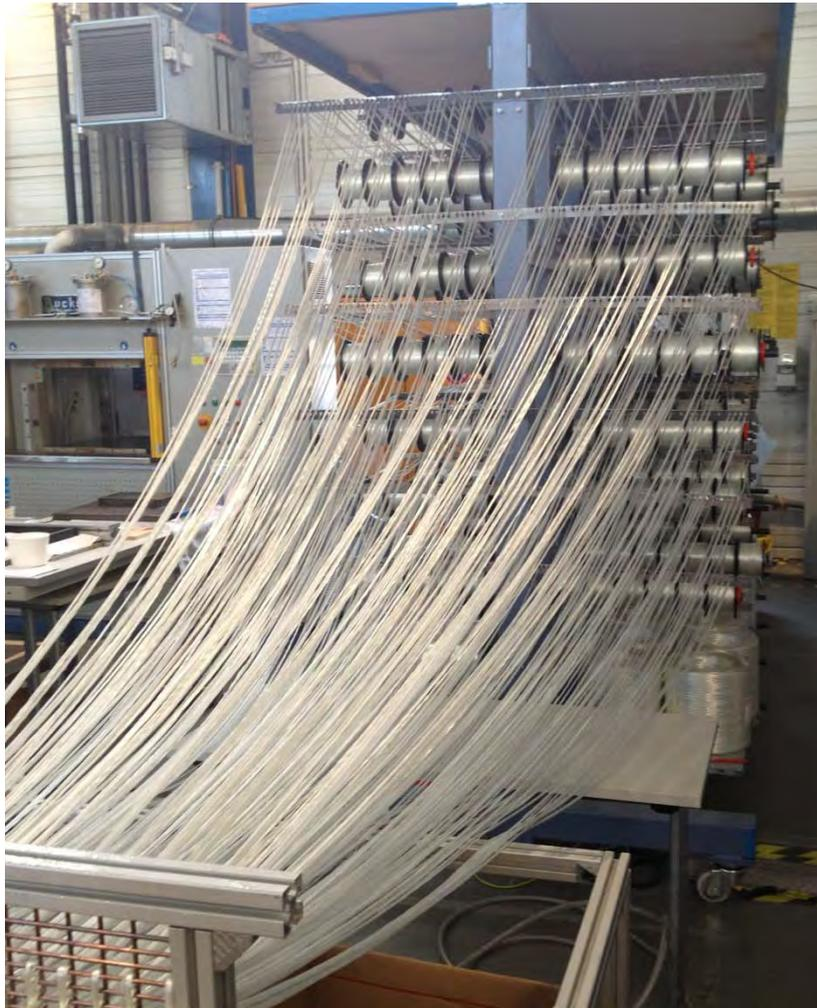
*Abbildung 54: Spulengatter mit insgesamt 296 verwendeten Rovingspulen*
