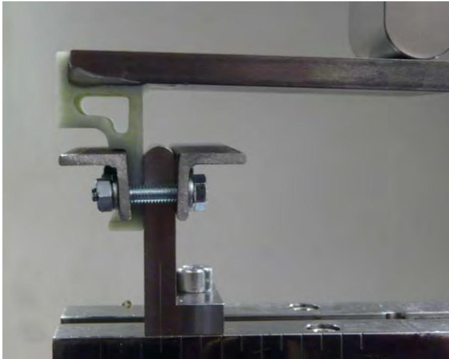
Abbildung 72: Einbausituation für Probeelemente zur Aufbringung simulierter Momente (Winddruck)
