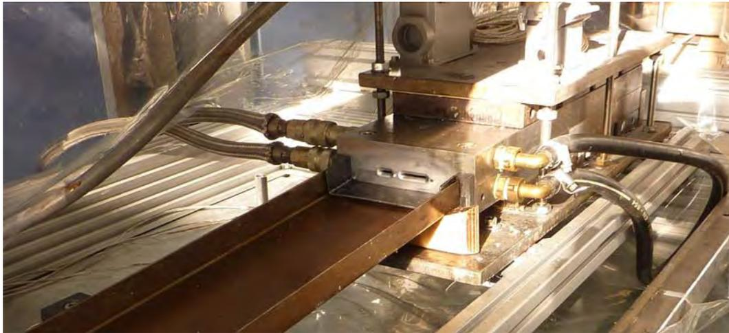
*Abbildung 46: Übersicht Pultrusionseinheit zur Fertigung von Zugstäben*
