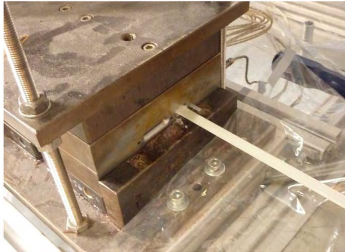
*Abbildung 48: Fertiger Zugstab 10\*2mm*
