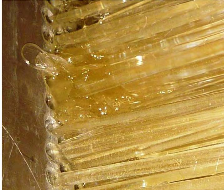
*Abbildung 59: Verengung der Führungsbohrungen durch Filamentablagerungen*
