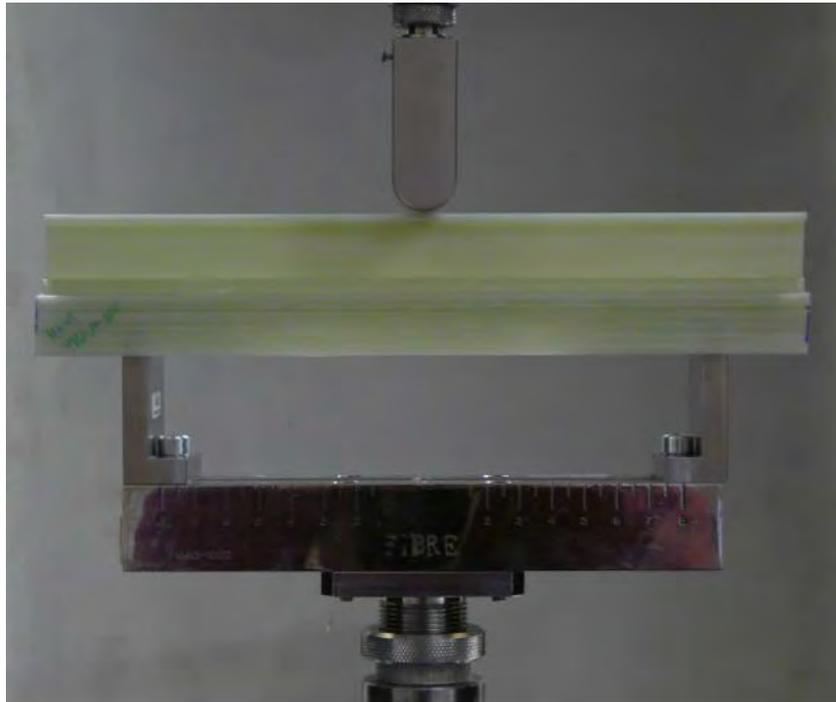
*Abbildung 74: Aufbau zur Prüfung der Durchbiegung der Fensterrahmen*
