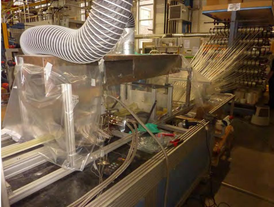
Abbildung 58: Versuchsaufbau mit Schutzfolien und Absaugvorrichtung
