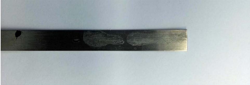
*Abbildung 38: Adhäsives Versagen der Klebung*
